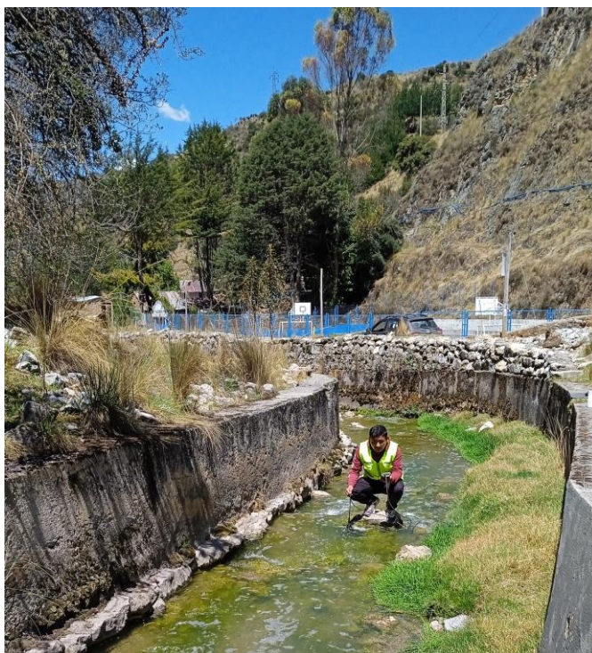
Figura 9. Toma de muestra P1 aguas abajo con el multiparámetro Hanna
