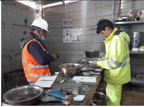
Imagen N°19: Ensayo de abrasión de los materiales pétreos para pedraplén en el laboratorio de la empresa CRBC.
