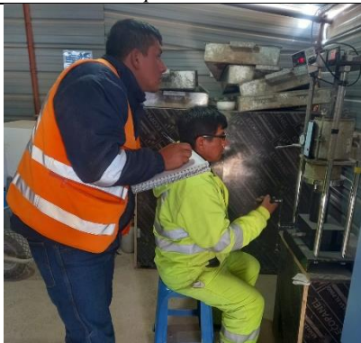
Imagen N°19: Ensayo de abrasión de los materiales pétreos para pedraplén en el laboratorio de la empresa CRBC.
