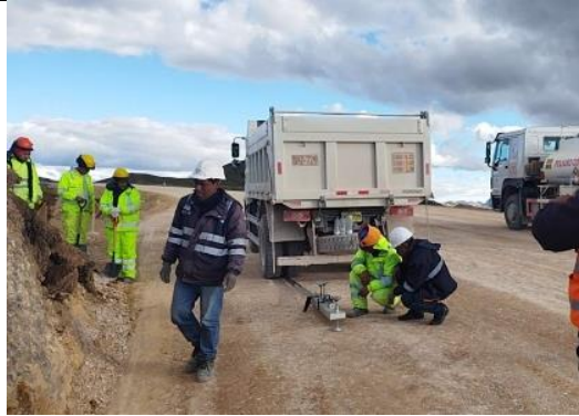
Imagen N°07: Control de humedad de material base trabajado en sector de pedraplén km 83+470 al km 83+590
