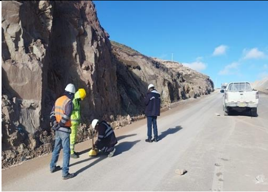
Imagen N°09: Medición de la deflexión con la Viga Benkelman de la sub rasante sobre un sector de pedraplén km 86+380 al km 86+930.
