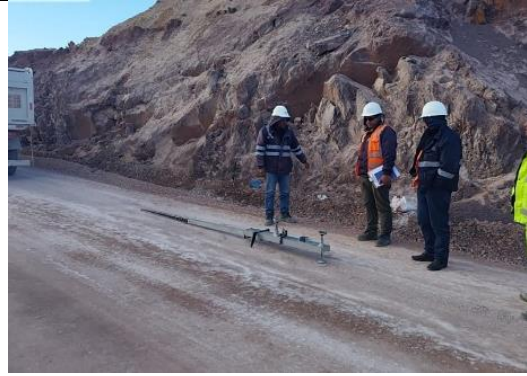
Imagen N°08: Medición de la deflexión con la Viga Benkelman de la sub rasante sobre un sector de pedraplén km 86+150 al km 86+220.
