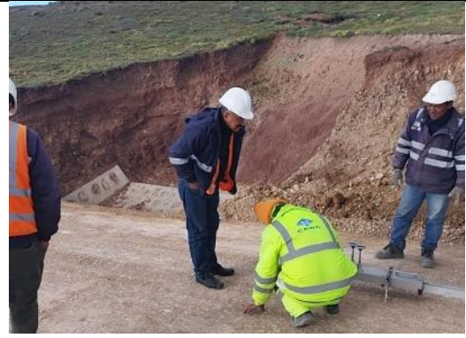
Imagen N°08: Medición de la deflexión con la Viga Benkelman de la sub rasante sobre un sector de pedraplén km 86+150 al km 86+220.
