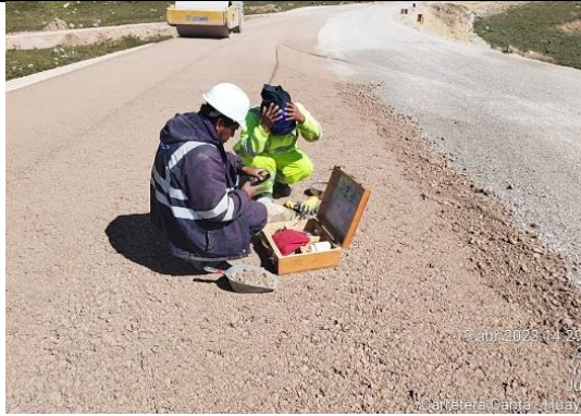
Imagen N°07: Control de humedad de material base trabajado en sector de pedraplén km 83+470 al km 83+590
