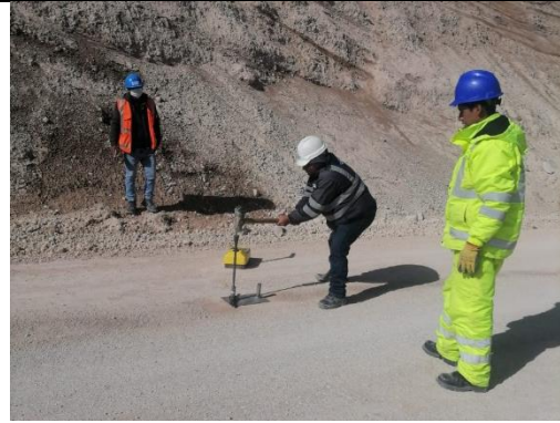
Imagen N°14: Determinación de la densidad de la subrasante en sector de pedraplén km 87+120 al km 87+630 (Utilización del densímetro nuclear).
