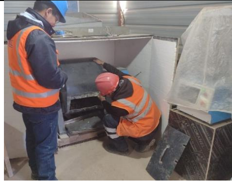
Imagen N°20: Ensayo de abrasión de los materiales pétreos para pedraplén en el laboratorio de la empresa CRBC.
