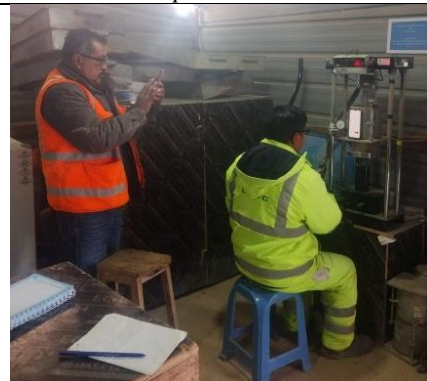
Imagen N°20: Ensayo de abrasión de los materiales pétreos para pedraplén en el laboratorio de la empresa CRBC.
