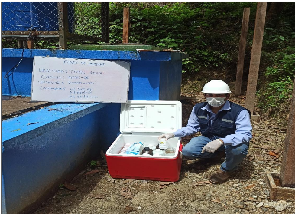
Foto N° 12.- Muestras de agua del reservorio del sistema de abastecimiento de agua del anexo de Tambo Pituca; listos para la evaluación y análisis en laboratorio.
