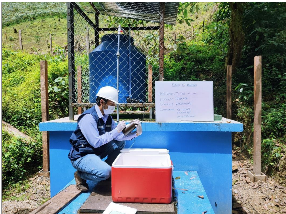
Foto N° 10.- Registro de datos de campo, antes de la toma de muestras de agua del reservorio del sistema de abastecimiento de agua del anexo de Tambo Pituca.
