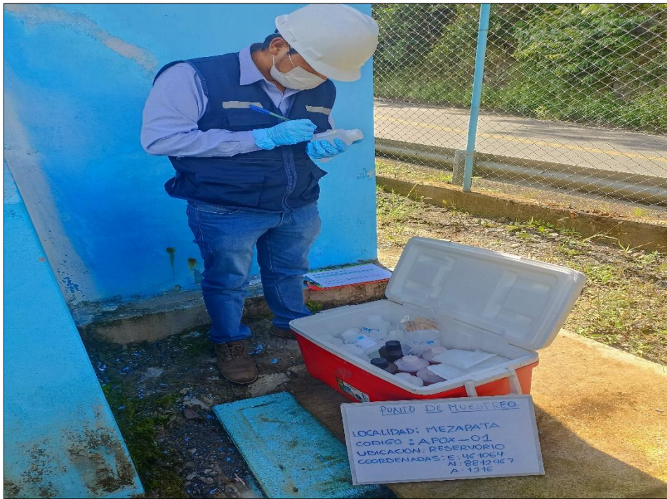
Foto N° 7.- Rotulado de muestras de agua del reservorio del sistema de abastecimiento de agua del anexo de Mesapata.
