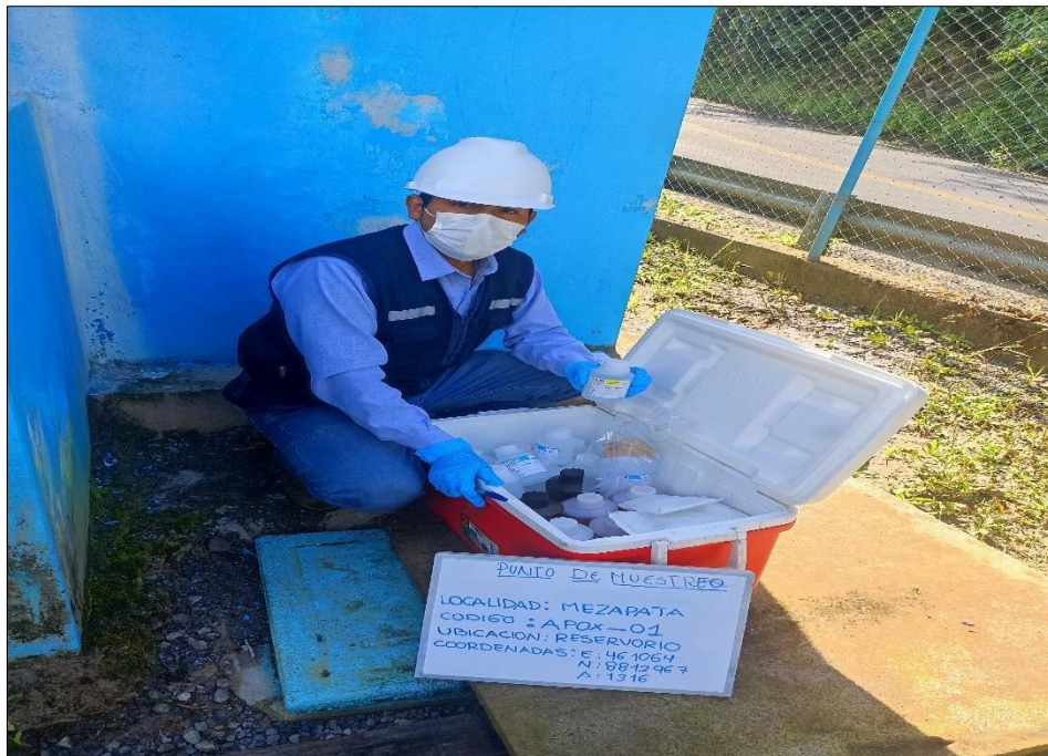
Foto N° 8.- Muestras de agua del reservorio del sistema de abastecimiento de agua del anexo de Mesapata; listos para la evaluación y análisis en laboratorio.
