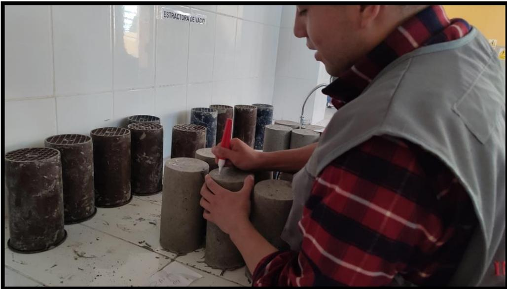
**Fotografía 8.-** Colocando el código de las probetas con fibras sintéticas
