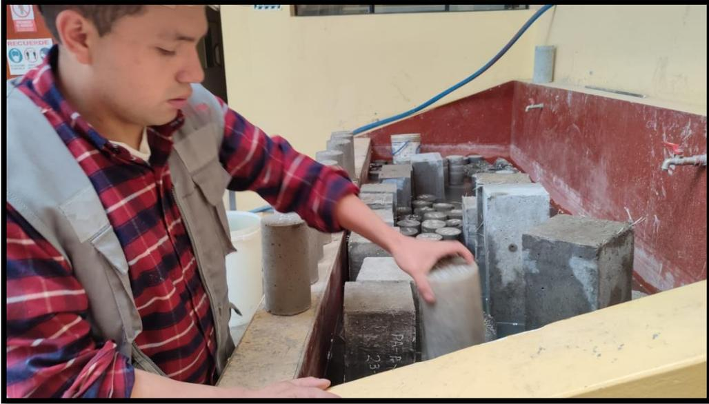
**Fotografía 9.-** Colocando las probetas con fibras de acero en el pozo de curado
