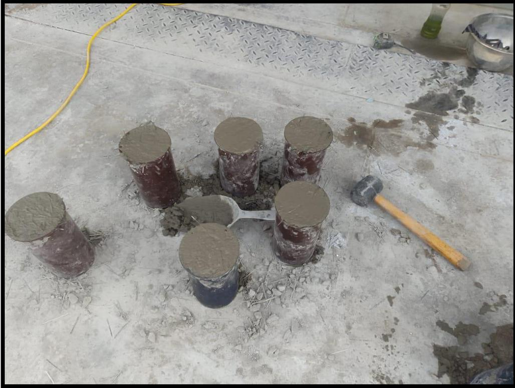
**Fotografía 5.-** Enrasado de probetas para su posterior almacenamiento y fraguado
