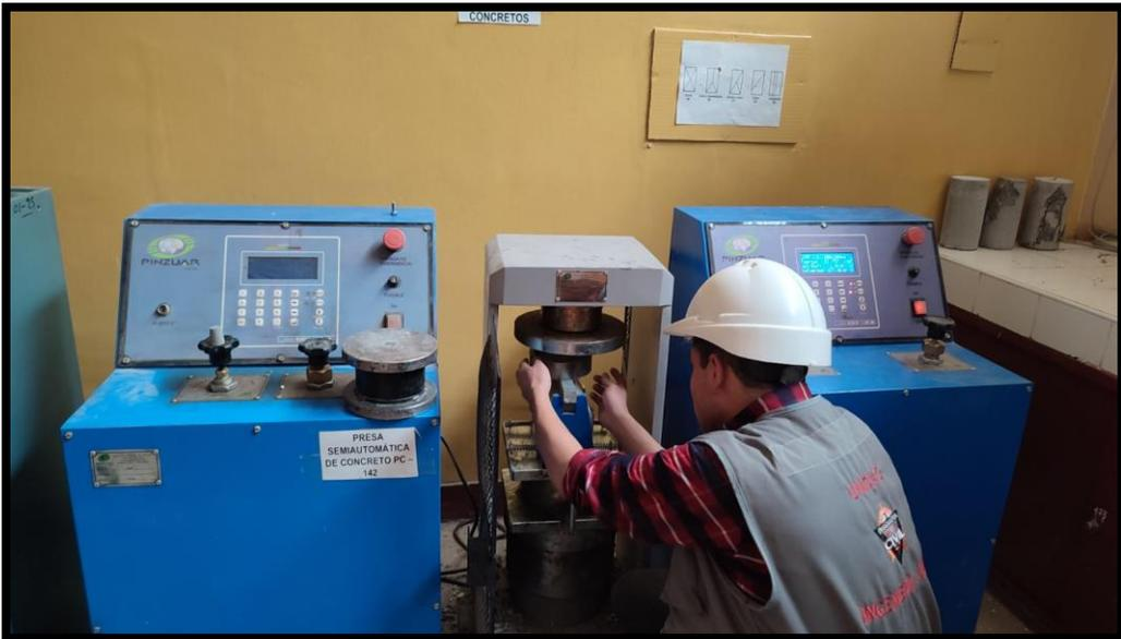
**Fotografía 22.-** Colocando la probeta y herramientas necesarias en la prensa para el ensayo a tracción indirecta
