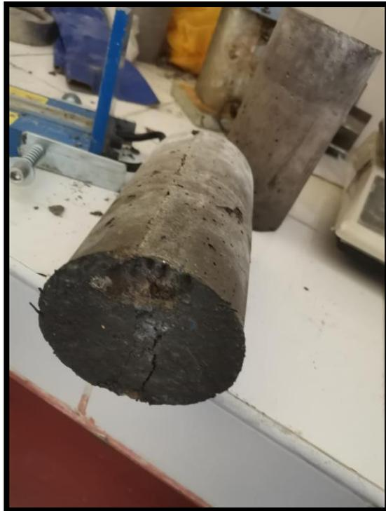
**Fotografía 30.-** Fractura a lo largo del diámetro y con ligero descascaramiento
