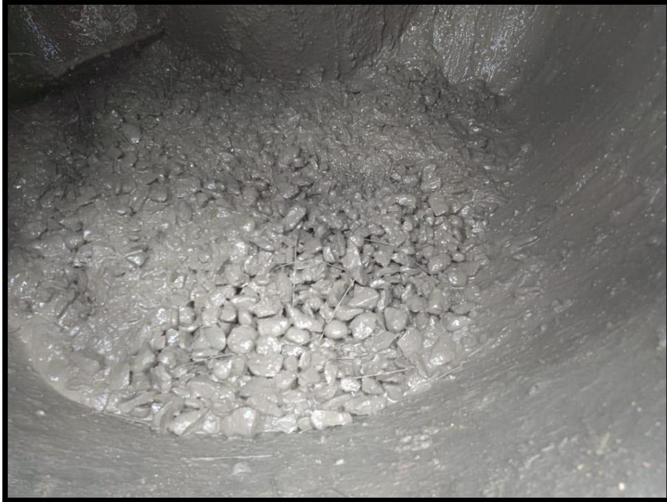
**Fotografía 3.-** Vista del concreto fresco al terminar el mezclado
