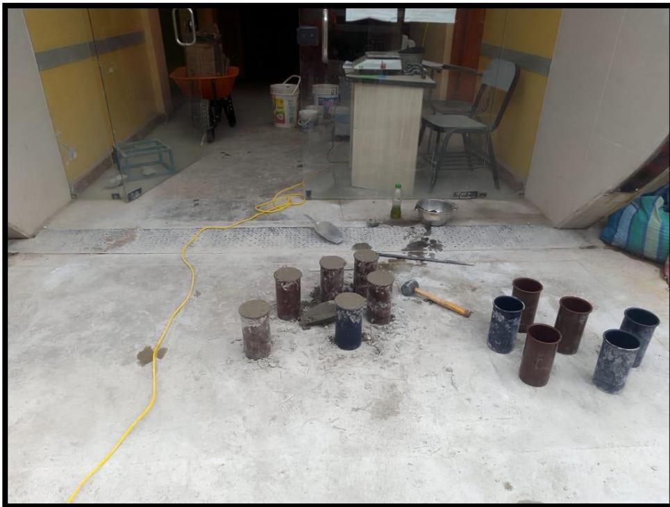
**Fotografía 4.-** Llenado de moldes respetando capas y compactación según norma
