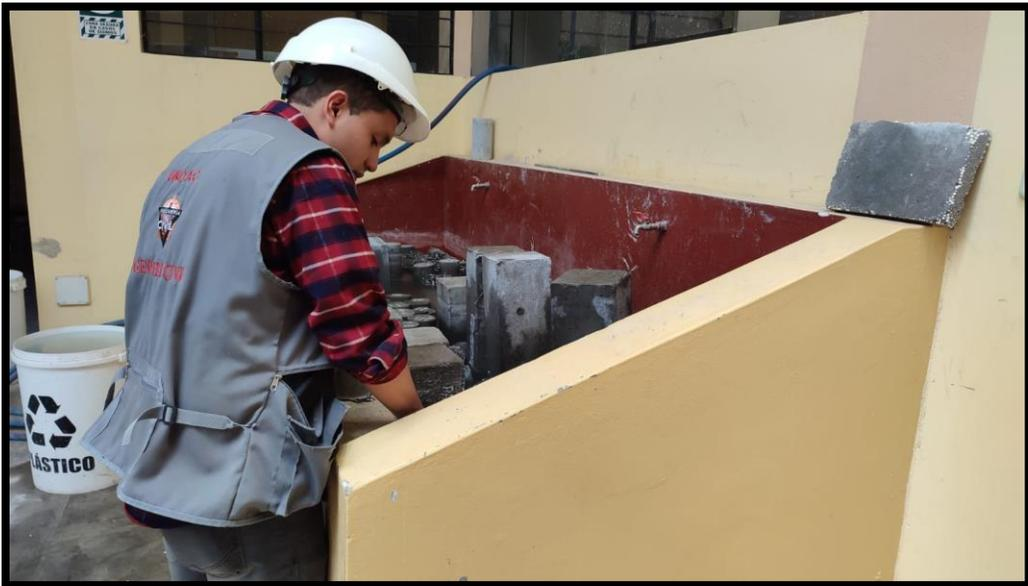
**Fotografía 10.-** Colocando las probetas con fibras sintéticas en el pozo de curado
