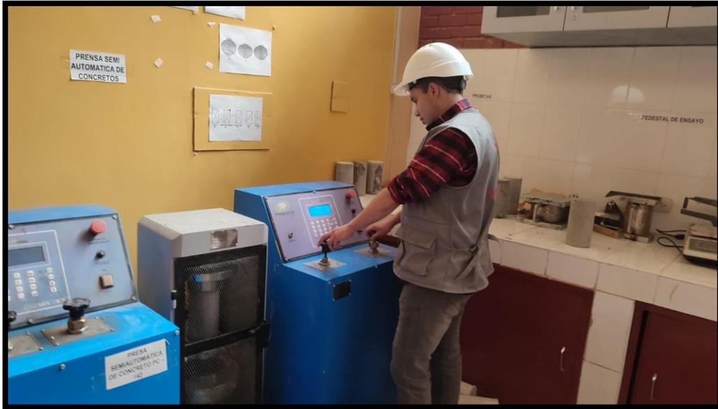
**Fotografía 19.-** Cargando la prensa hidráulica y regulando la velocidad según norma
