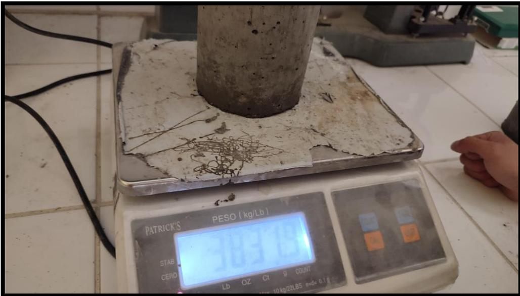
**Fotografía 16.-** Pesaje de las probetas con fibra sintéticas para el ensayo a compresión
