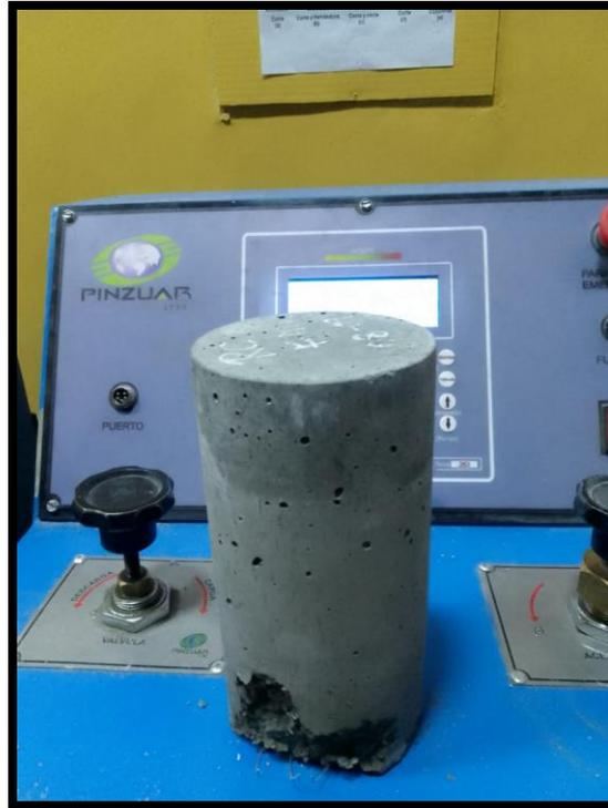
**Fotografía 27.-** Falla en corte en la base producido por el ensayo a compresión
