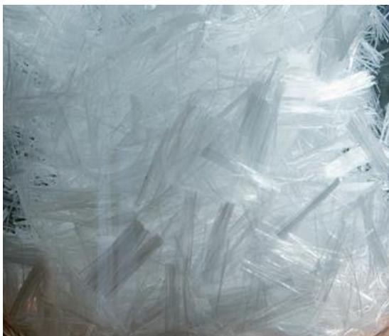
Nota. Tomada de Análisis técnico económico de la incorporación de macrofibras de polipropileno en reemplazo de malla electrosoldada en hormigones para pavimentos industriales (10).
