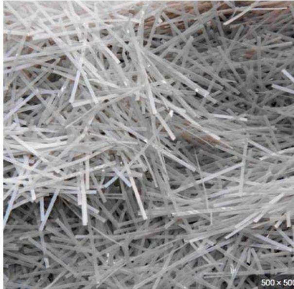
Nota. Tipo I. Tomada de Análisis técnico económico de la incorporación de macrofibras de polipropileno en reemplazo de malla electrosoldada en hormigones para pavimentos industriales (10).
