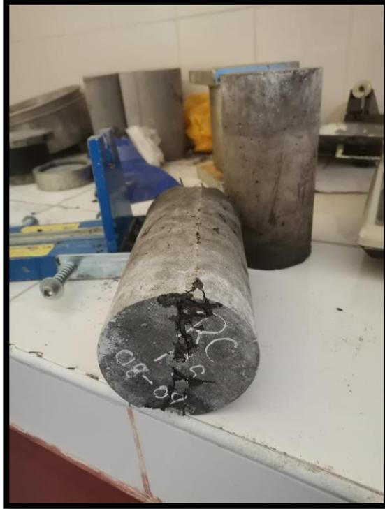
**Fotografía 29.-** Fractura a lo largo del diámetro y con ligero descascaramiento
