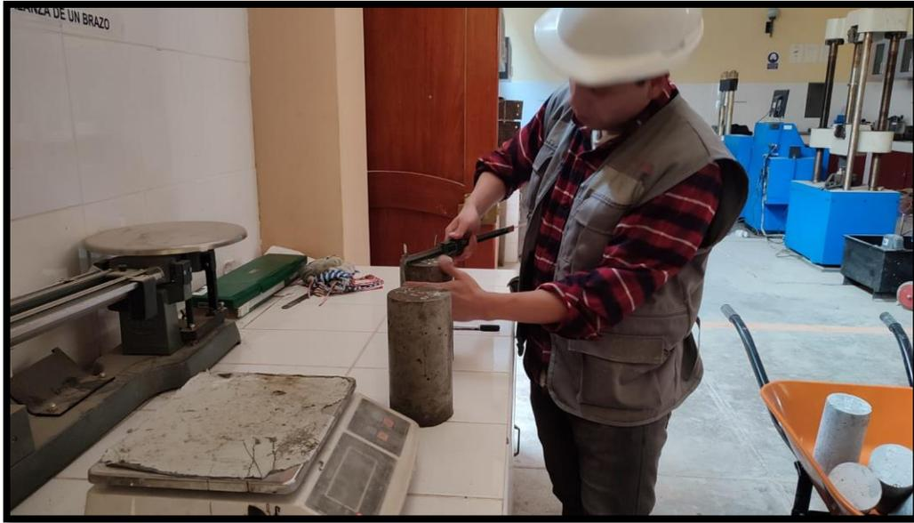
**Fotografía 13.-** Medida del diámetro de las probetas con fibras sintéticas para el ensayo a compresión
