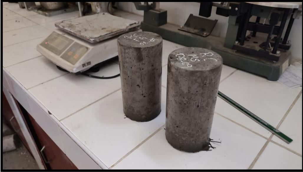
**Fotografía 11.-** Pesaje de probetas que se someterán al ensayo a compresión
