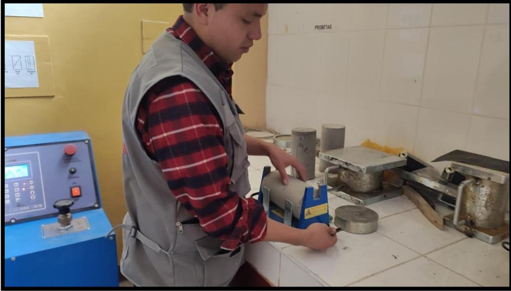
**Fotografía 21.-** Alistando la probeta para el ensayo a tracción indirecta
