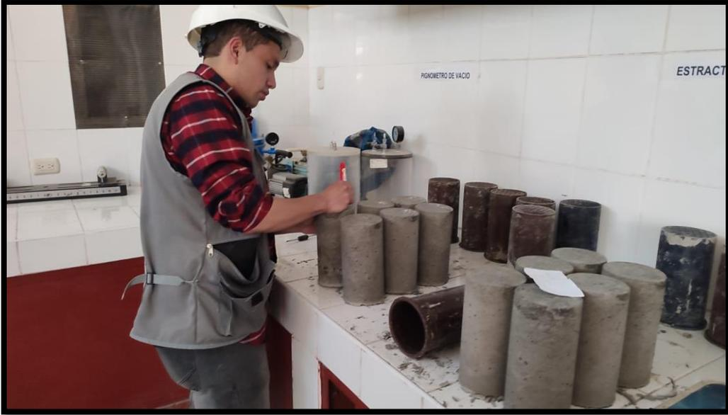
**Fotografía 7.-** Colocando el código de las probetas con fibras de acero
