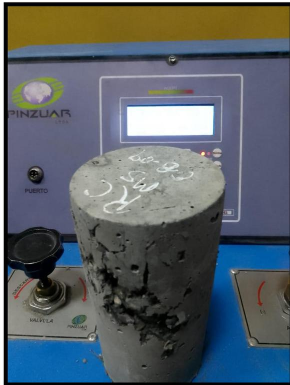
**Fotografía 26.-** Falla en corte producido por el ensayo a compresión
