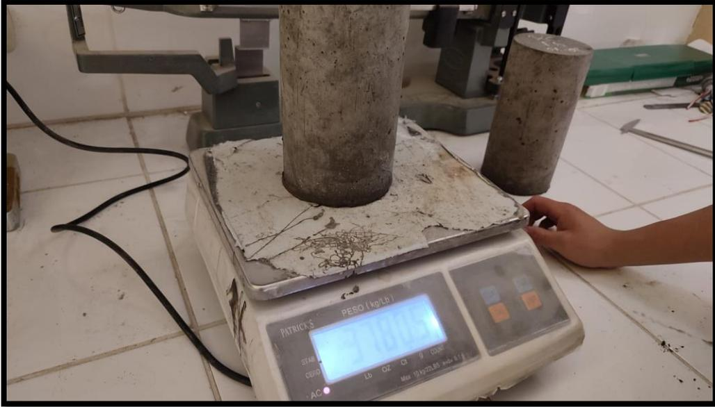
**Fotografía 15.-** Pesaje de las probetas con fibra de acero para el ensayo a compresión
