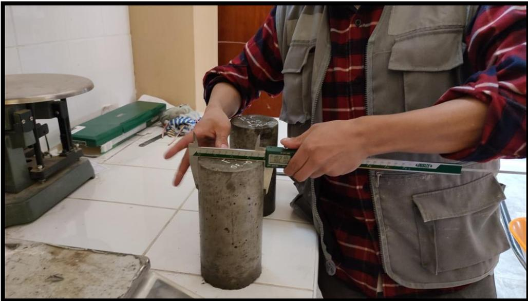
**Fotografía 12.-** Medida del diámetro de las probetas con fibras de acero para el ensayo a compresión
