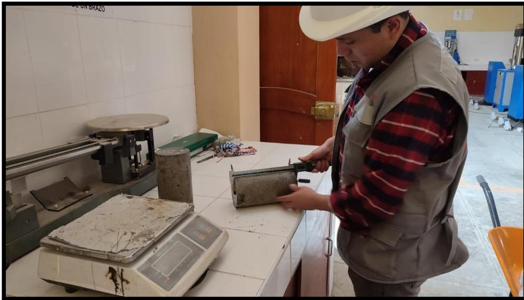
**Fotografía 14.-** Medida de la altura de la probeta para el ensayo a tracción indirecta
