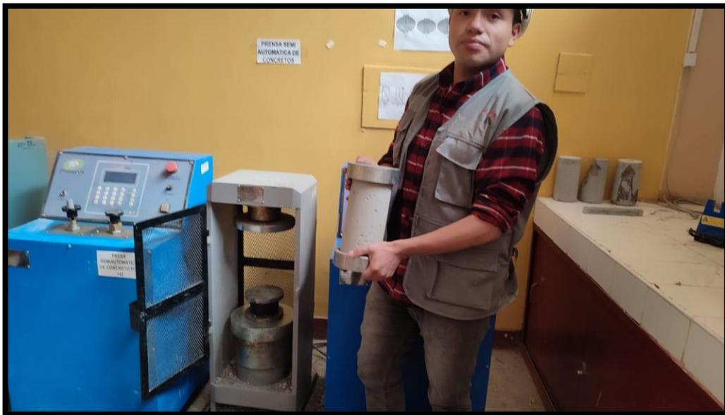
**Fotografía 18.-** Colocación de probetas en la prensa hidráulica para el ensayo a compresión
