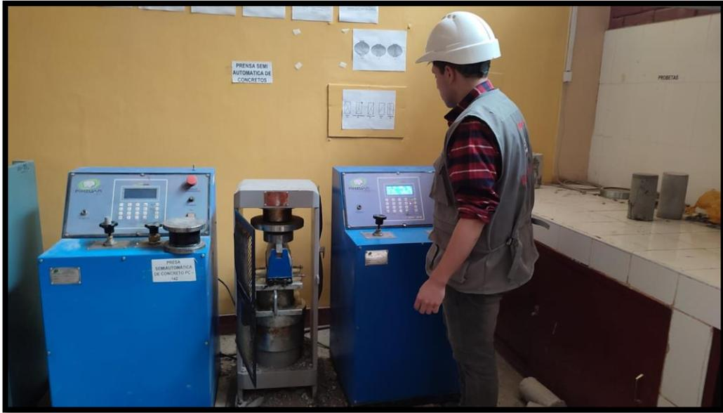
**Fotografía 23.-** Cargando prensa y regulando velocidad para el ensayo a tracción indirecta
