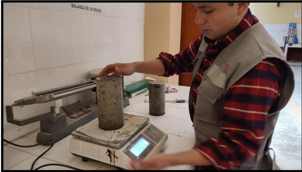
**Fotografía 17.-** Pesaje de las probetas para el ensayo a tracción indirecta
