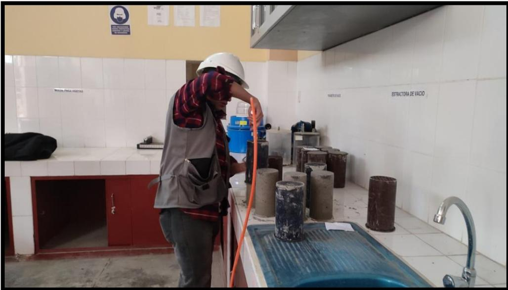
**Fotografía 6.-** Desmoldando las probetas 24h después del enrasado
