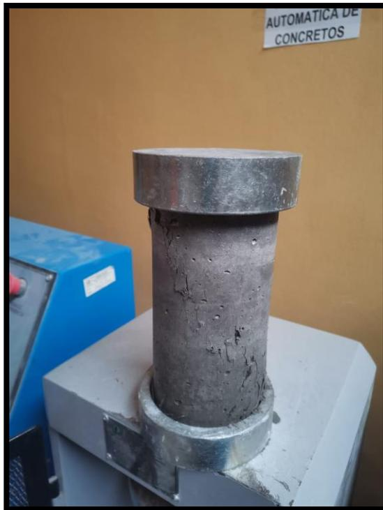
**Fotografía 34.-** Falla en corte producido por el ensayo a compresión
