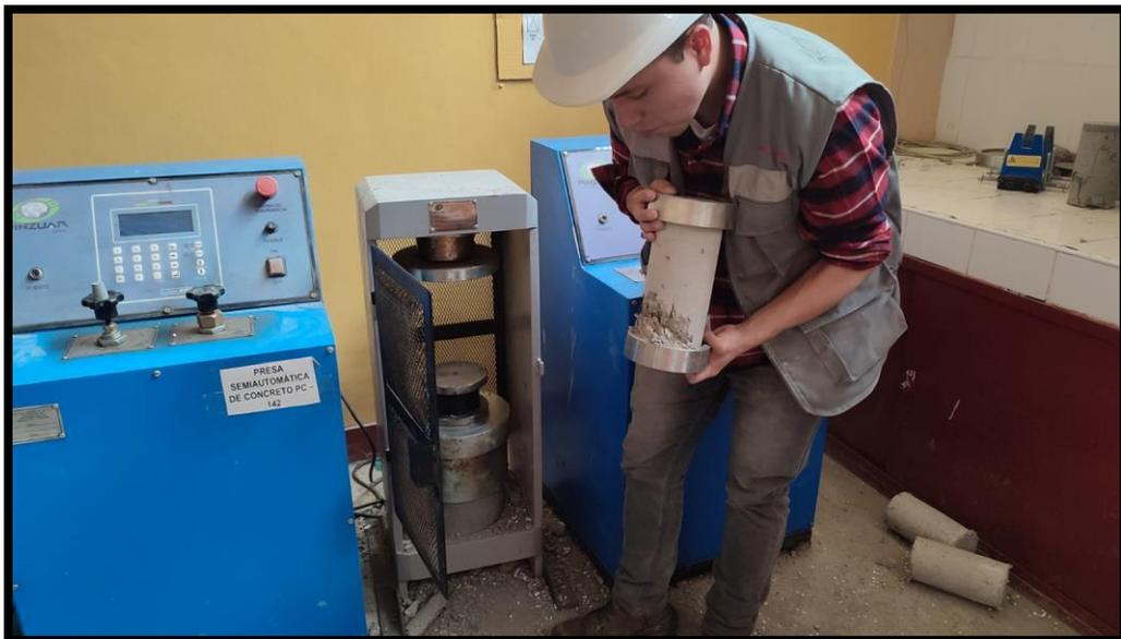
**Fotografía 20.-** Verificando el tipo de falla a compresión producida en la probeta
