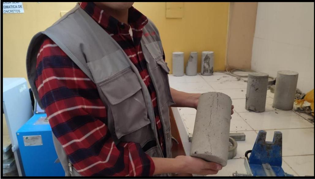
**Fotografía 25.-** Identificando el tipo de falla producido por el ensayo a tracción indirecta
