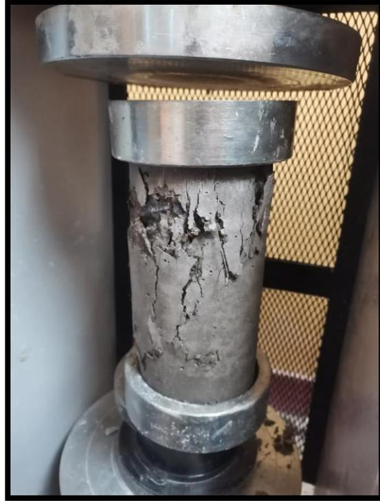
**Fotografía 31.-** Falla en cono y corte producido por el ensayo a compresión
