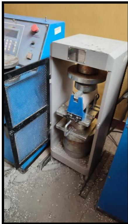
**Fotografía 24.-** Fallo de la probeta mediante el ensayo a tracción indirecta
