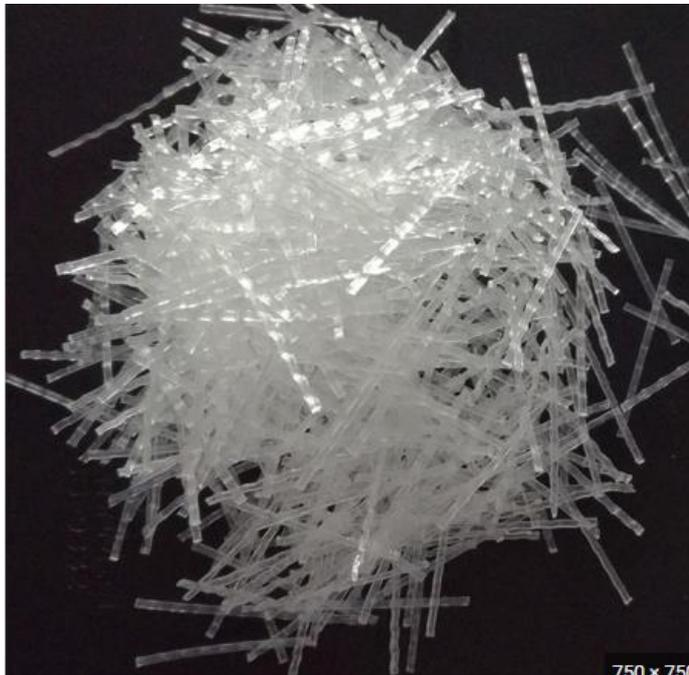
Nota. Tomada de Análisis técnico económico de la incorporación de macrofibras de polipropileno en reemplazo de malla electrosoldada en hormigones para pavimentos industriales (10).
