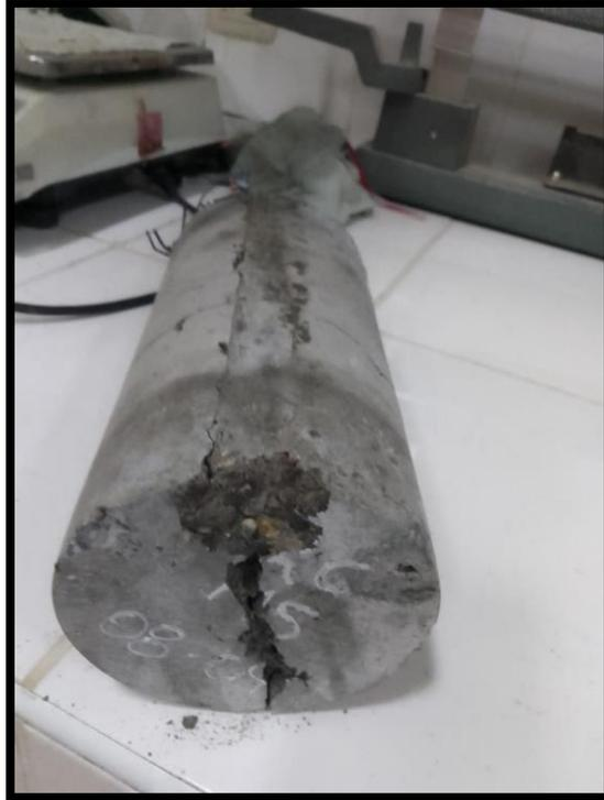
**Fotografía 33.-** Fractura a lo largo del diámetro y alto descascaramiento
