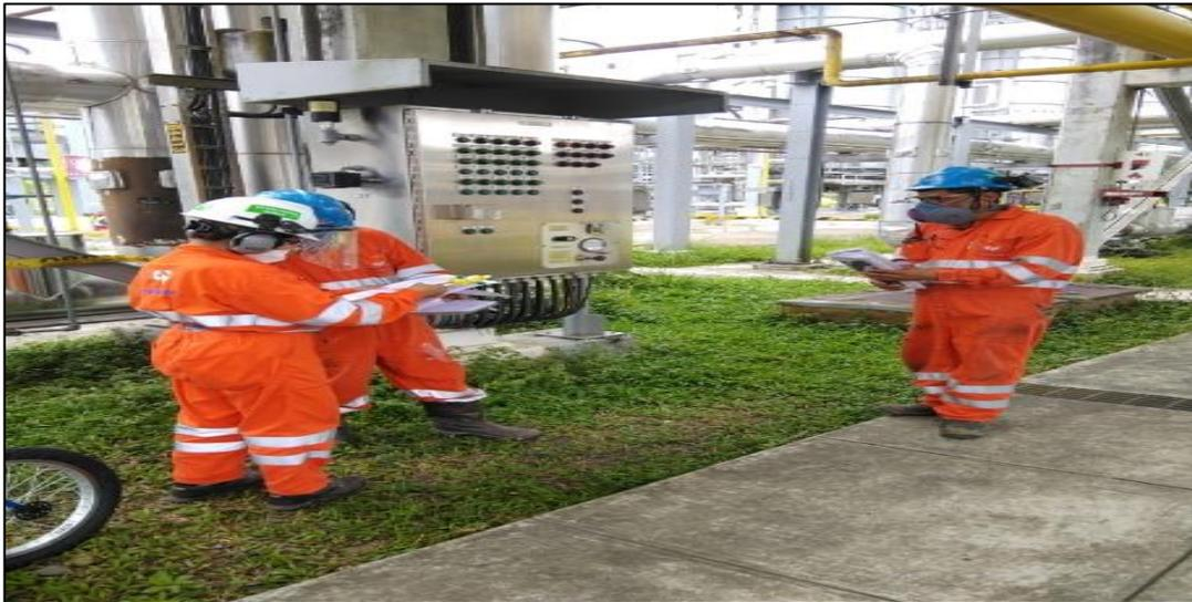
Identificación de peligros y evaluación de riesgo en Monitoreo por ultrasonido a válvula de control de flujo de gas en equipo operativo.
