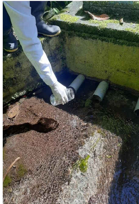
Fotografía N° 4: Toma de muestras de la captación
