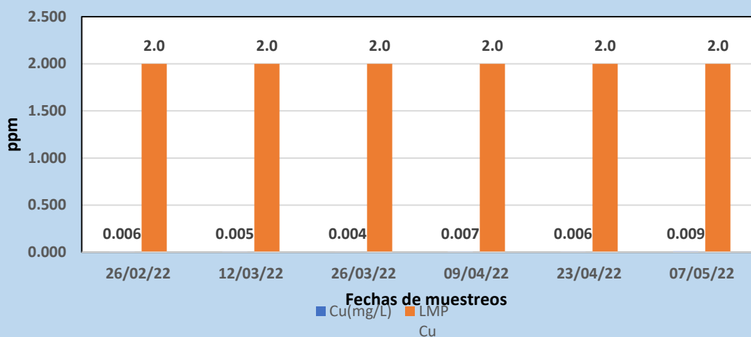
Gráfico 4: Análisis cobre en pileta en relación a los Límites Máximos Permisibles según el DS N° 031-2010-SA
