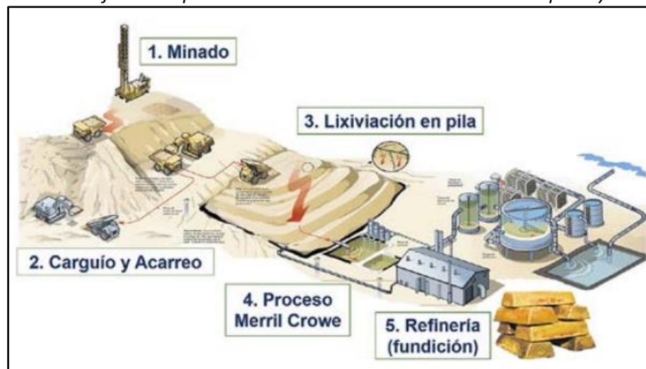
Gráfico 9: Esquema de la Producción de Oro en la mina Apumayo
