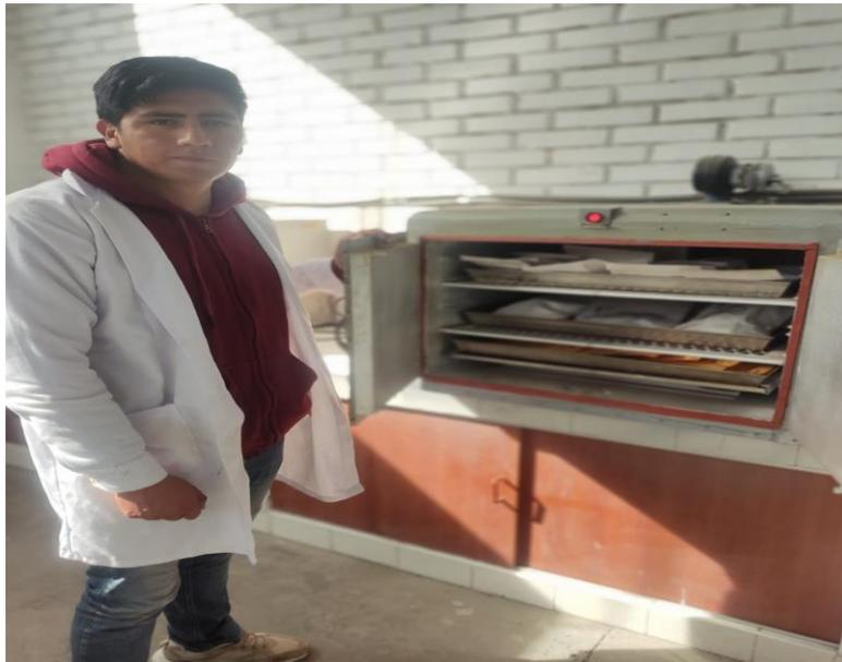
FOTO N°7: Metiendo las muestras al horno de vacío para su secado
