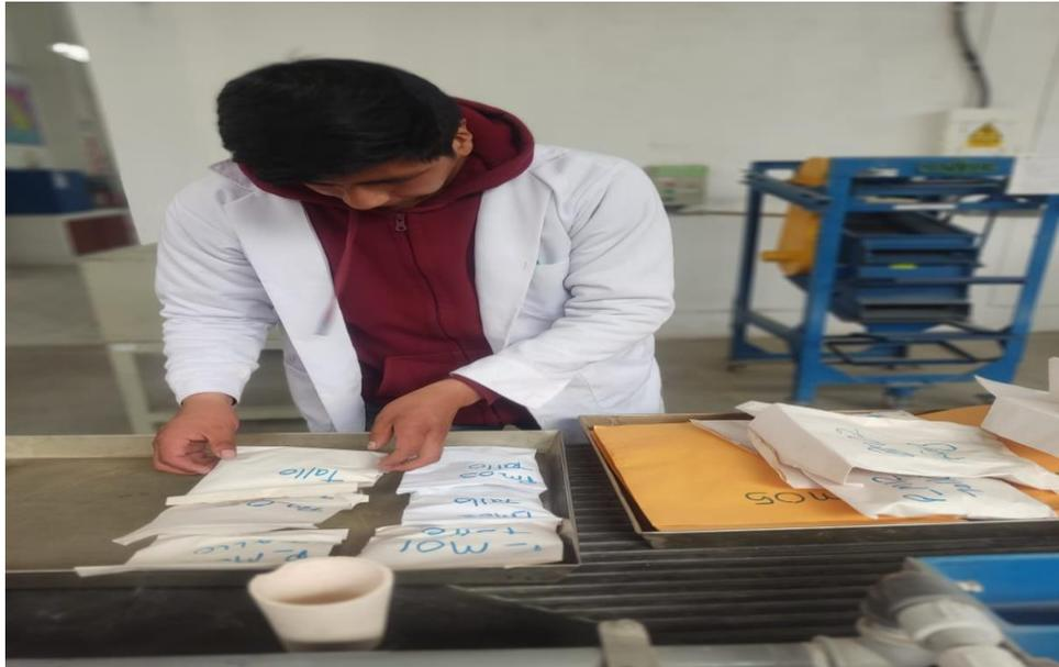
FOTO N° 8: Preparando las muestras para ponerlas en el crisol para su posterior incineración
