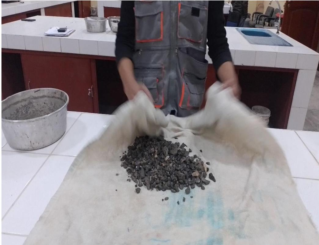
Fotografía N° 17: Ensayo de peso específico y absorción del agregado
