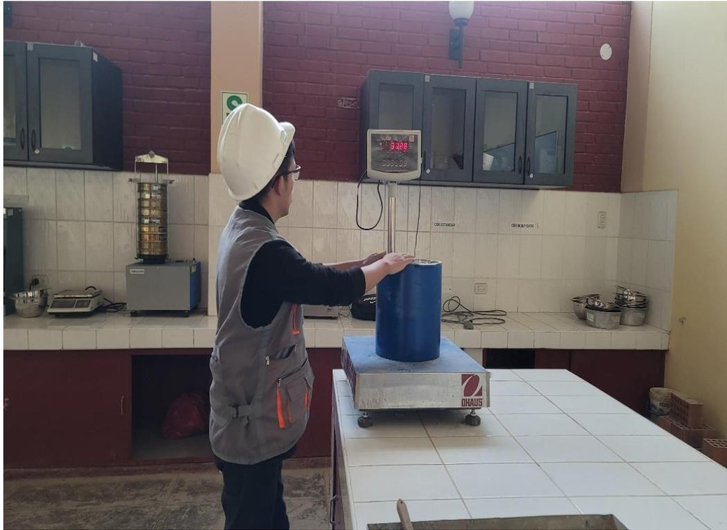
Fotografía N°07: Peso unitario compactado de los agregados finos y gruesos.
