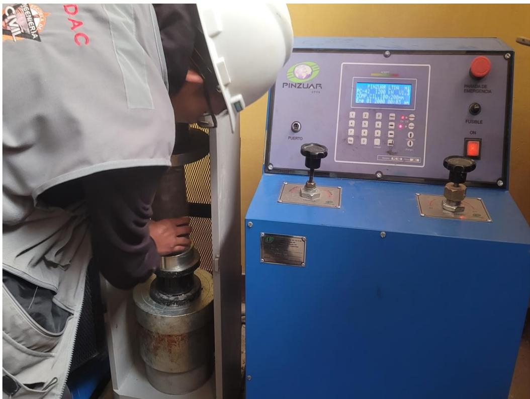
Fotografía N°38: proceso de ensayo las probetas de concreto para resistencia a la compresión.
