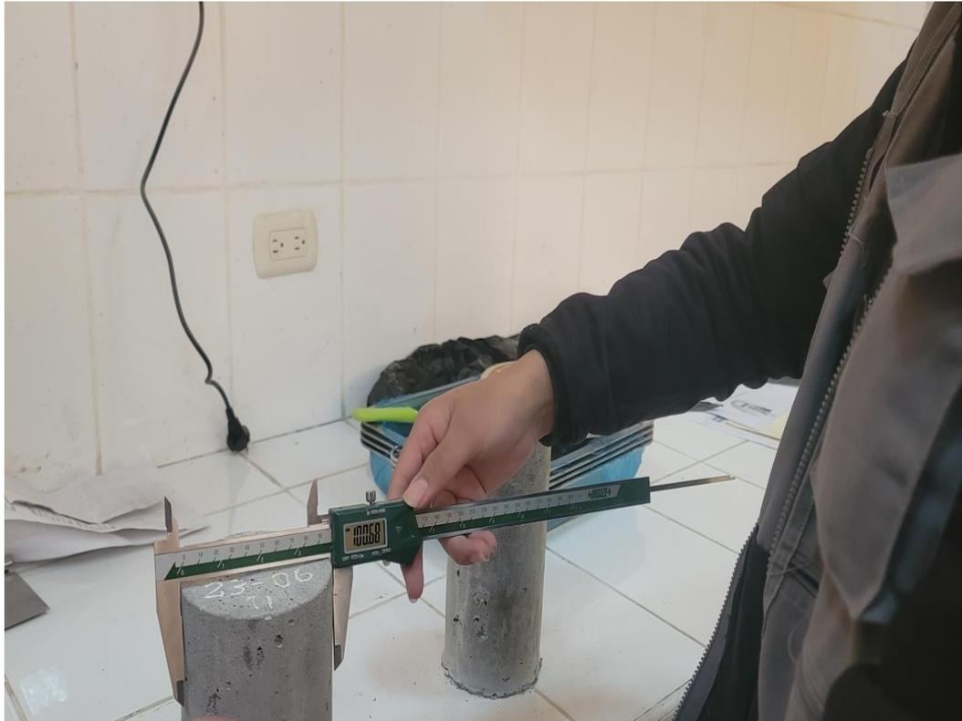
Fotografía N°37: proceso de toma de medidas y peso de las probetas de concreto.
