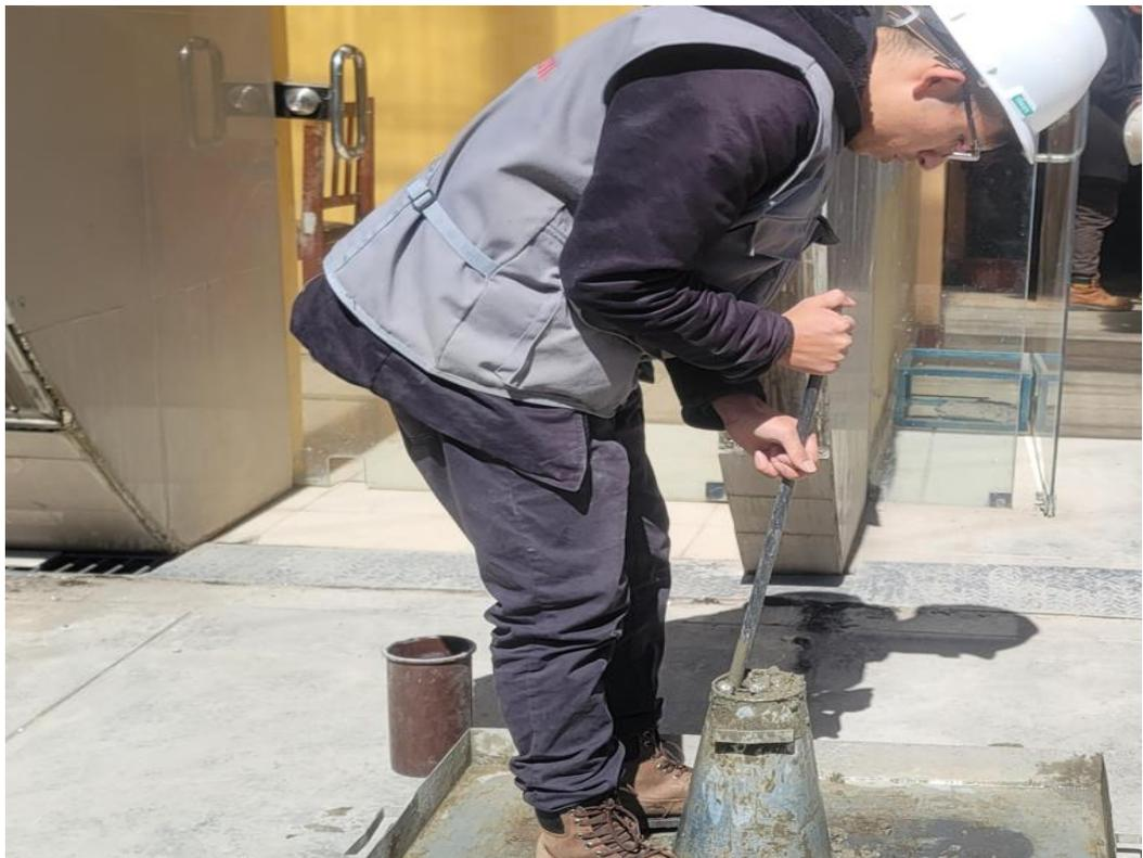
Fotografía N°29: proceso de ensayo cono de Abrams.
