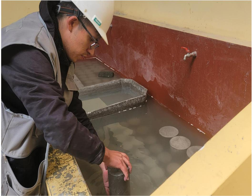
Fotografía N°36: proceso de curado las probetas de concreto.
