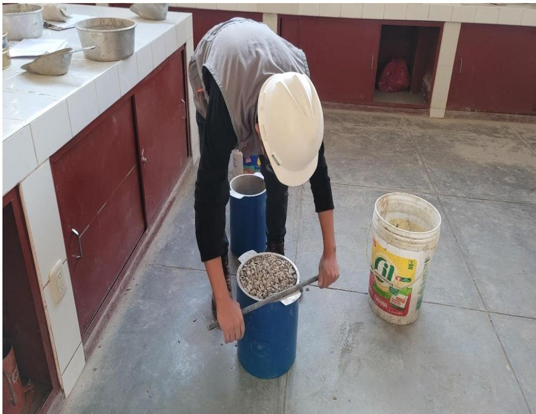
Fotografía N°06: Peso unitario compactado de los agregados finos y gruesos.
