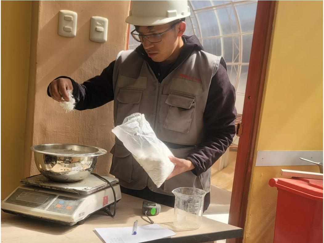
Fotografía N°26: Dosificación de microfibras para diseño de mezcla.
