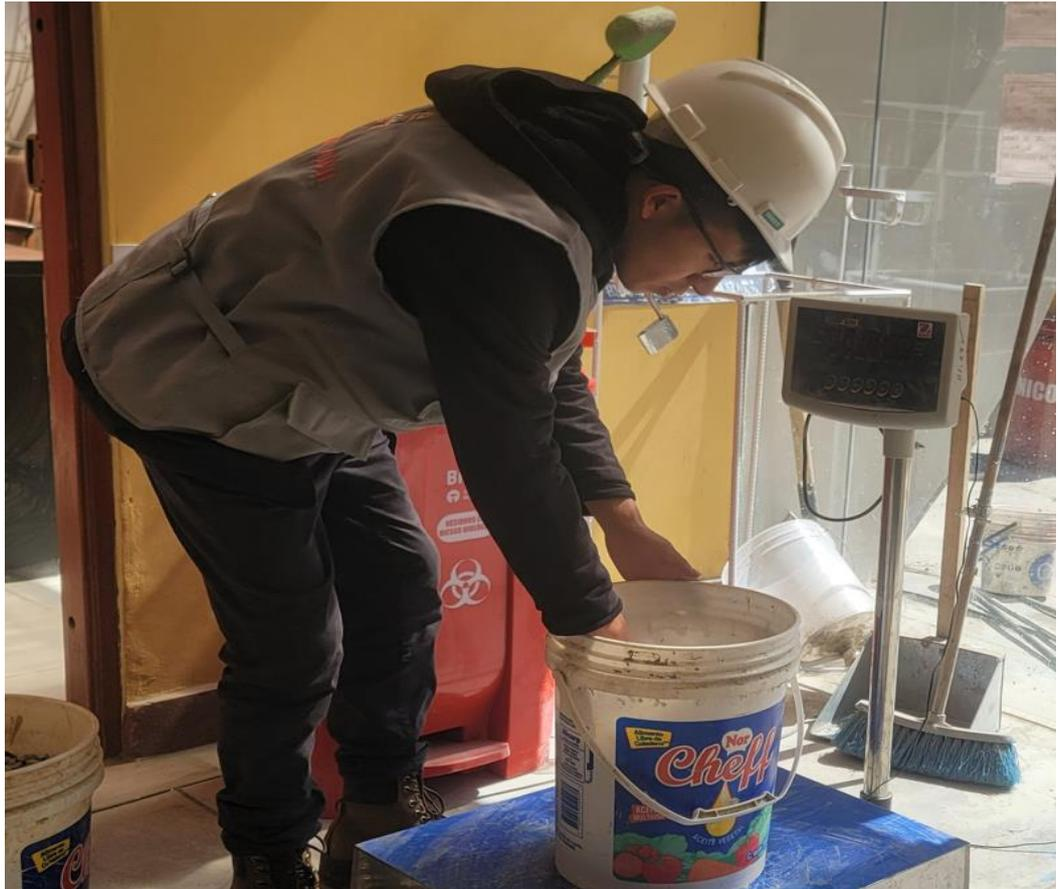
Fotografía N°23: Dosificación de los agregados para diseño de mezcla.
