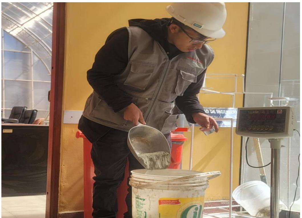
Fotografía N°24: Dosificación del cemento para diseño de mezcla.
