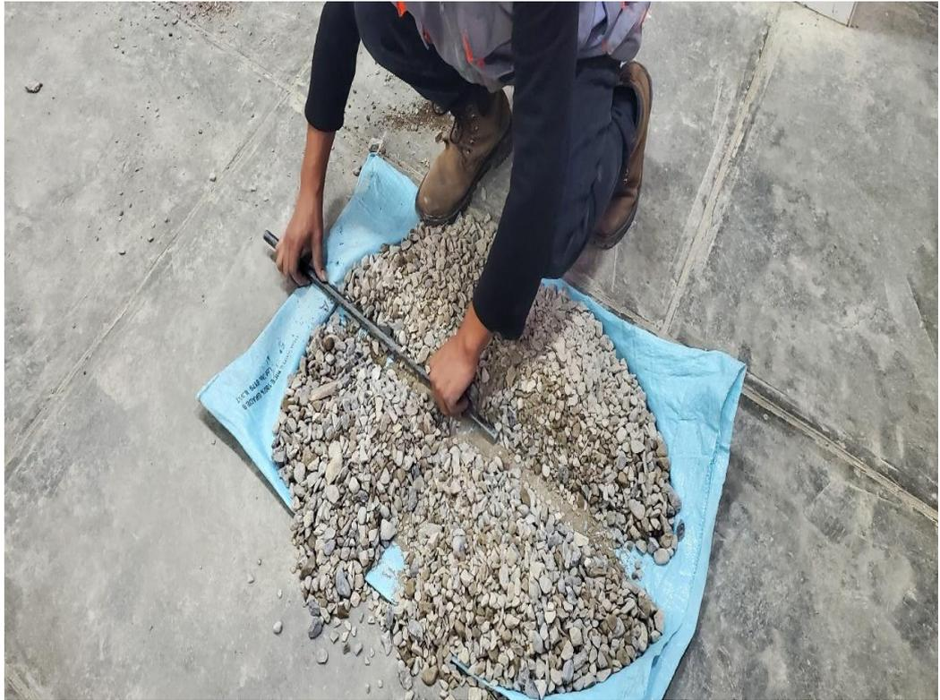
Fotografía N°11: caracterización y cuarteo de los agregados.
