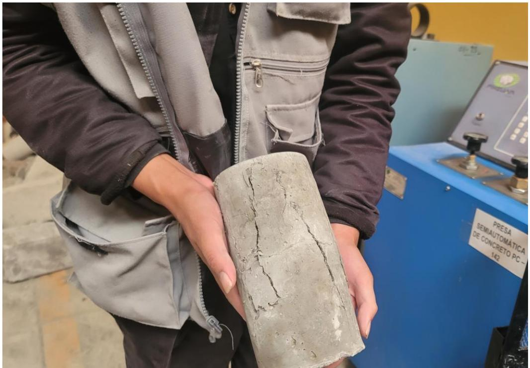
Fotografía N°42 evaluación del tipo de rotura en el ensayo de las probetas de concreto para resistencia a la compresión.
