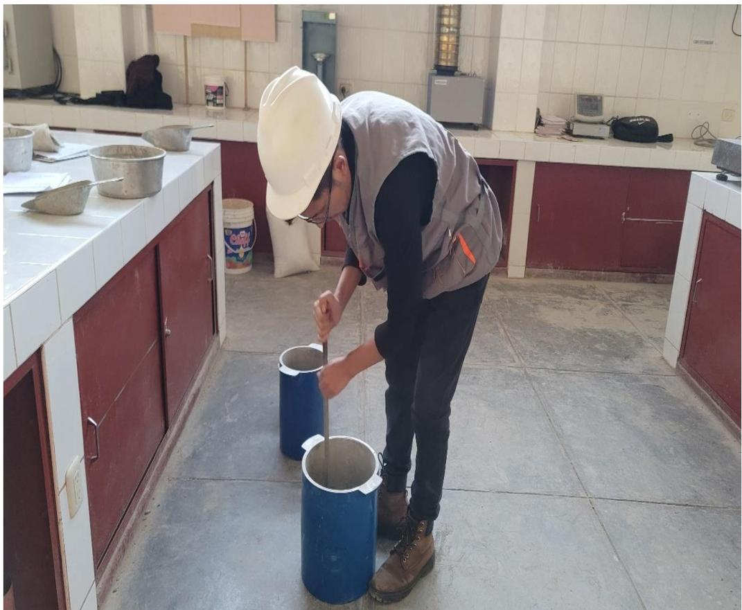
Fotografía N°04: Peso unitario compactado de los agregados finos y gruesos.
