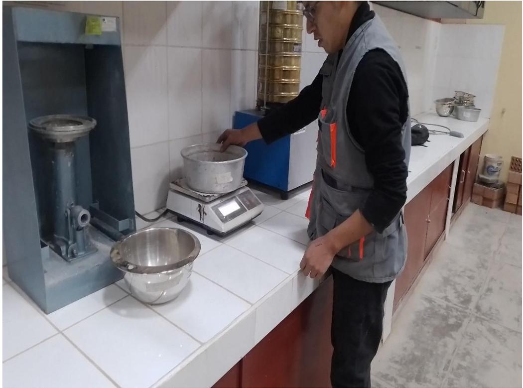
Fotografía N°13: Ensayo de peso específico y absorción del agregado
