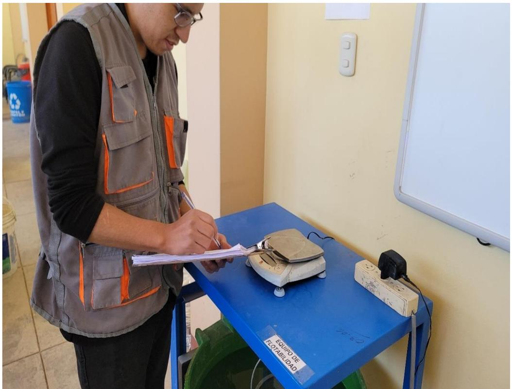
Fotografía N°20: Ensayo de peso específico y absorción del agregado
