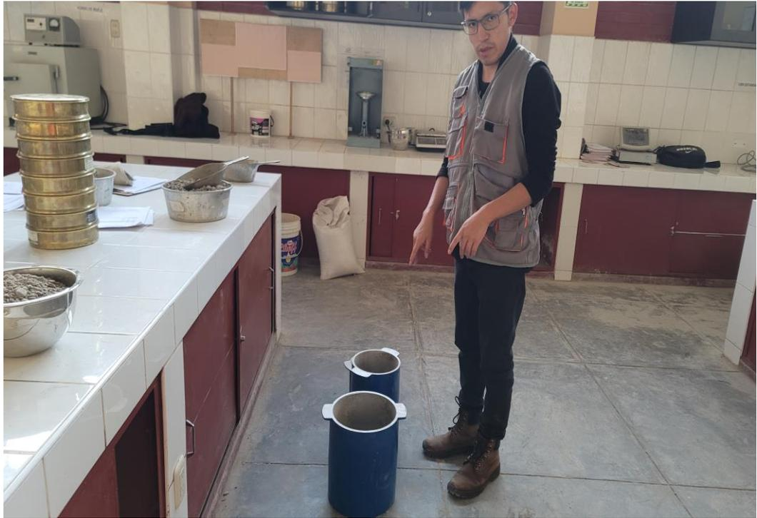
Fotografía N°03: Peso unitario compactado de los agregados finos y gruesos.
