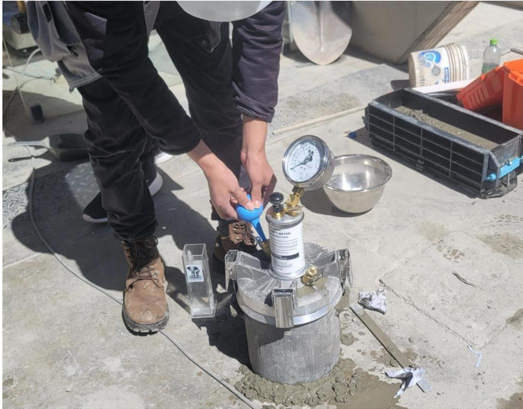
Fotografía N°34: proceso del ensayo de la incorporación de aire al concreto.
