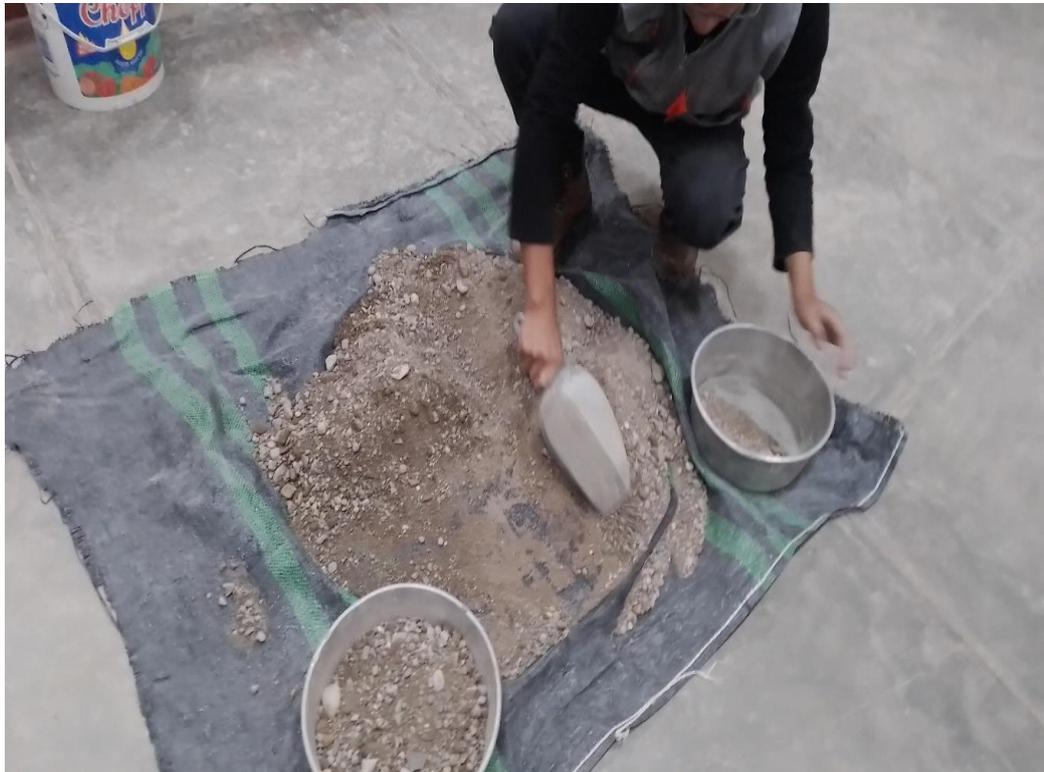
Fotografía N°16: caracterización y cuarteo de los agregados.
