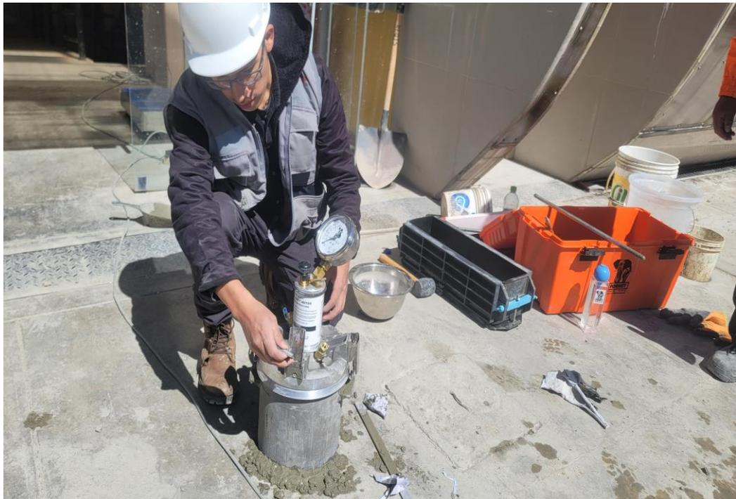
Fotografía N°33: proceso del ensayo de la incorporación de aire al concreto.
