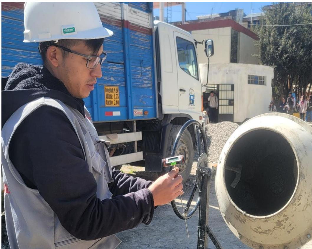
Fotografía N°31: proceso de toma de temperatura del concreto en estado fresco.
