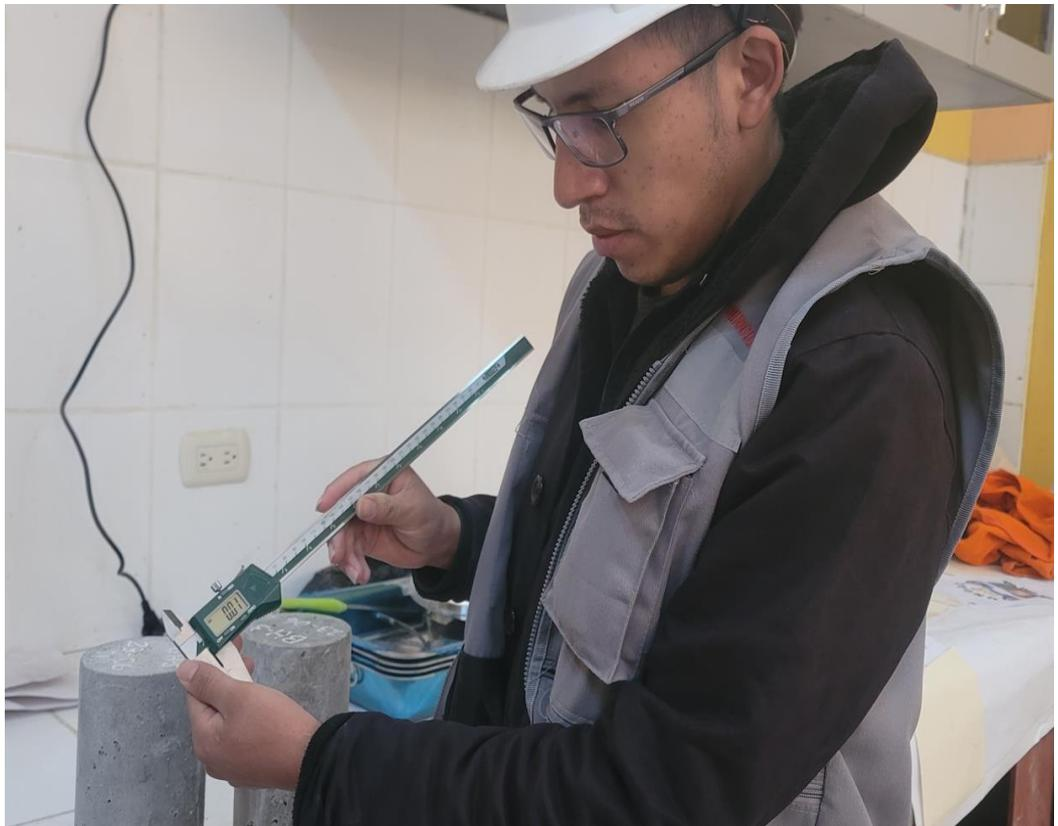
Fotografía N°37: proceso de toma de medidas y peso de las probetas de concreto.
