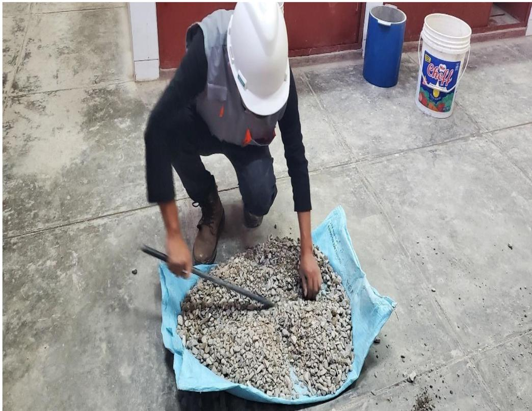
Fotografía N°10: caracterización y cuarteo de los agregados.
