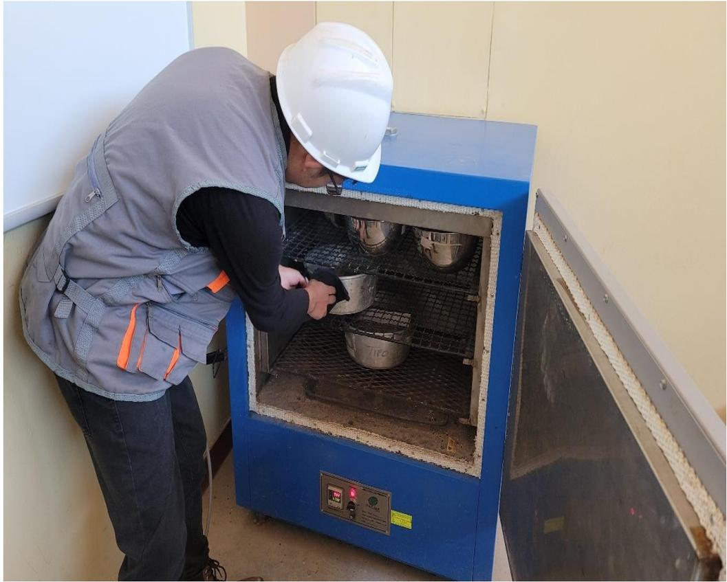
Fotografía N°21: obtención de resultados de las muestras secado en el horno.
