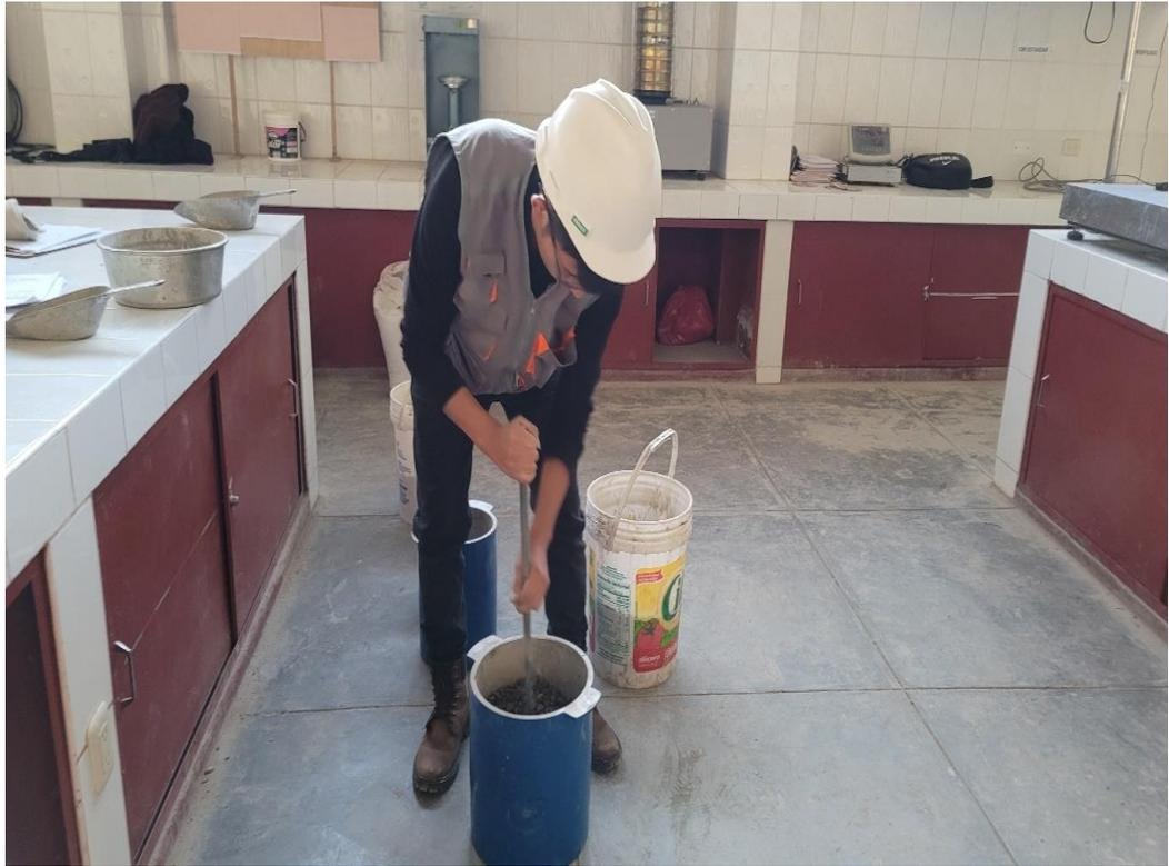
Fotografía N°05: Peso unitario compactado de los agregados finos y gruesos.
