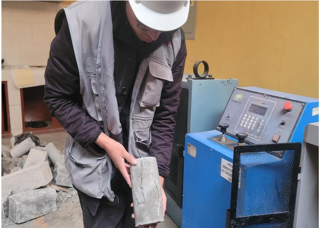
Fotografía N°41 evaluación del tipo de rotura en el ensayo de las probetas de concreto para resistencia a la compresión.
