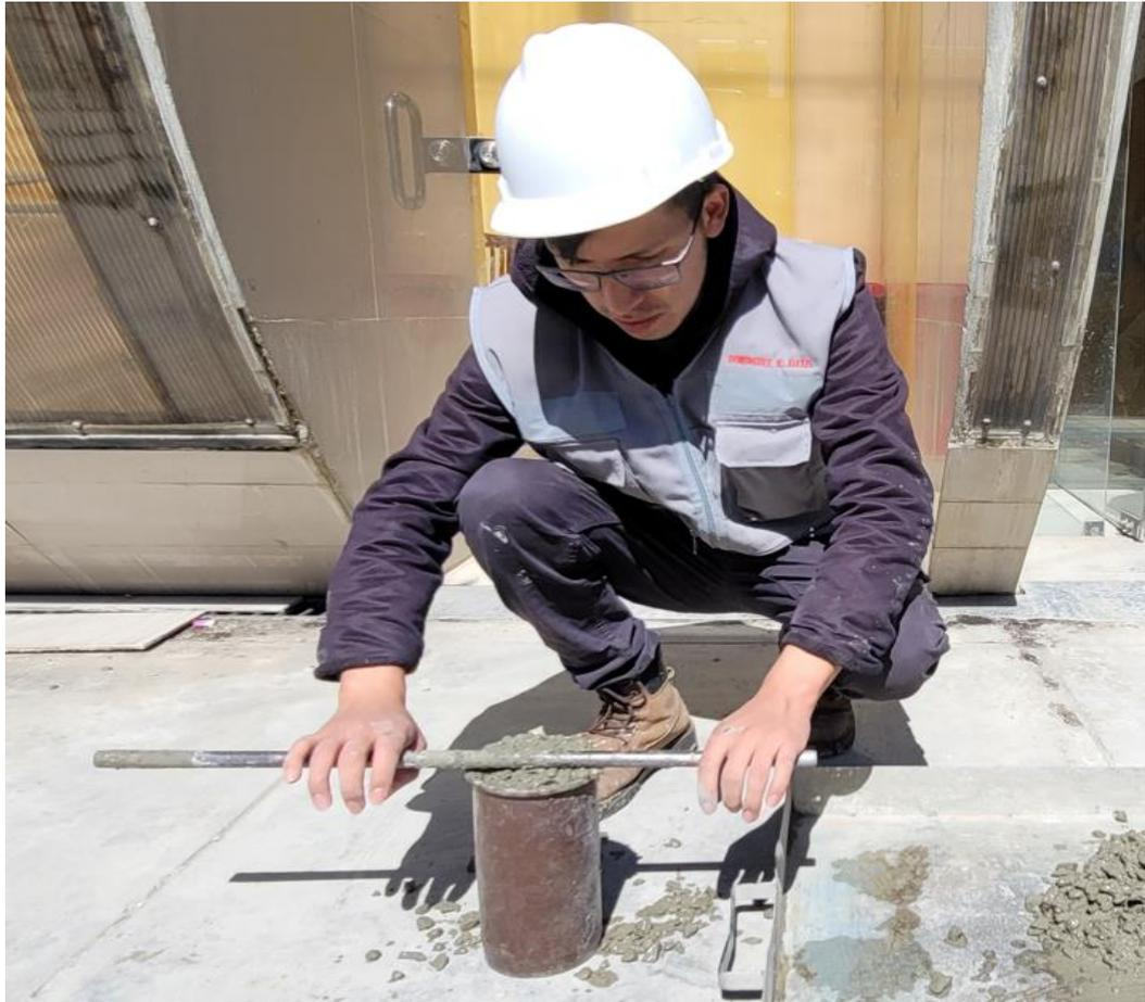
Fotografía N°32: proceso de elaboración de probetas de 4" x 8"
