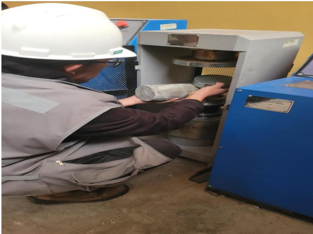
Fotografía N°40: proceso de ensayo las probetas de concreto para resistencia a la compresión.
