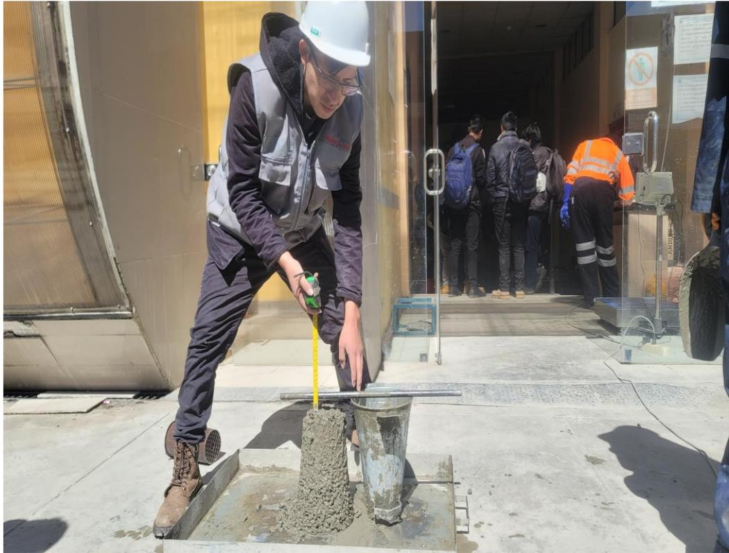
Fotografía N°30: proceso de medición el asentamiento del concreto.
