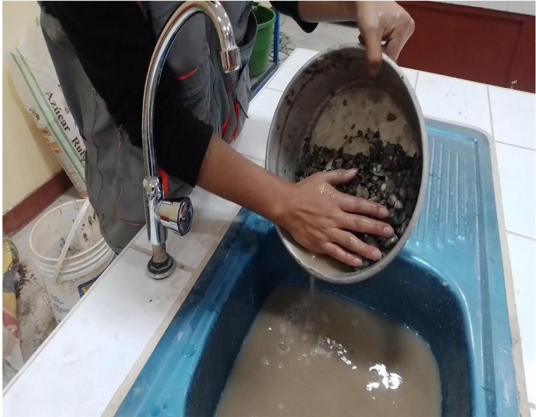
Fotografía N°15: Ensayo de peso específico y absorción del agregado
