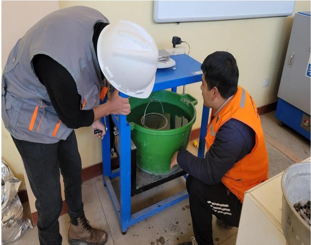
Fotografía N°19: Ensayo de peso específico y absorción del agregado
