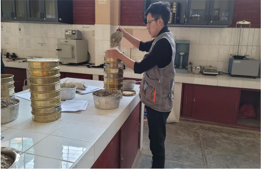
Fotografía N°01: Análisis granulométrico de agregados finos y gruesos.
