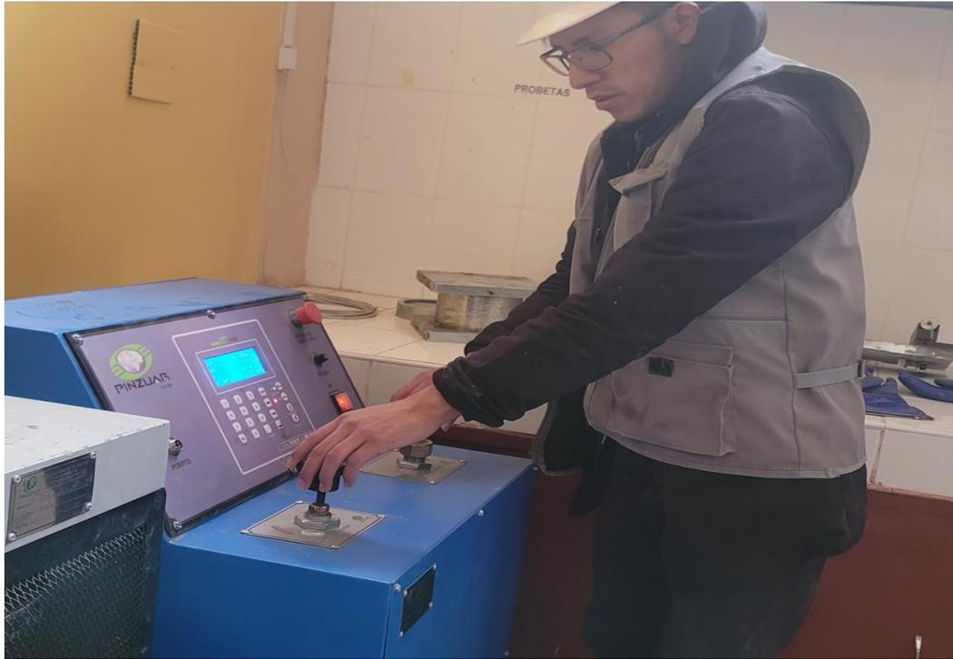
Fotografía N°39 proceso de controlar la velocidad en el ensayo de las probetas de concreto para resistencia a la compresión.
