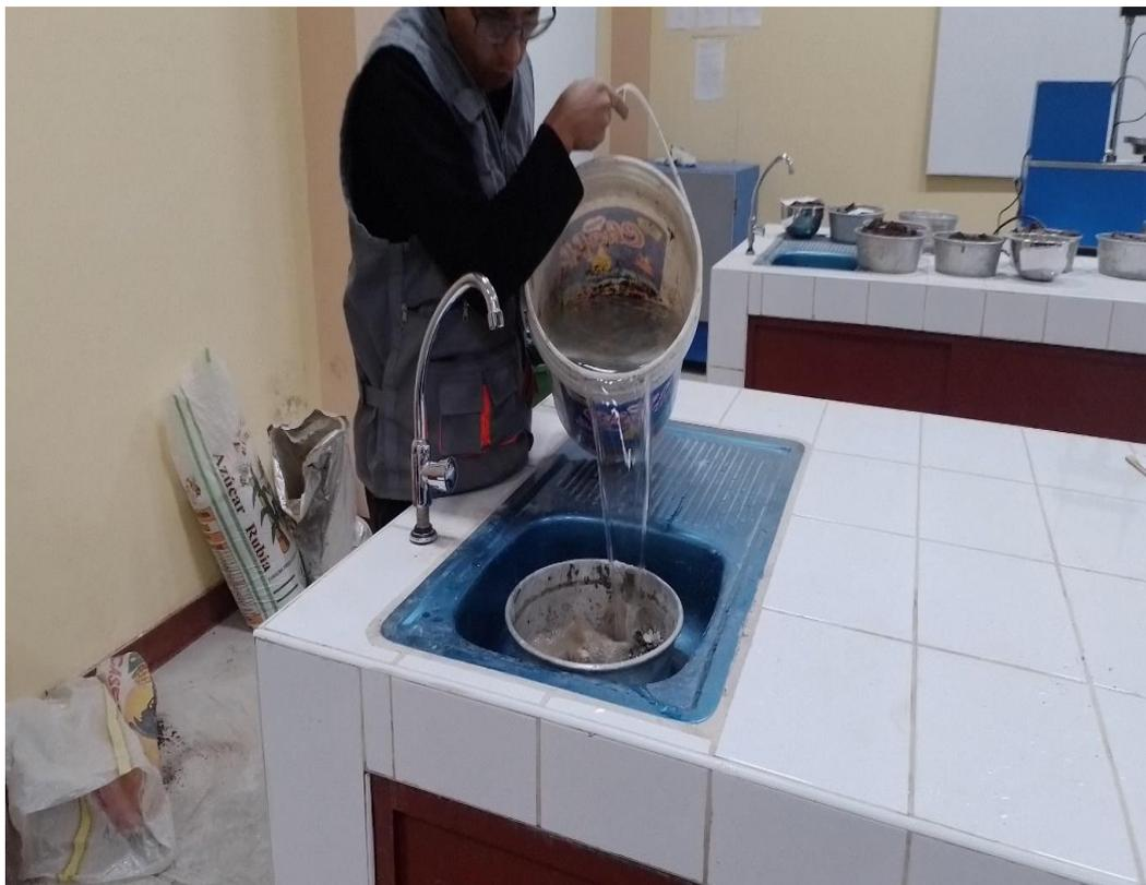
Fotografía N°14: Ensayo de peso específico y absorción del agregado
