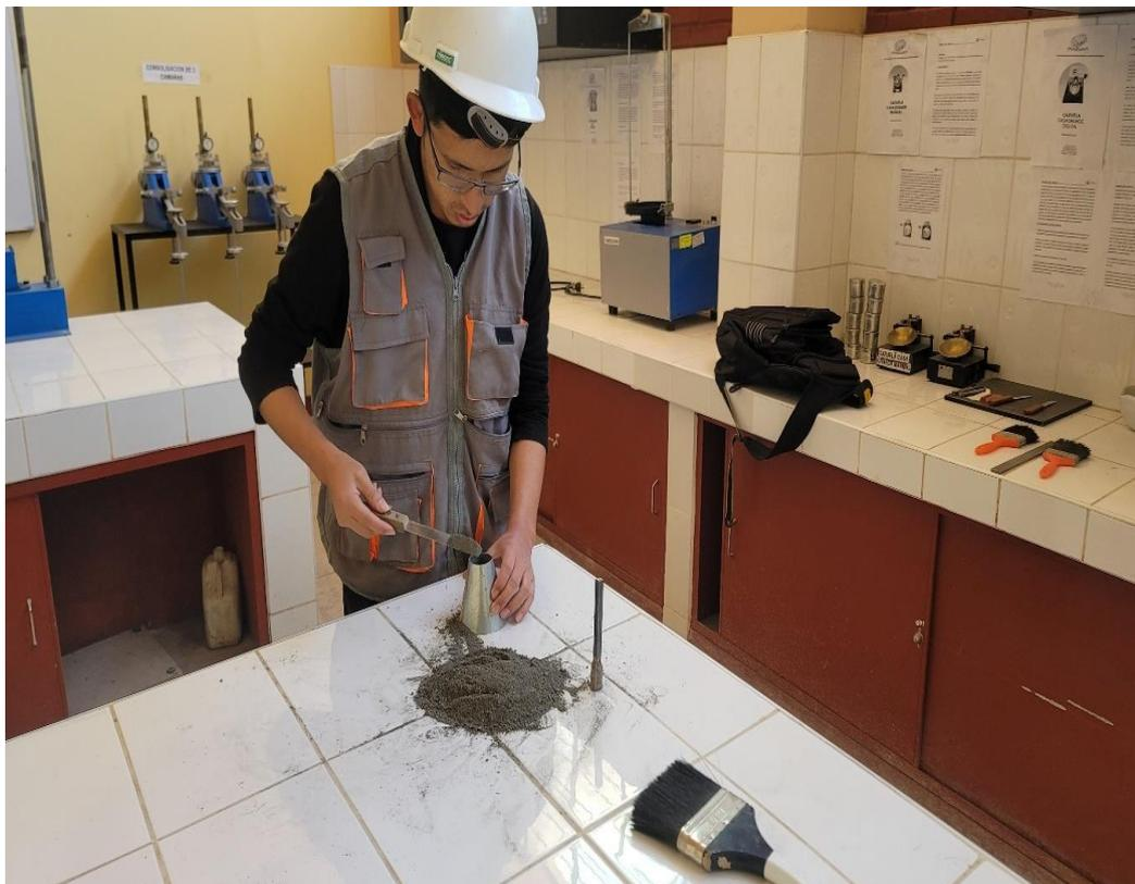
Fotografía N° 18: caracterización y cuarteo de los agregados.
