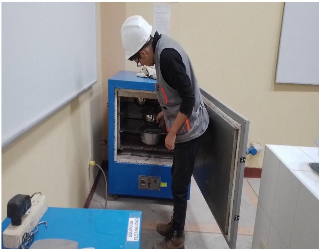
Fotografía N°12: obtención de resultados de las muestras secado en el horno.
