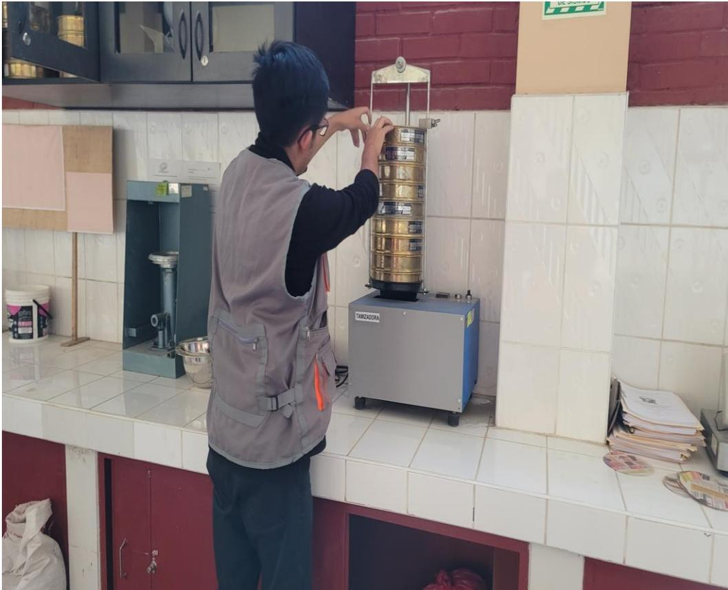
Fotografía N°02: Análisis granulométrico de agregados finos y gruesos.
