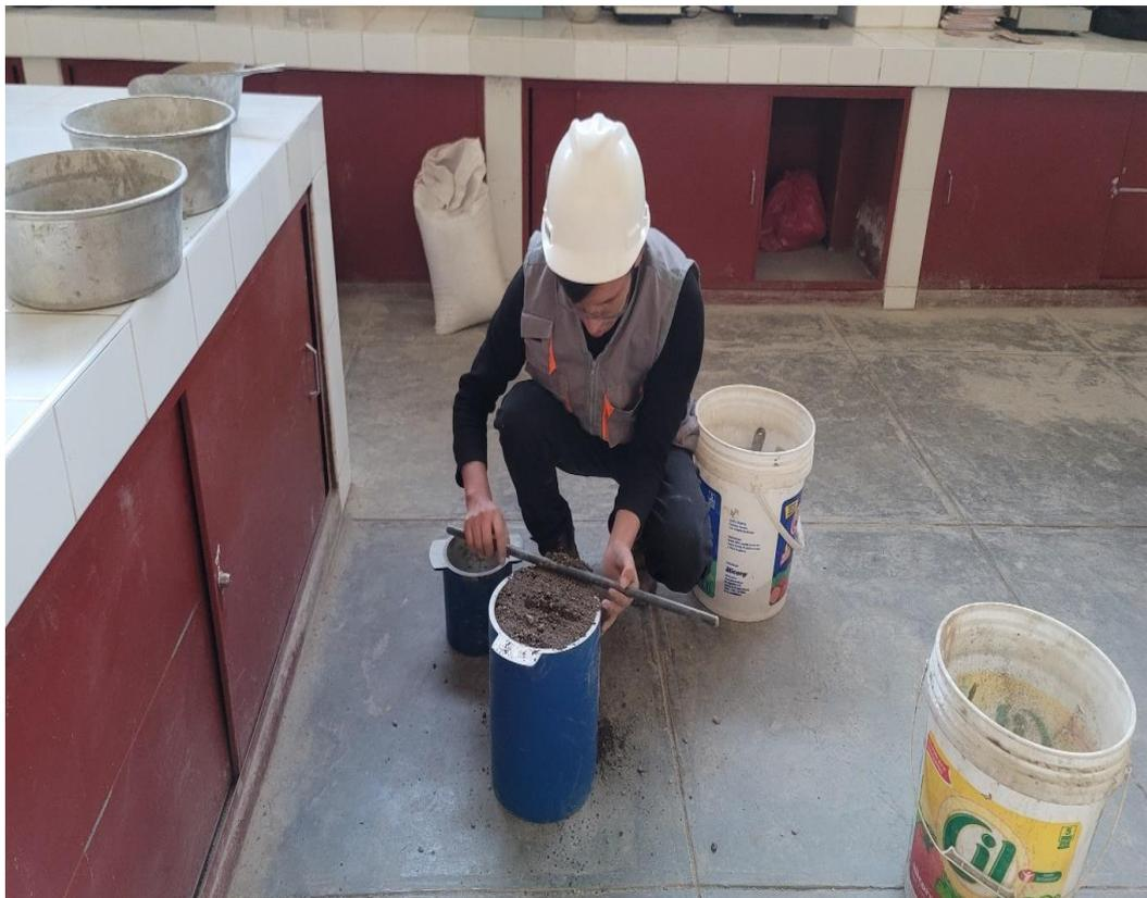
Fotografía N°08: Peso unitario compactado de los agregados finos y gruesos.
