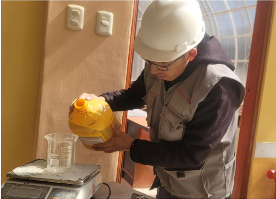
Fotografía N°27: Dosificación de aditivo incorporador de aire para diseño de mezcla.
