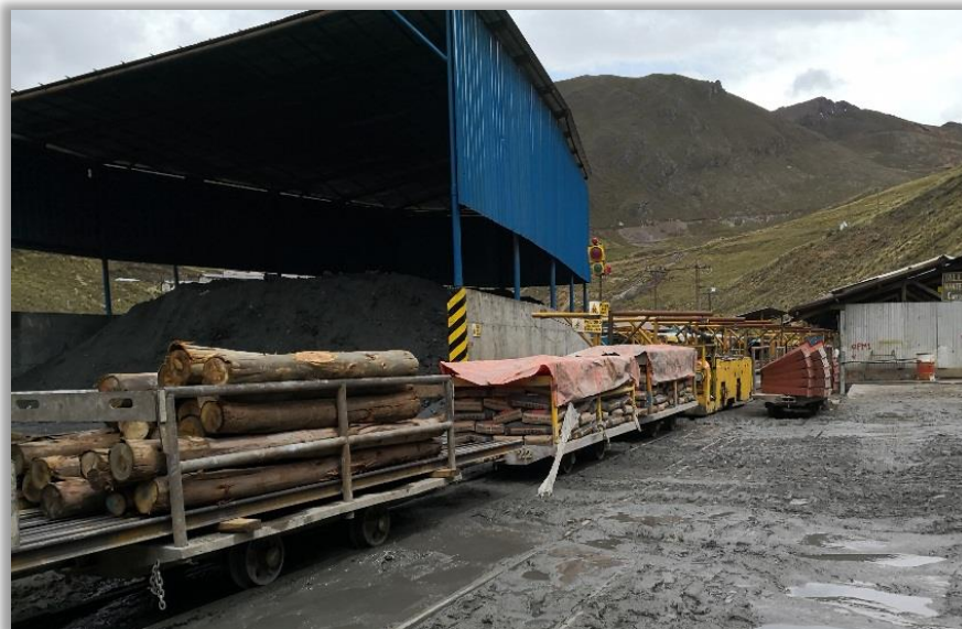
Figura 40. Transporte de Madera y Cemento Mediante Plataformas al Interior Mina.
