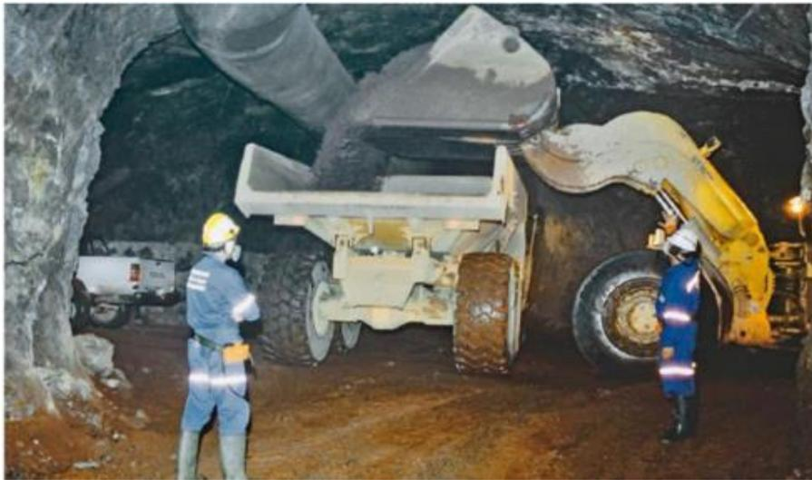
**Relleno;** El relleno se ejecutará por la galería superior y si es necesario se realizarán otras labores desde la rampa operativa para acelerar el relleno necesario para que este sirva como nuevo piso para proseguir con la ejecución de los taladros largos si hubiera ya preparado un nivel o piso superior
