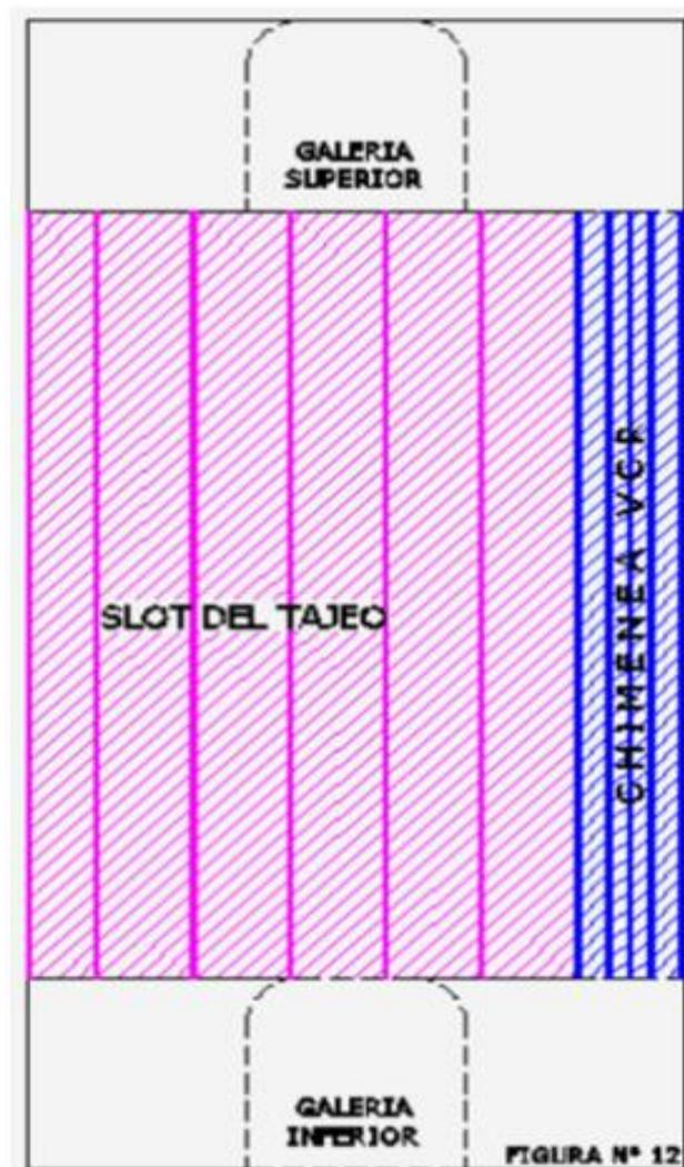
**Explotación;** Se inicia con la cara libre en el extremo de la galería preparada previamente con una sección de 2.0x2.0 m., para luego continuar con la perforación con una distribución de taladros que dependerá de la evaluación geomecánica previa, la potencia de veta y la inclinación de la misma.
