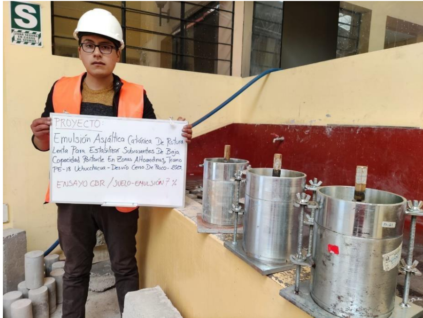
Moldes antes del Proceso de Saturación - Ensayo CBR/ Suelo + Emulsión Asfáltica 7 %
