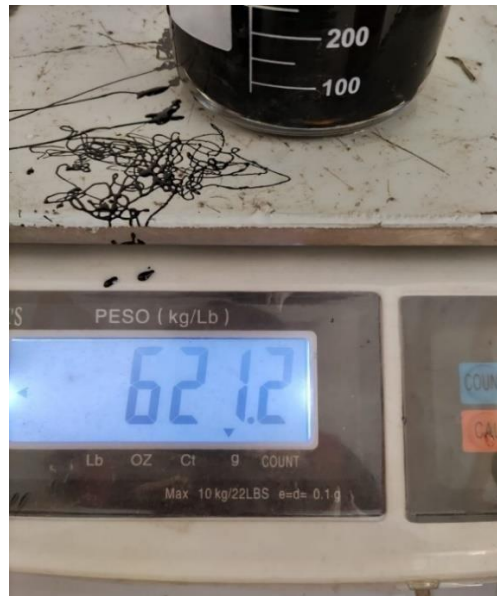
Figura 23 Peso de Emulsión asfáltica al 11% Fuente
