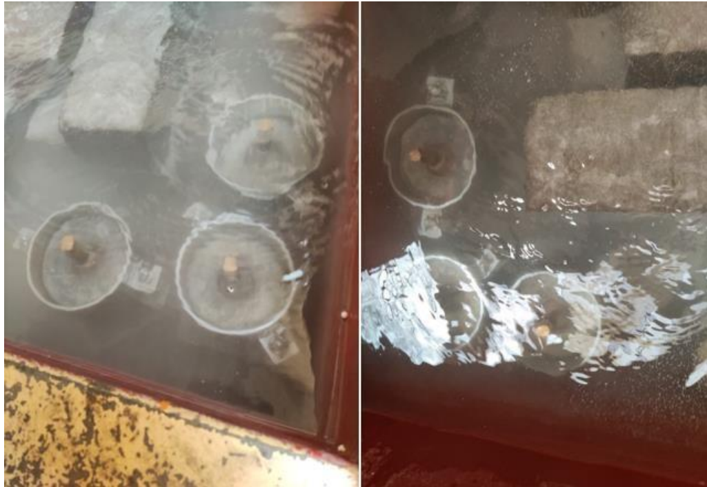
Moldes Sumergidos en agua por 4 días – Condición más crítica/ Suelo – Emulsión Saturada 3 %
