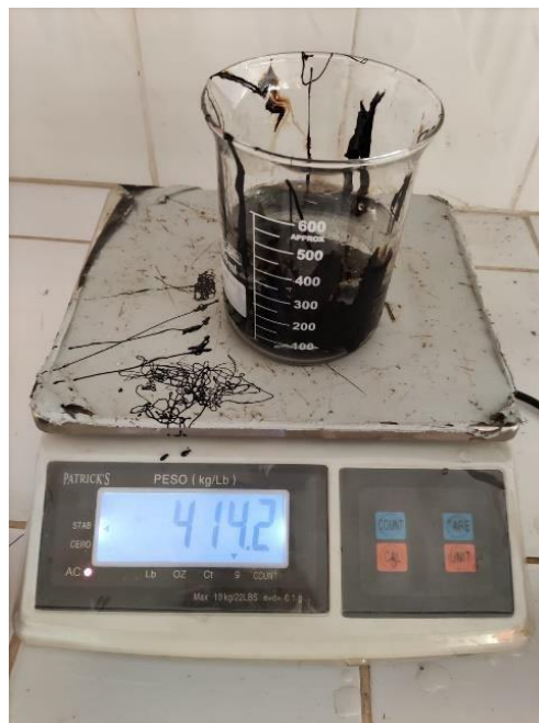
Figura 22 Peso de Emulsión asfáltica al 7%.
