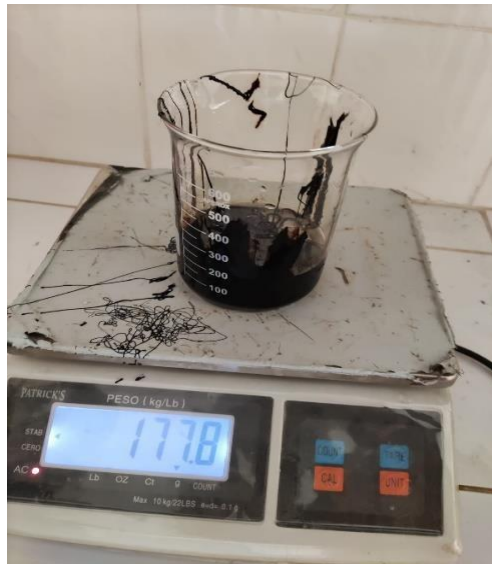
Figura 21 Peso de Emulsión asfáltica al 3%.
