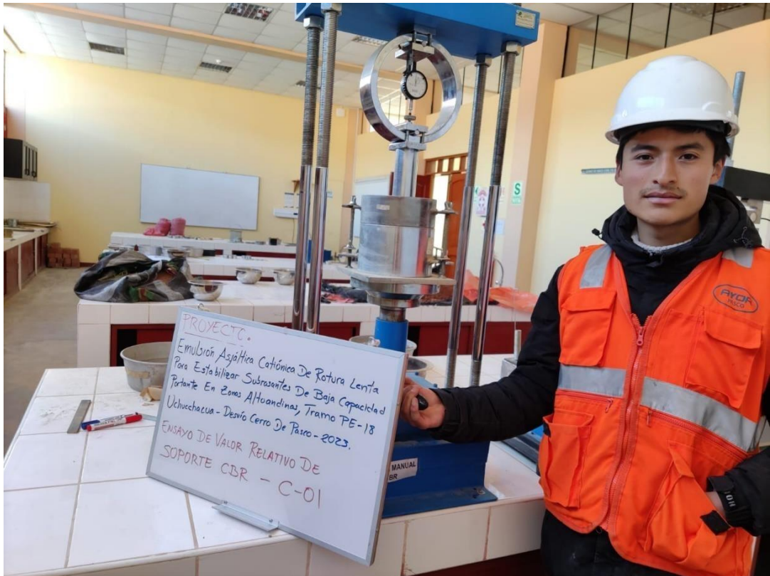
Ensayo de CBR a la muestra de la calicata N° 02
