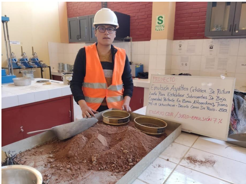
Muestra seleccionada para el Ensayo CBR/ Suelo + Emulsión 7%
