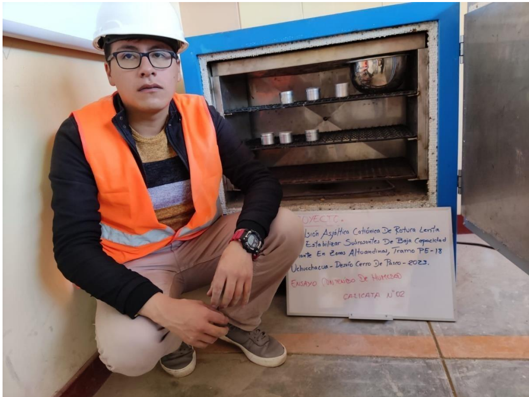
Se seca la muestra de la Calicata N° 02 en el horno
