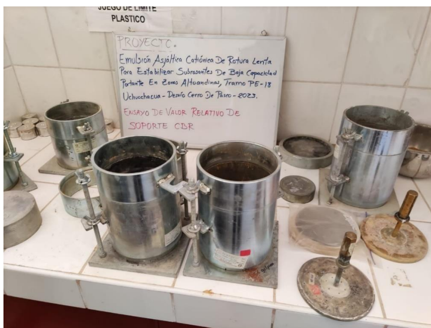
Figura 25 Preparación de los moldes para CBR Fuente: Elaboración Propia
