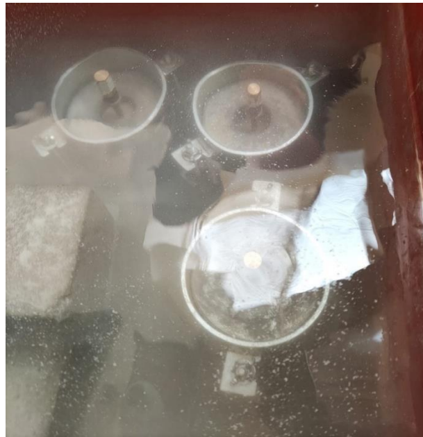
Figura 26 Moldes sumergidos en el agua para CBR de la mezcla Suelo – Emulsión
