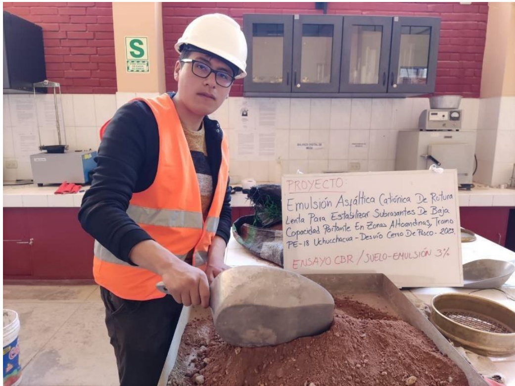
Muestra seleccionada para el Ensayo CBR/ Suelo + Emulsión 3%
