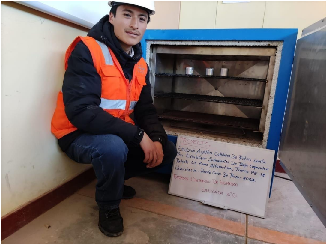
Se seca la muestra de la Calicata N° 01 en el horno
