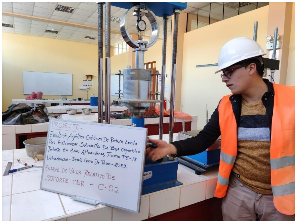
Ensayo de CBR a la muestra de la calicata N° 02
