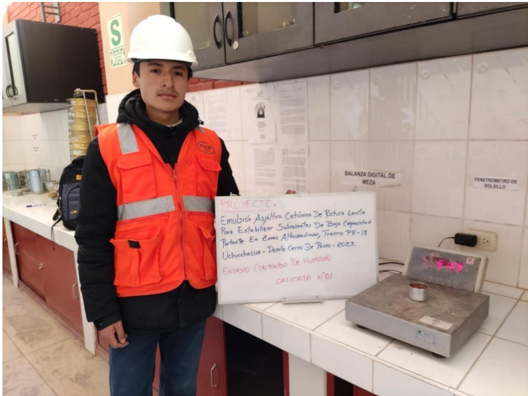
Peso del recipiente y la muestra saturada
