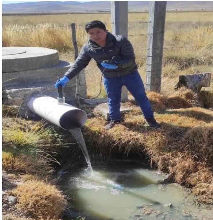
**Figura 16** Monitoreo a la salida de la laguna de oxidación-P-2
