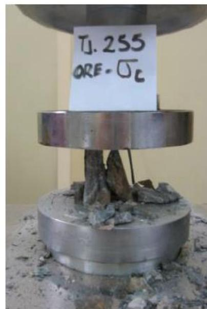
Ensayo de laboratorio para establecer la resistencia a la compresión uniaxial
