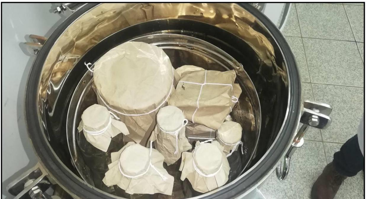
**FOTO 003:** Vista de material esterilizado con el uso del autoclave
