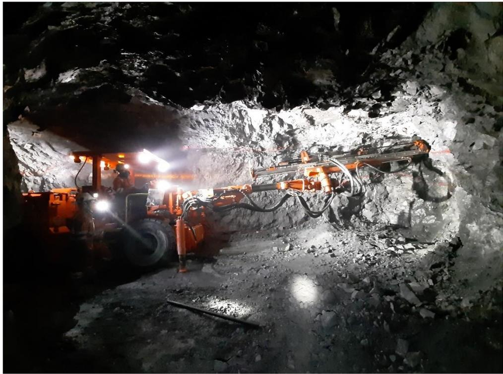
Foto N° 14. Perforación de frente con perforadora frontonera Jumbo.
