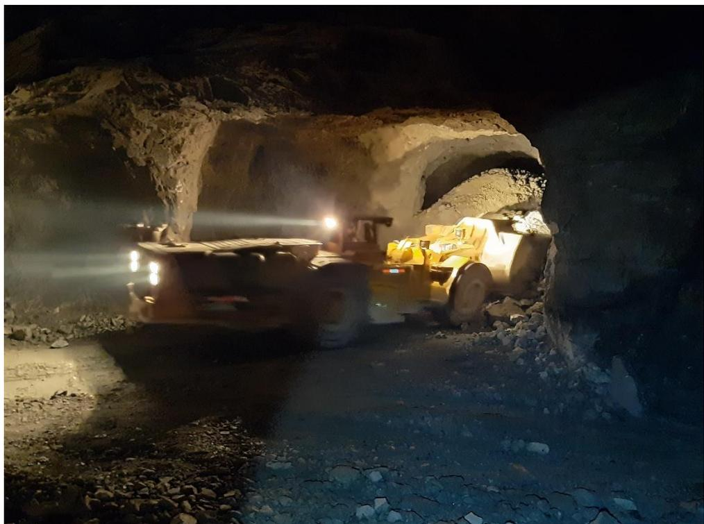
Foto N° 15. Acarreo de mineral con cargador frontal Scoop en mina coturcan.
