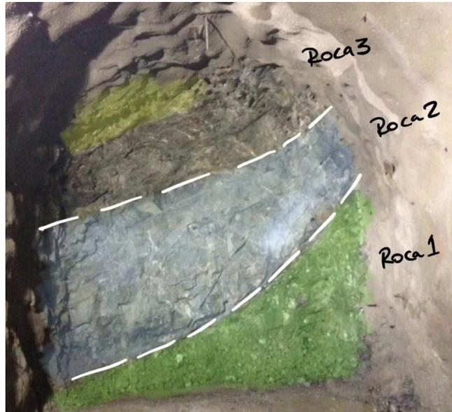
Figura N° 02. Frente de una labor identificada geológicamente. Fuente: Luis Ayala. Explorock Soluciones Geológicas.
