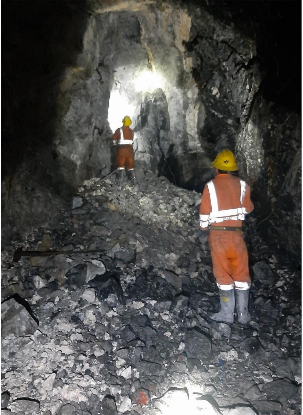
Foto N° 03. Mineros realizando desate de rocas en GL-0340(veta Coturcán techo) Mina Coturcán. Foto tomada por el tesista
