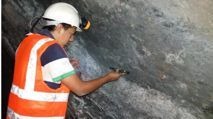
Figura N° 03. Medición del rumbo y buzamiento de un plano de falla. Fuente: Luis Ayala. Explorock Soluciones Geológicas.
