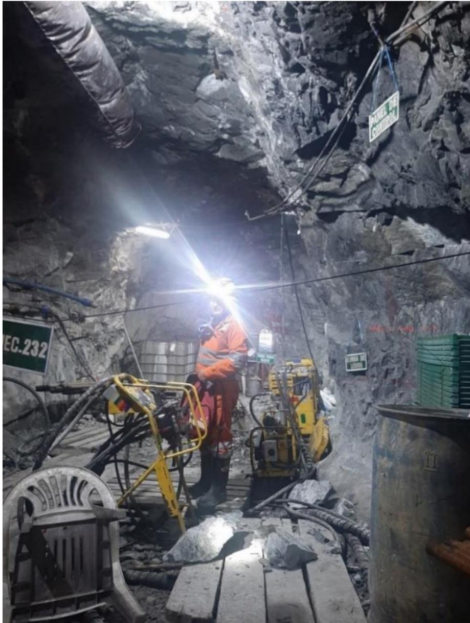
Foto N° 01. Diamec 232 en la cámara DDH-FR-6 en la mina Coturcán.
