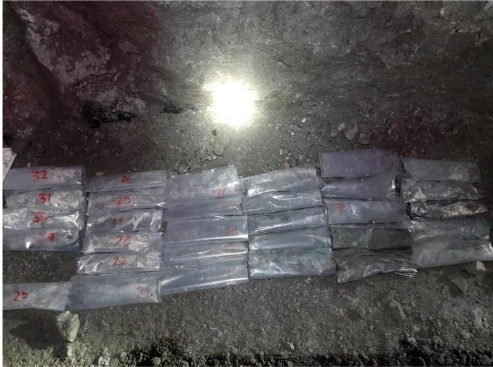
Foto N° 05. Muestreo contenido en bolsas enumeradas, empaquetadas para evitar contaminación y confusión de muestras.
