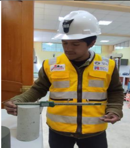
Toma de medidas de los testigos de concreto.
