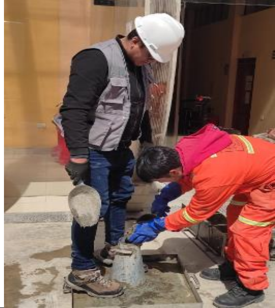
Proceso de chuseado en los testigos.
