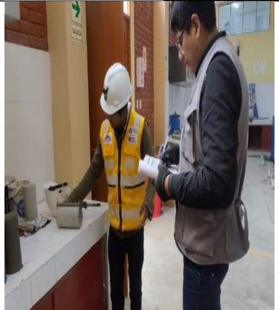
Toma de medidas de los testigos de concreto.
