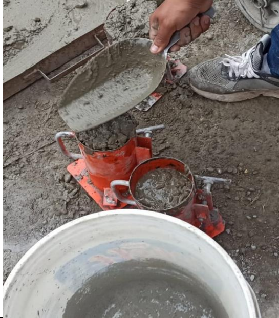
Colocación de concreto en los moldes, realizado en tres capas y chuseado 25 veces según norma.
