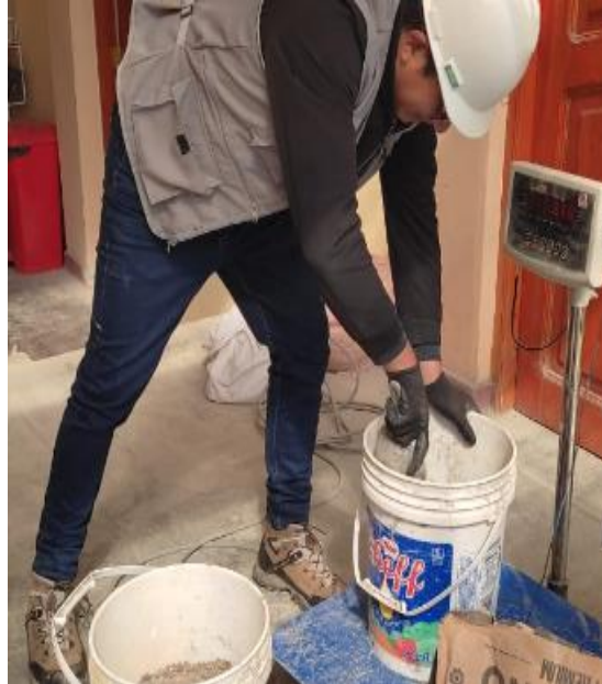
Cálculo y peso del agregado grueso, agua y cemento, según el diseño de mezcla.
