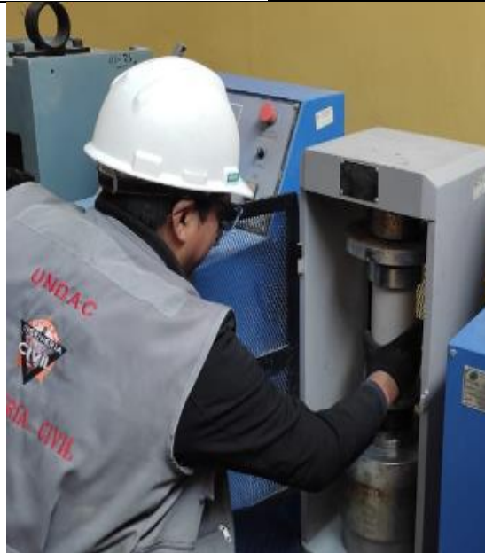
Se aprecia el ensayo a Compresión de los testigos de concreto.
