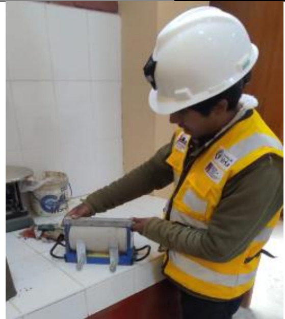
Se aprecia el ensayo a Tracción de los testigos de concreto.
