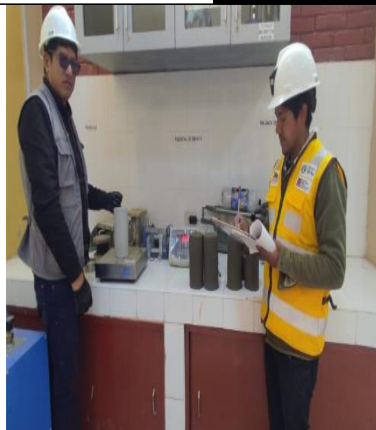
Toma de pesos de los testigos de concreto para después realizar su ensayo correspondiente.
