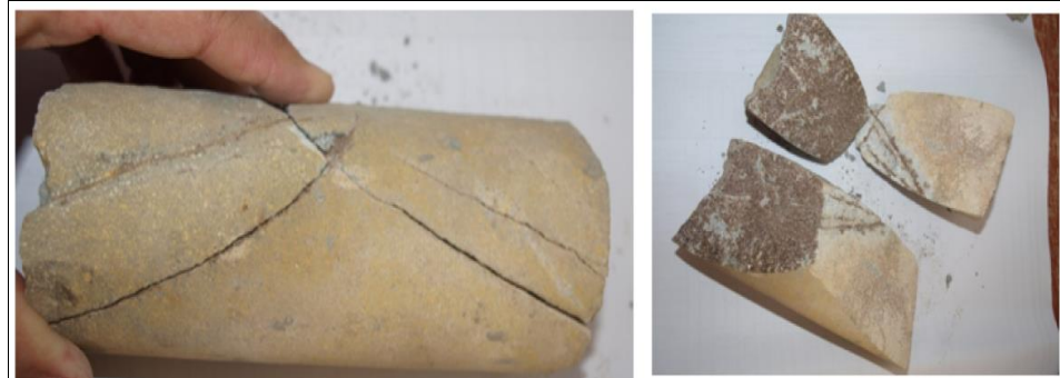
Figura 28 a: El micro-fracturamiento reduce la resistencia de la roca para R3. Se observa que el golpe del martillo rompe la roca en varios segmentos
