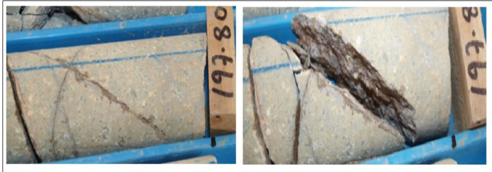
Figura 28 b: La roca es más resistente y el relleno en los micro-fracturas es fuerte. La roca no se rompe durante la perforación, indicando un R4.
