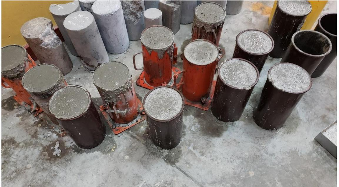
**Fotografía 23.-** Realización de probetas cilíndricas para ensayo a compresión
