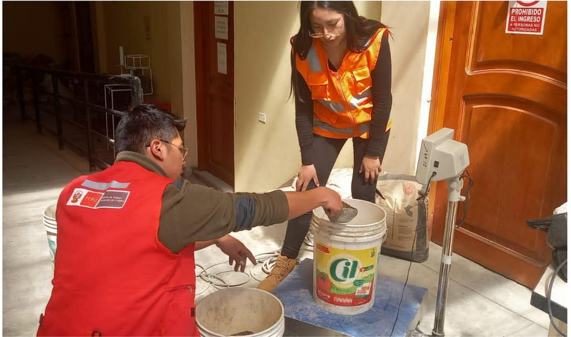
**Fotografía 13.-** Peso del agregado fino según el diseño de mezcla
