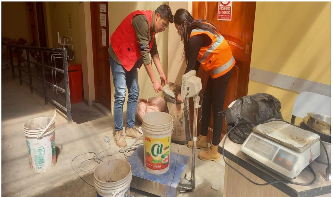
**Fotografía 14.-** Peso del cemento según el diseño de mezcla
