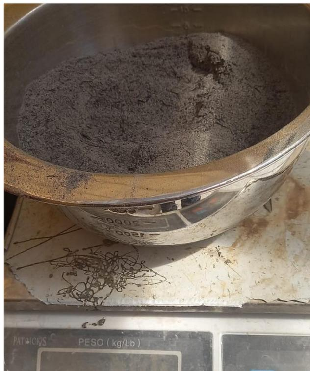
**Fotografía 16.-** Pesando el RHA según el diseño de mezcla
