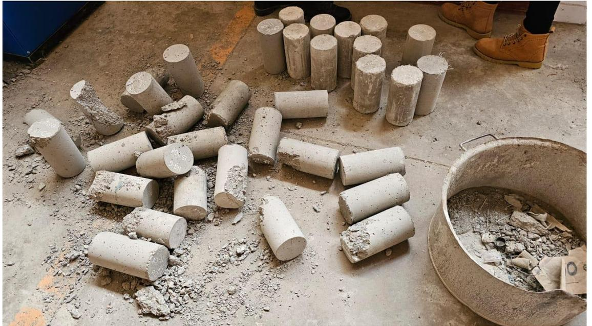
**Fotografía 31.-** Residuos de rotura a compresión y tracción indirecta de las probetas
