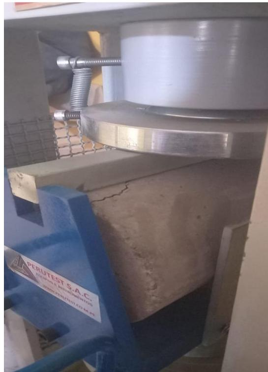
**Fotografía 28.-** Ensayo a tracción indirecta – Probeta en el equipo
