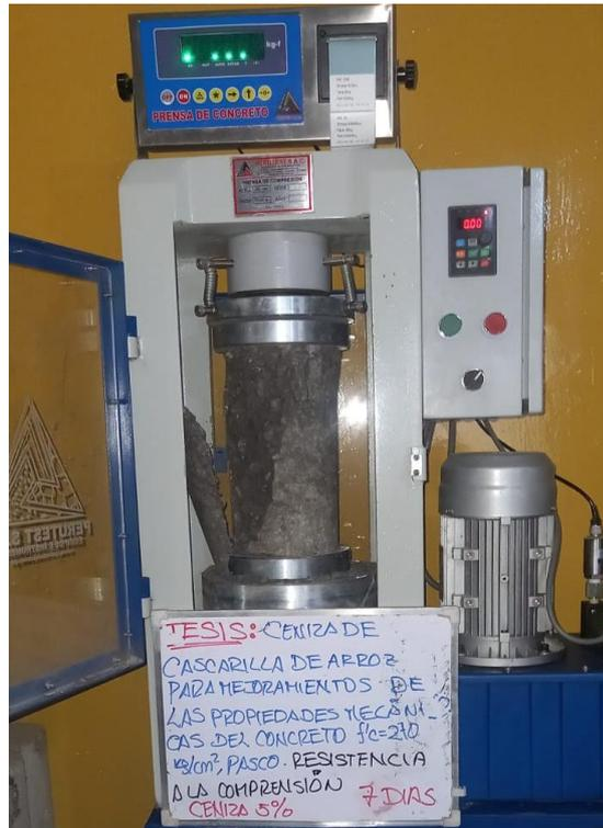
**Fotografía 25.-** Ensayo a compresión a los 7 días con 5% de RHA
