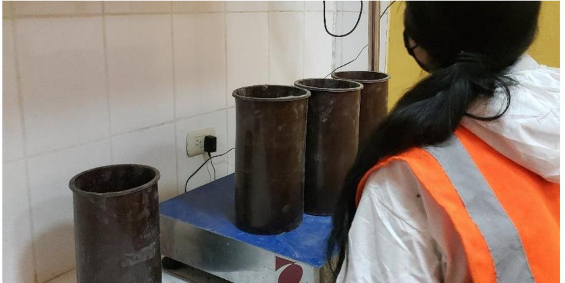
**Fotografía 21.-** Preparación y embadurnado con desmoldante de las probetas
