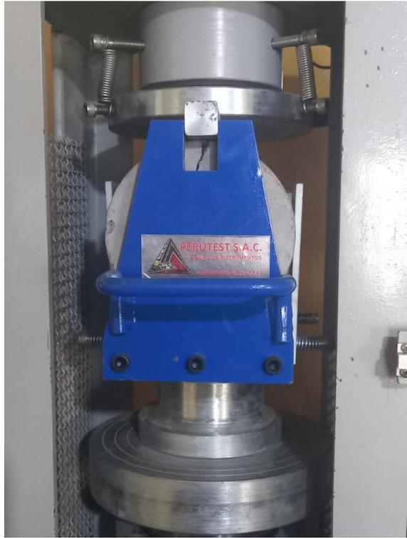
**Fotografía 29.-** Ensayo a tracción indirecta – Compresión diametral
