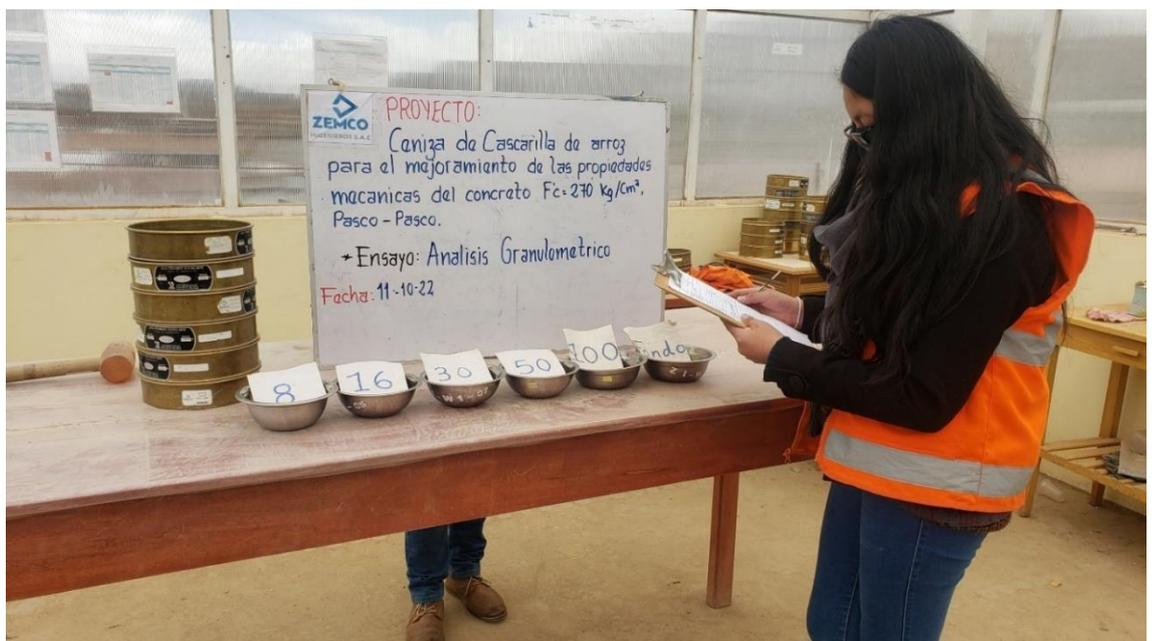
Fotografía 10.- Realización del ensayo granulométrico de la muestra
