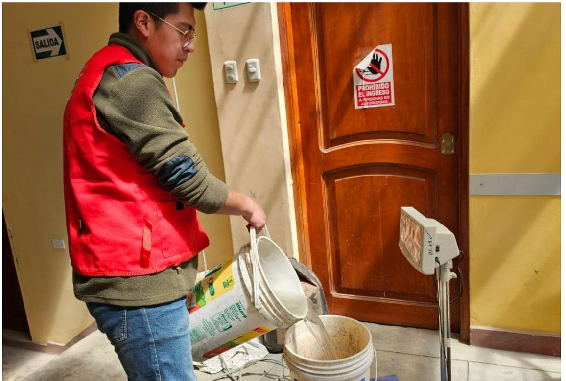
**Fotografía 20.-** Pesando el agua según el diseño de mezcla
