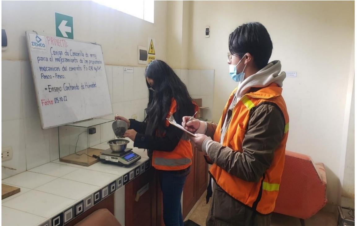
**Fotografía 3.-** Ensayo de contenido de humedad del RHA
