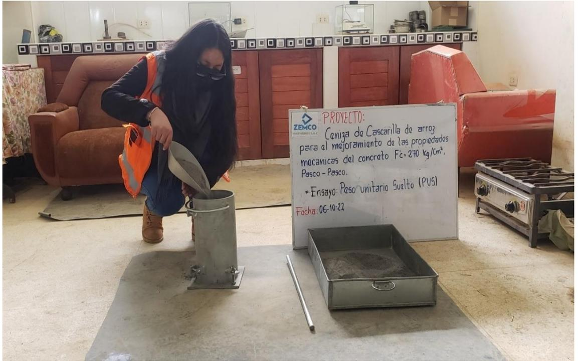
**Fotografía 5.-** Ensayo de peso unitario suelto
