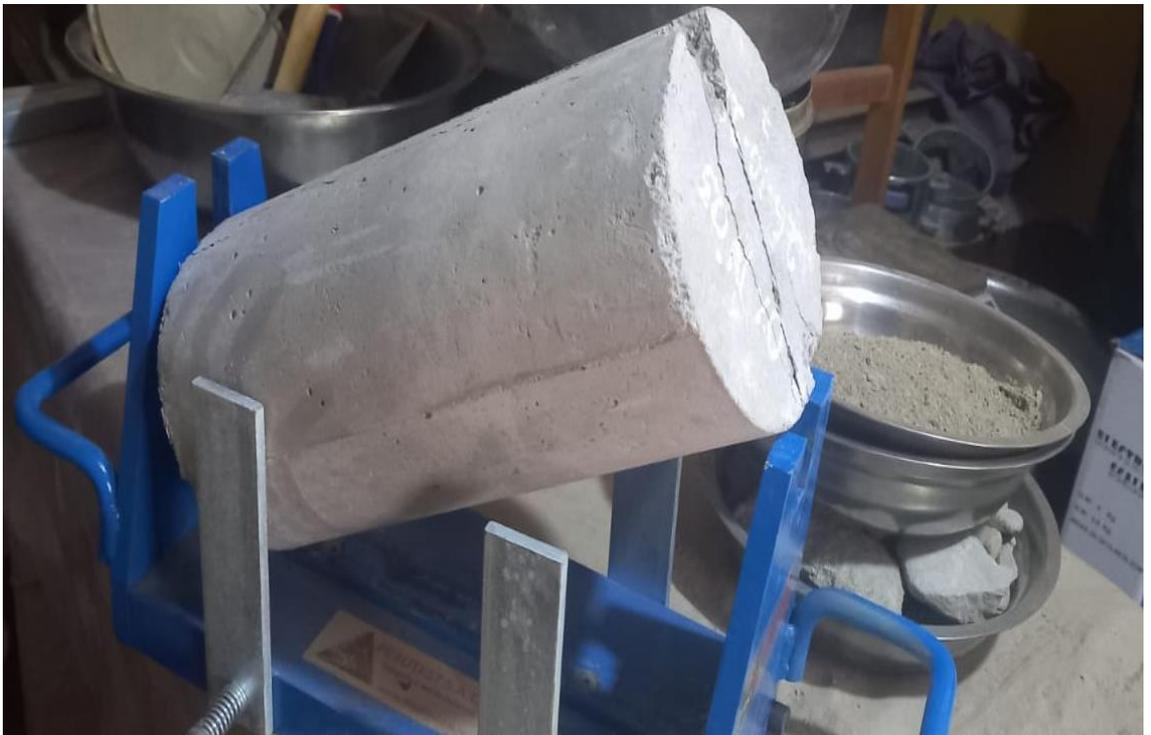
**Fotografía 30.-** Falla obtenida del ensayo a tracción indirecta
