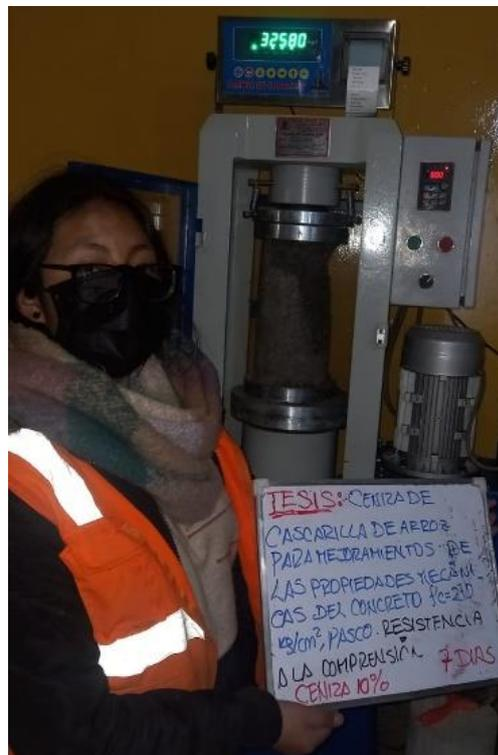
**Fotografía 26.-** Ensayo a compresión a los 7 días con 10% de RHA
