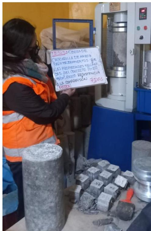
**Fotografía 24.-** Ensayo a compresión a los 7 días con 0% de RHA
