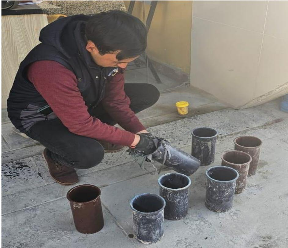
*Figura N°17: Limpieza de los moldes para la fabricación de las Probetas*
