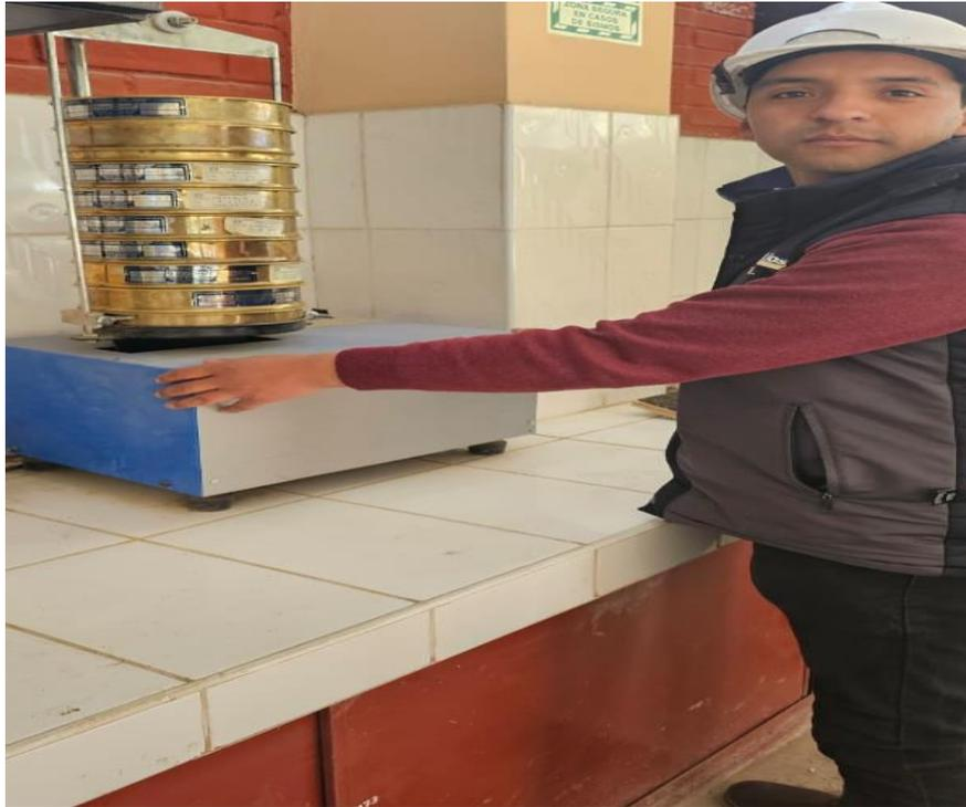
*Figura N°11: Colocación de los tamices para los ensayos de agregado finos y gruesos*
