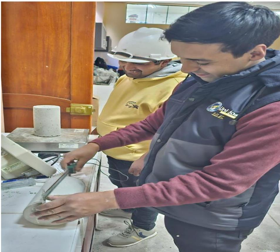
*Figura N°24: Medición de las dimensiones de la Briquetas de concreto*
