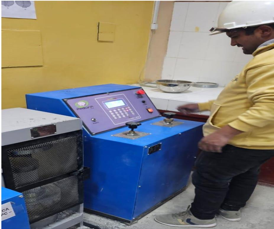
*Figura N°27: Briquetas Sometidos a compresión*
