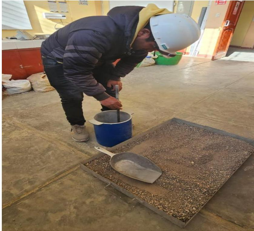
*Figura N°5: Compactación de Agregados*
