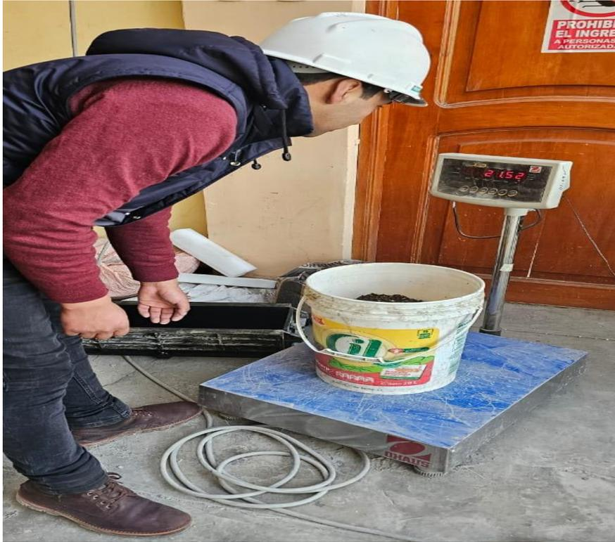
*Figura N°13: Peso del agregado grueso*
