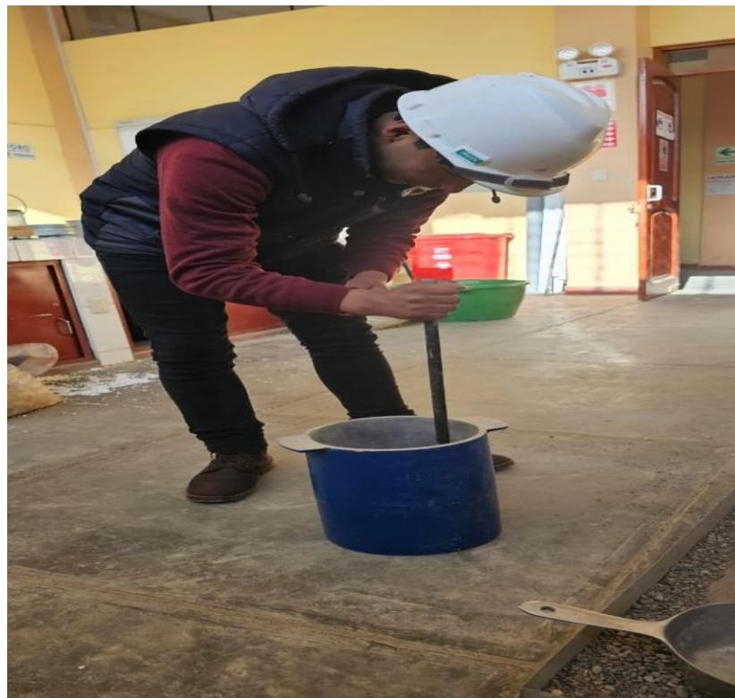
*Figura N°6: Compactación de Agregados*
