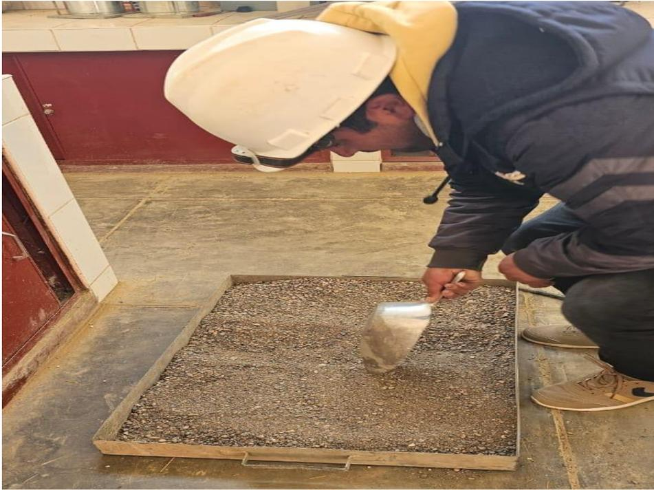
*Figura N°01: Cuarteo del agregado*
