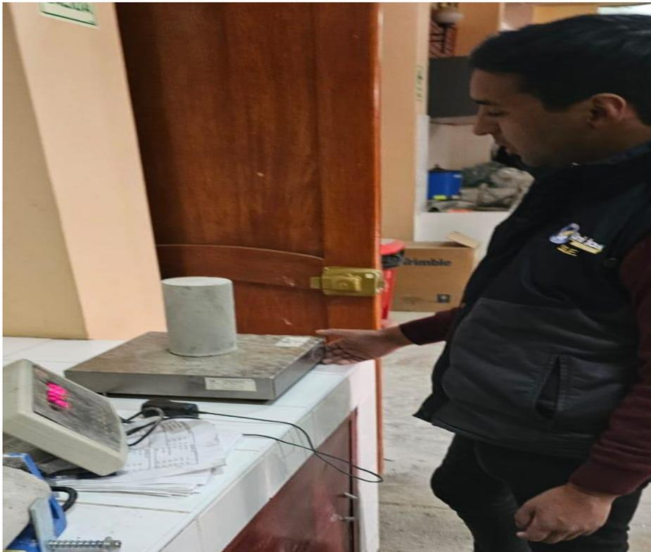
*Figura N°22: Peso de las briquetas*
