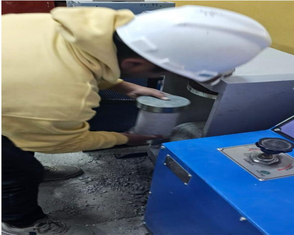
*Figura N°25: Colocación de las briquetas a la máquina de compresión*
