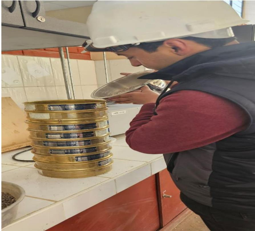
*Figura N°7: Llenado de Agregados para los respectivos ensayos*
