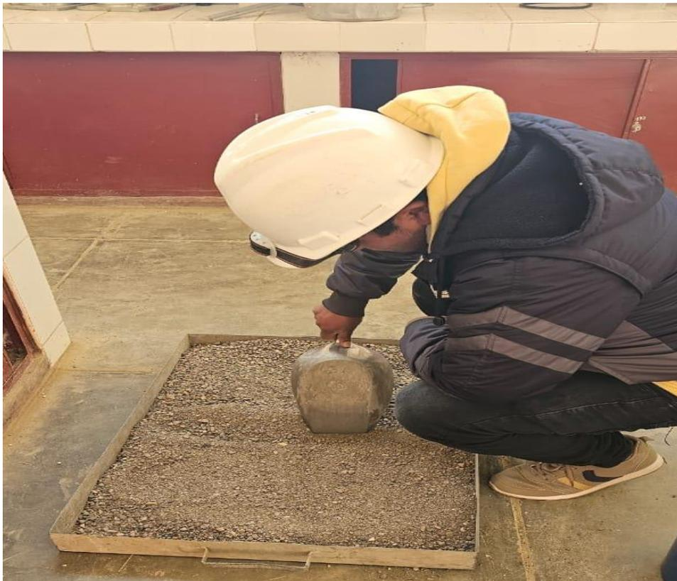
*Figura N°2: Cuarteo de Agregados*
