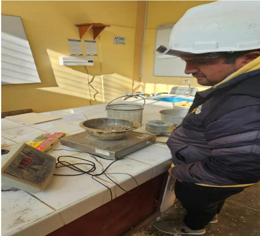
*Figura N°9: Peso del agregado*
