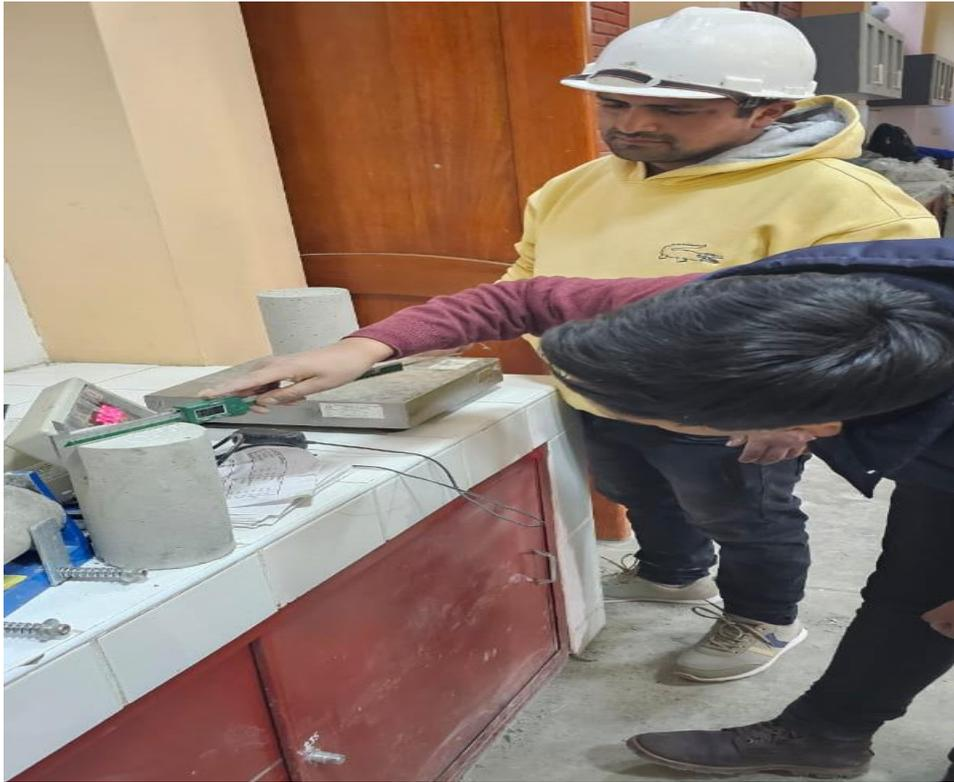
*Figura N°23: Medición de las dimensiones de la Briquetas de concreto*
