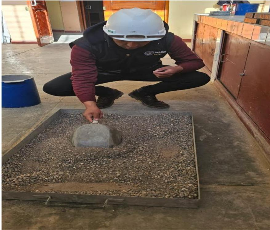
*Figura N°3: Cuarteo de Agregados*
