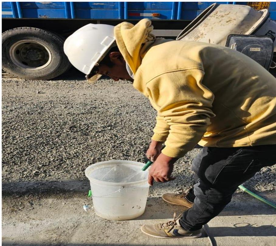
*Figura N°16: Llenado de agua para la fabricación de Briquetas*
