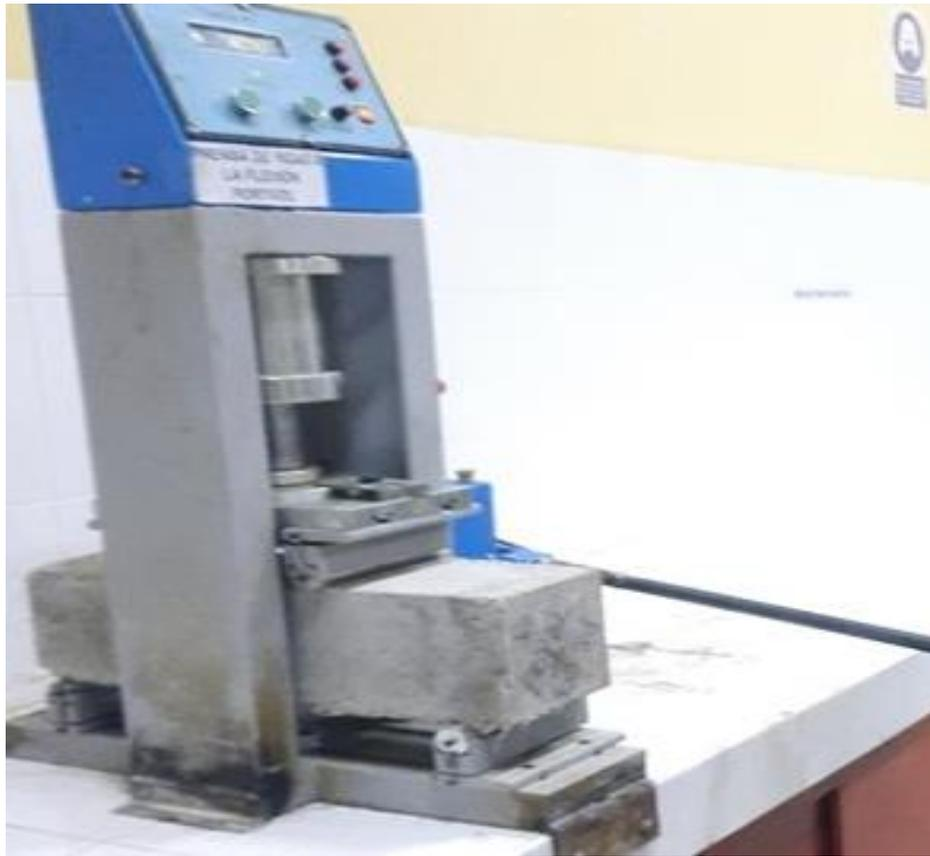
*Figura N°31: Ensayo de la resistencia a la flexión.*
