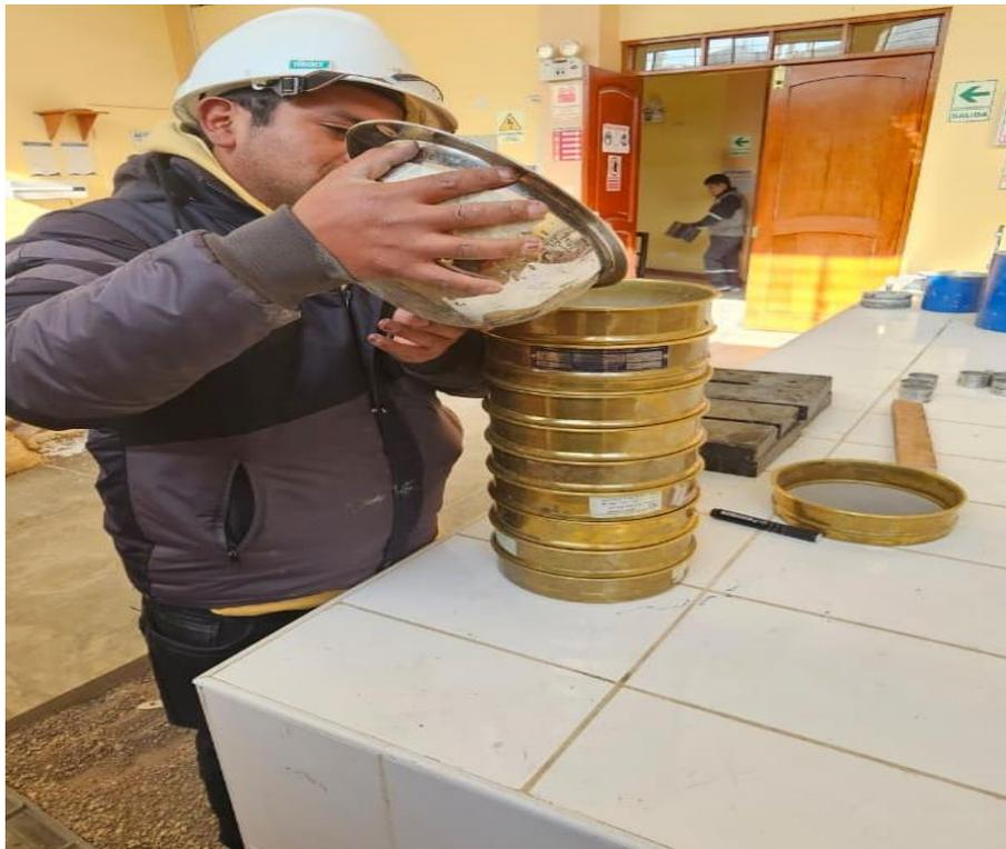
*Figura N°8: Llenado del agregado en los tamices*
