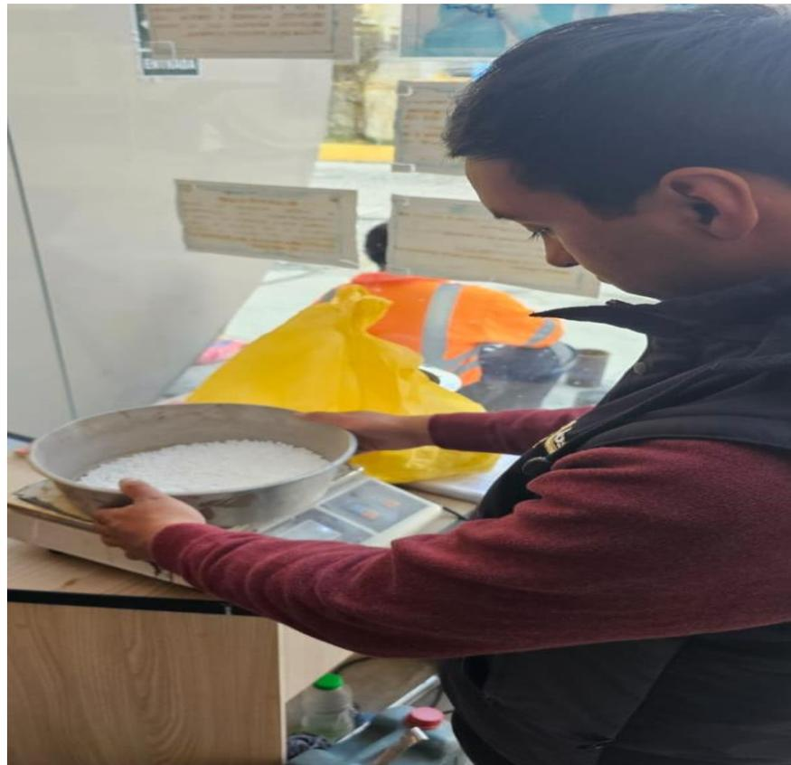
*Figura N°12: Peso de perlas de poliestireno expandido*
