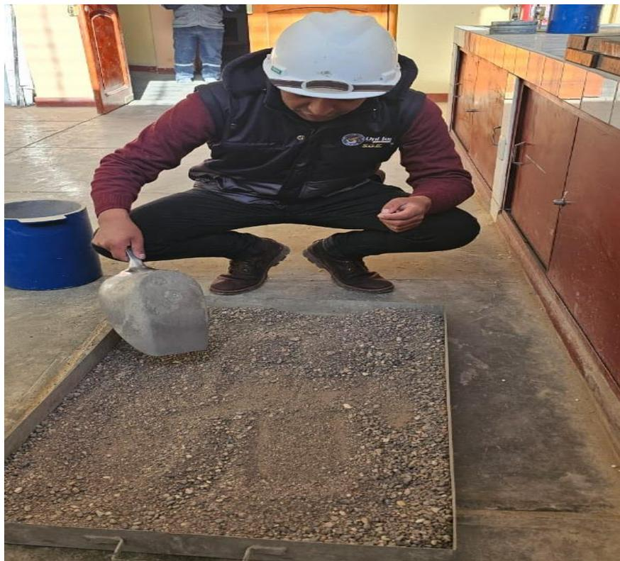
*Figura N°4: Cuarteo de agregados*
