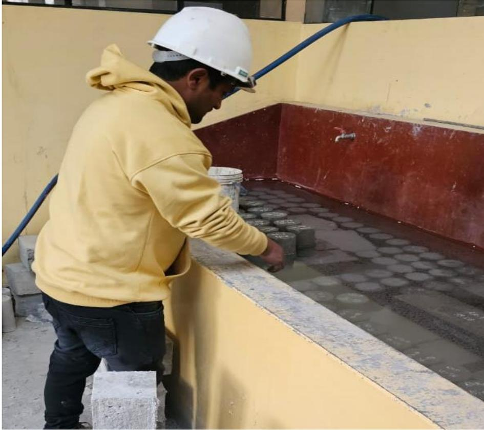
*Figura N°29: Pozo de curado*
