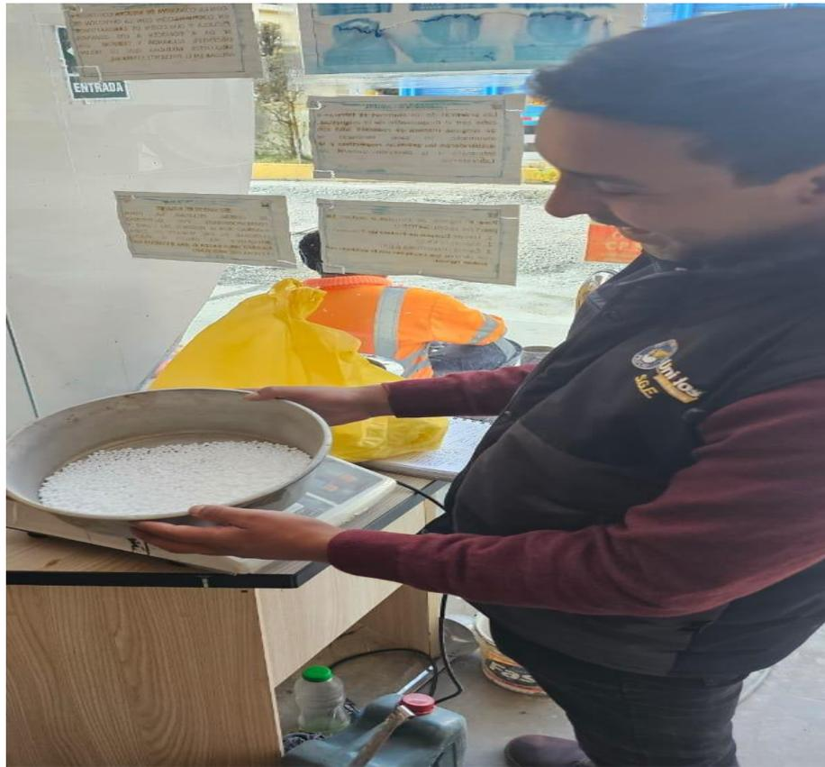
*Figura N°15: Peso de perlas de poliestireno expandido*
