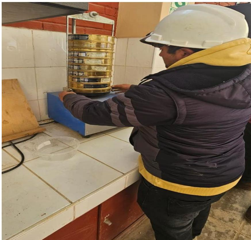
*Figura N°10: Colocación de los tamices para los ensayos de agregado finos y gruesos*
