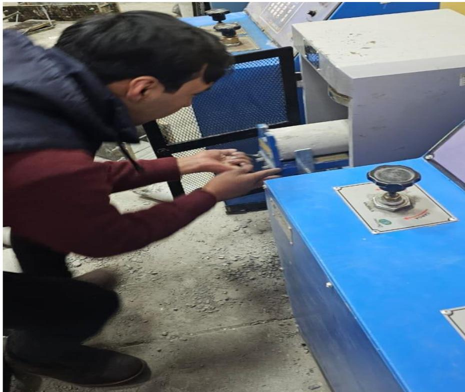
*Figura N°26: Colocación de las briquetas a la máquina de compresión*
