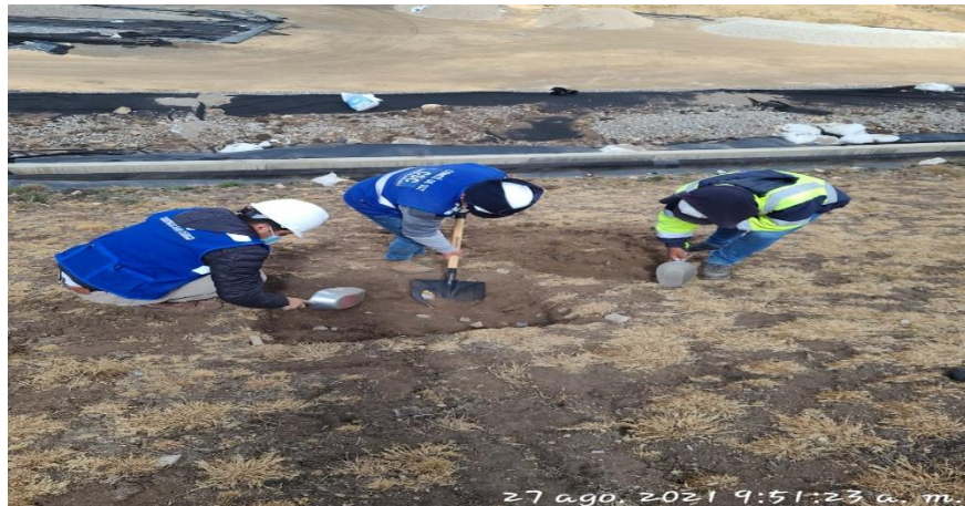
Fotografía 10: Verificación del volumen de top soil en piedra chancada
