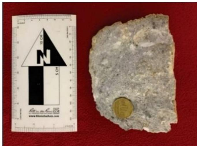
*Nota. Muestra de Cuarzo Monzonita – Monzonita, presenta una textura bimodal con fenocristales de plagioclasas y cuarzo. Tiene una coloración gris claro con tonalidades beige producto de la alteración Argílica débil, y con presencia de sulfuros hacia el piso del dique (Cerro S.A.C).*
