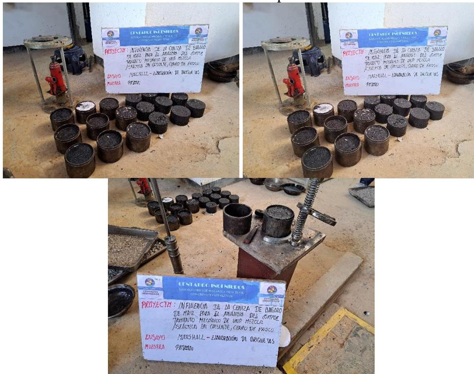
Foto 14. Ensayo Marshall
