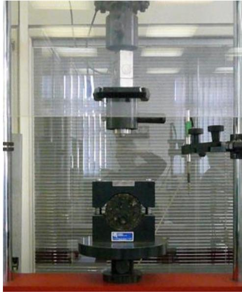
*Nota:* Tomado de “Método de prueba estándar para estabilidad Marshall y flujo de mezclas asfálticas ASMT D 6927”, por ASTM, 2015.
