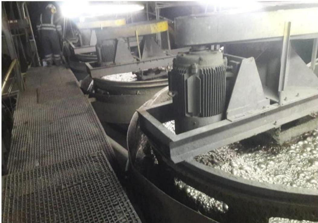
Fotografía 4. Flotación de cobre en las celdas serranas
