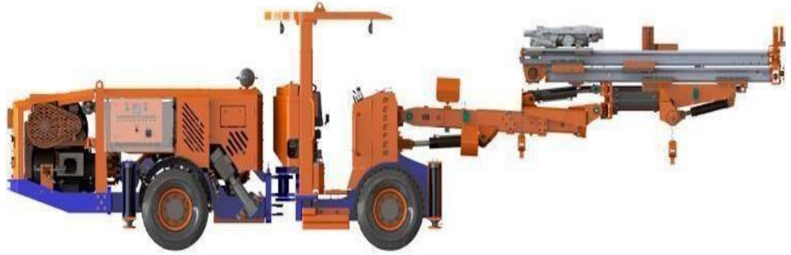
Figura 26. Triton DF-S16: Línea Resefer-Fuente: Resefer manufacturing.
