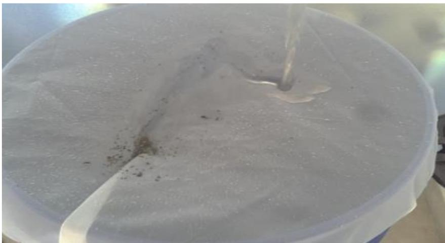
**En la siguiente imagen se muestra el proceso de vertimiento de la muestra de agua a la malla filtrante para posteriormente ser contabilizados la cantidad de organismos retenidos.
