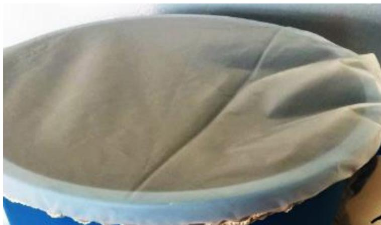
En la siguiente imagen se muestra un retazo de malla que es colocado en la boca del balde para filtrar las muestras
