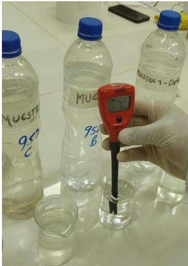
*Figura 8. Medición de pH a muestra de pileta*
