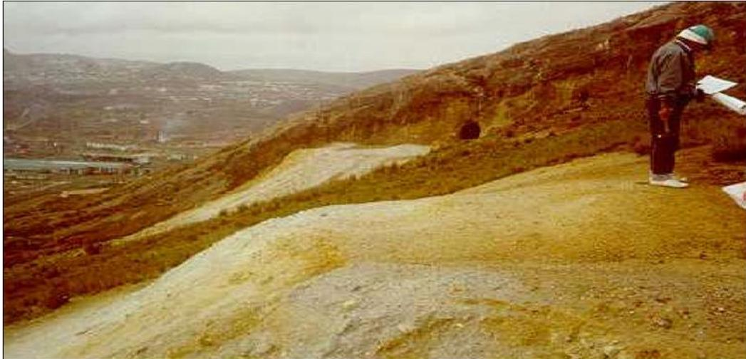
**Ilustración 1. Desmontes en bocamina Don Paco**
