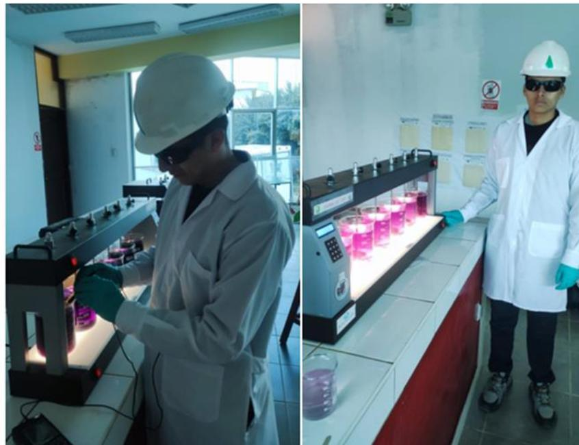
**Ilustración 10: Se aprecia el uso del equipo para las pruebas de Jarras en pleno funcionamiento**
