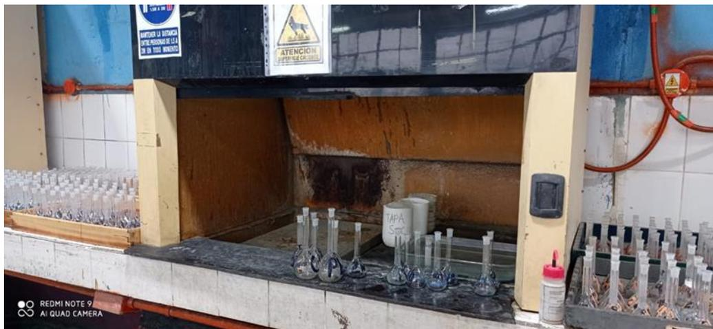
**Ilustración 5: Preparación de las muestras a través del ataque químico**
