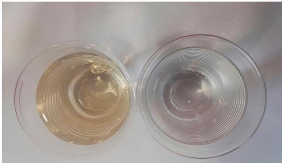
**Ilustración 2. Experimento. Aspecto del agua tras la ozonización y tras la filtración del manganeso: (ASP Asepsia)**
