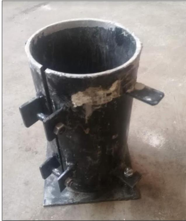
*Ilustración 10. Molde cilíndrico*
