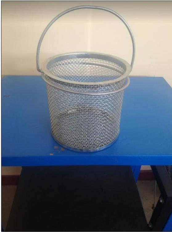
*Ilustración 12. Equipo para peso específico*
