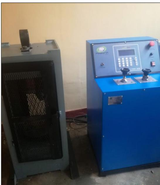
*Ilustración 17. Máquina compresora*
