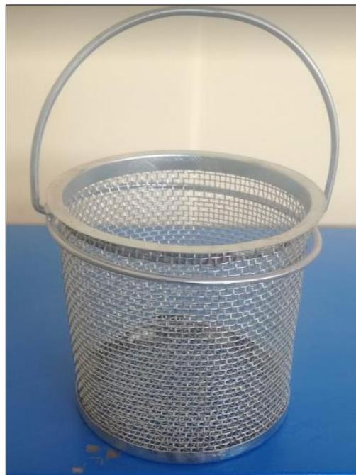
**Ilustración 15.** Cesta con malla de alambre con abertura correspondiente al tamiz N°. 4
