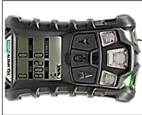
Gráfico N° 23. Detector de gases digital para medición en labores mineras. Fuente: Fotografía en el gabinete de Ventilación de Minas, Unida Minera Antapite.
