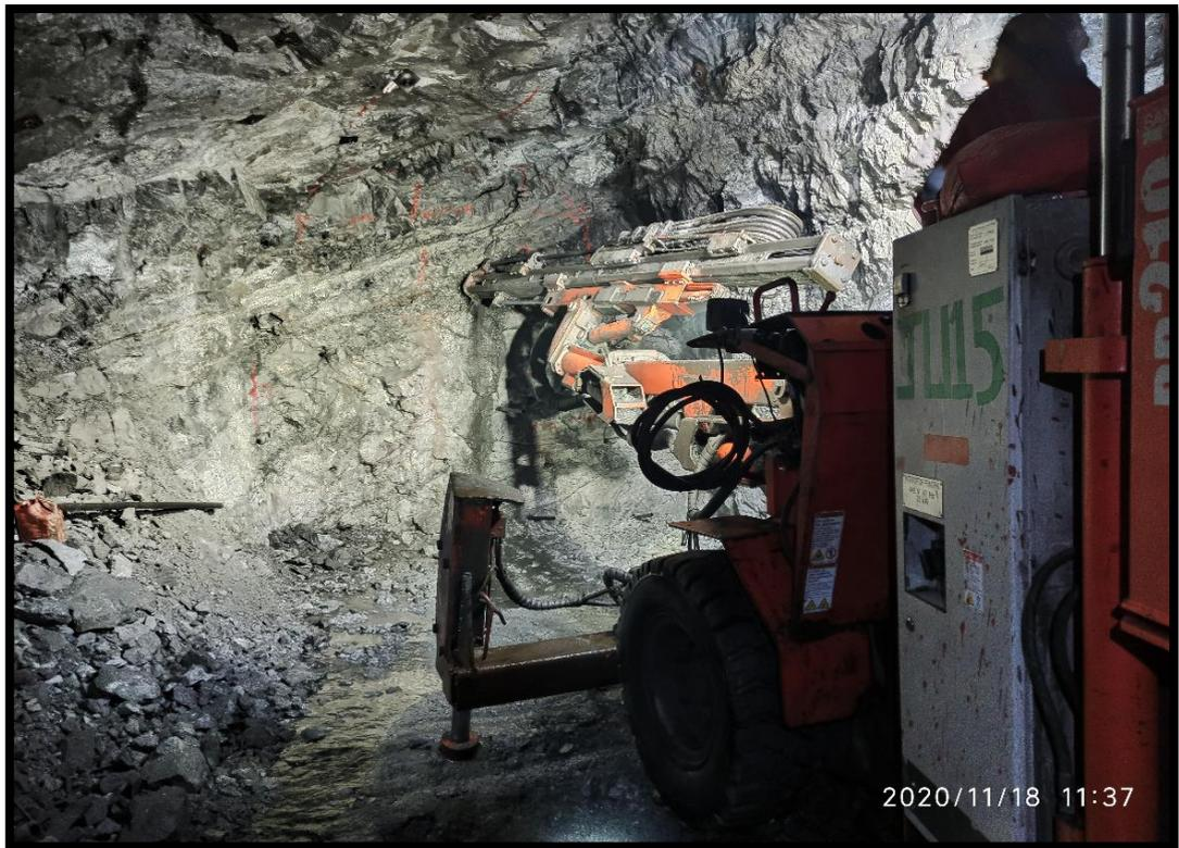
*Fotografía N°2: Cumplimiento de la malla de perforación según diseño, SN*
