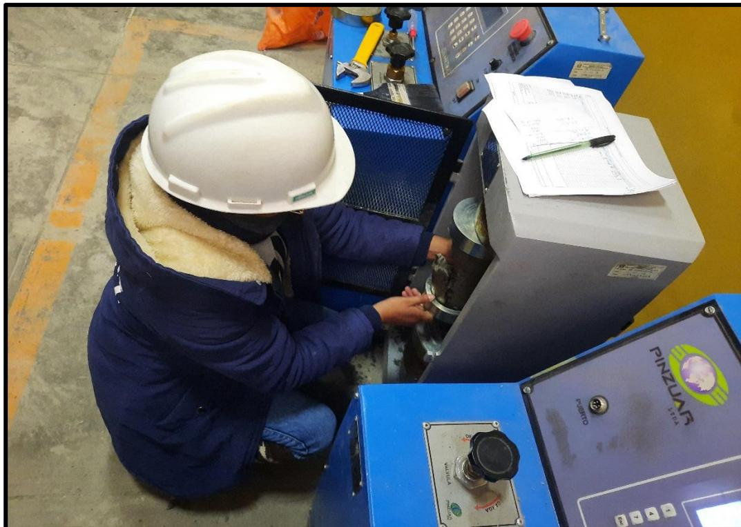
**Fotografía 22.** Rotura de las probetas de concreto para el ensayo de resistencia a la compresión.
