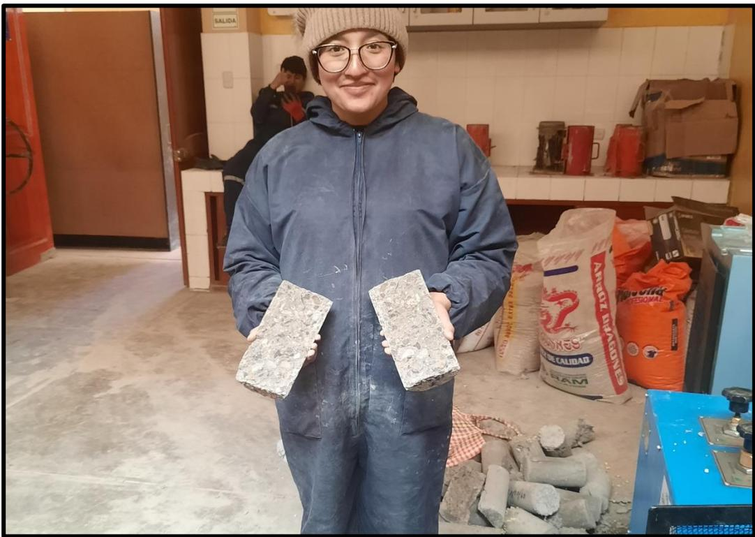
**Fotografía 26.** Rotura de las probetas de concreto para el ensayo de resistencia a la tracción del concreto con SP y FA.
