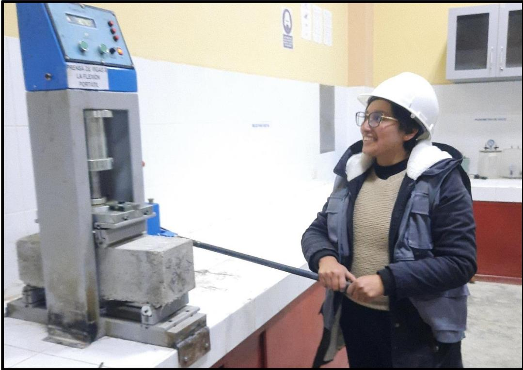
**Fotografía 27.** Rotura de la viga de concreto para el ensayo de resistencia a la flexión.
