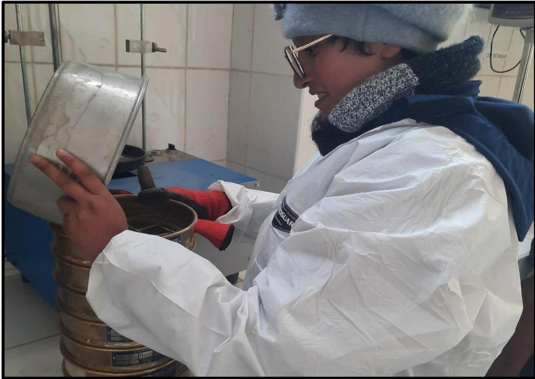
**Fotografía 5.** Ensayo para análisis granumétrica por tamizado del agregado grueso y fino.
