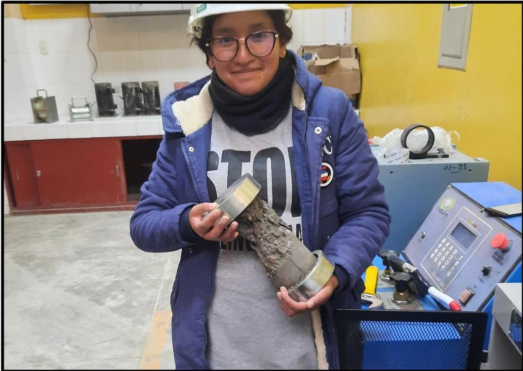
**Fotografía 23.** Rotura de las probetas de concreto para el ensayo de resistencia a la compresión del concreto con SP y FA.
