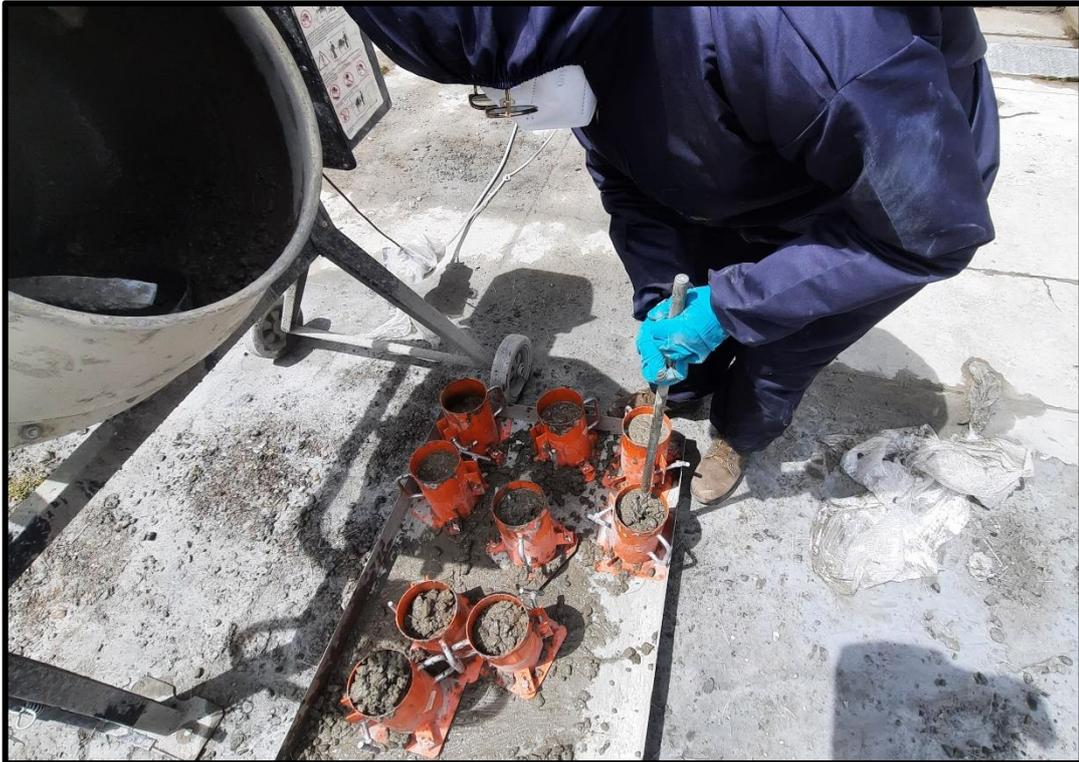
**Fotografía 17.** Llenado de las probetas del concreto convencional y el concreto con SP y FA.
