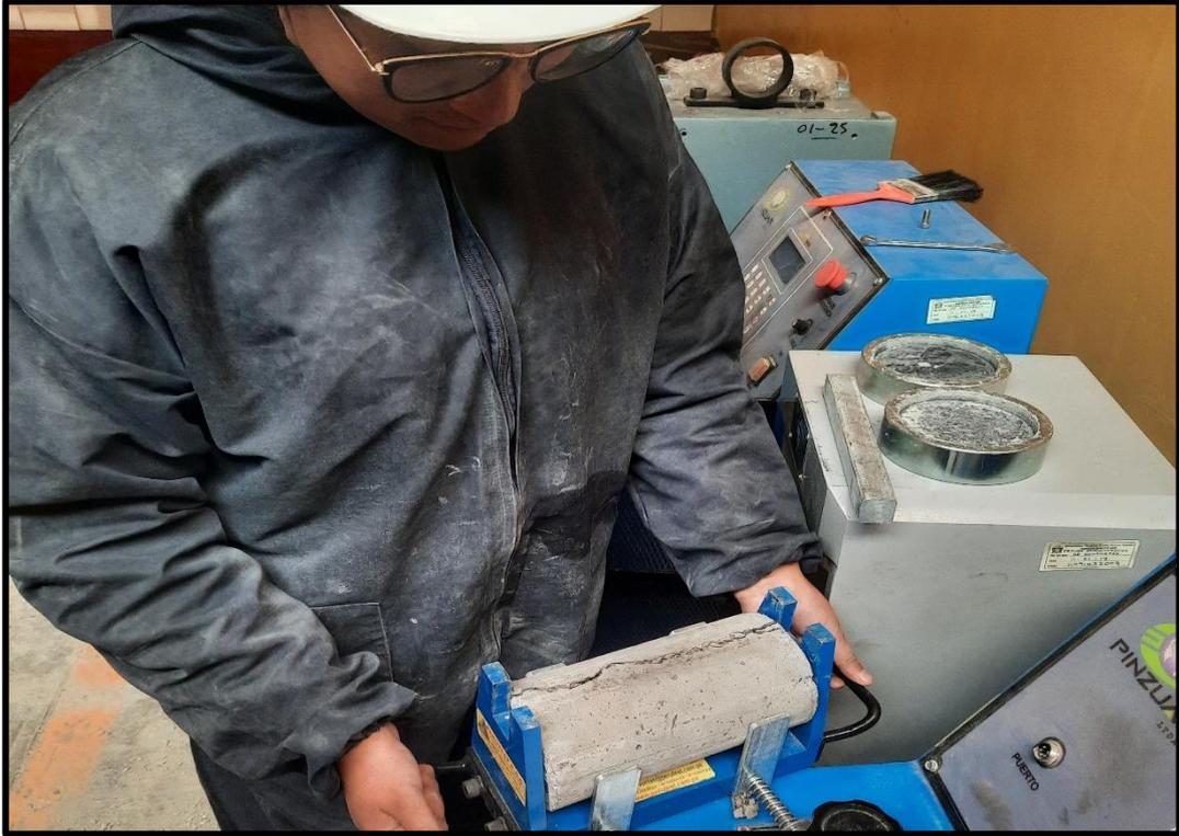
**Fotografía 25.** Rotura de las probetas de concreto para el ensayo de resistencia a la tracción del concreto con SP y FA.
