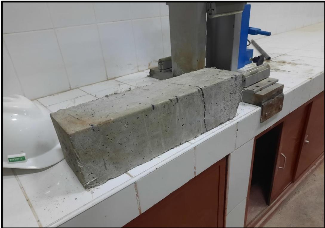
**Fotografía 28.** Fisura de la viga de concreto para el ensayo de resistencia a la flexión.
