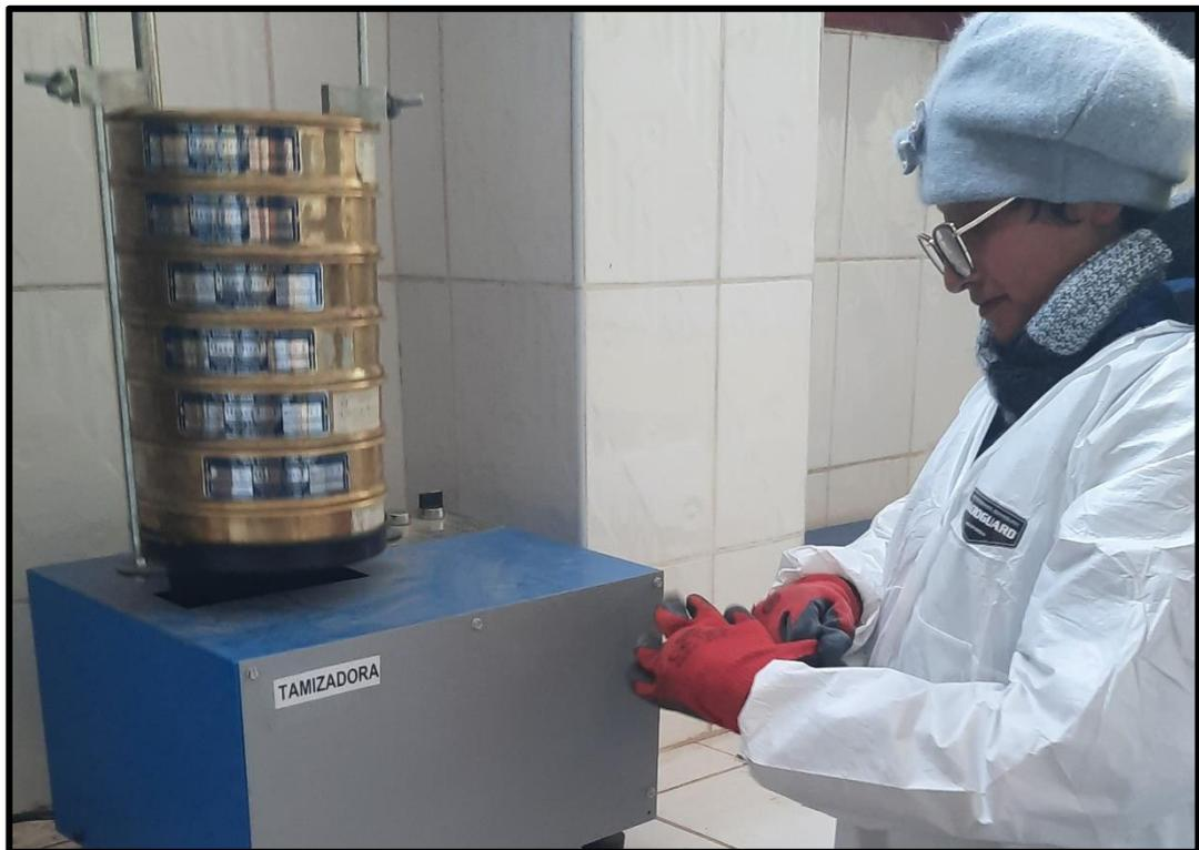
**Fotografía 6.** Ensayo para análisis granumétrica por tamizado del agregado grueso y fino en la tamizadora.
