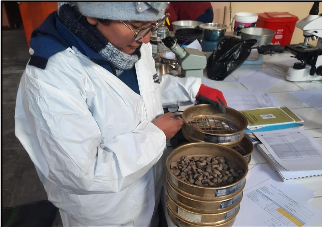
**Fotografía 7.** Peso de cada agregado retenido en cada tamiz del agregado grueso y fino.
