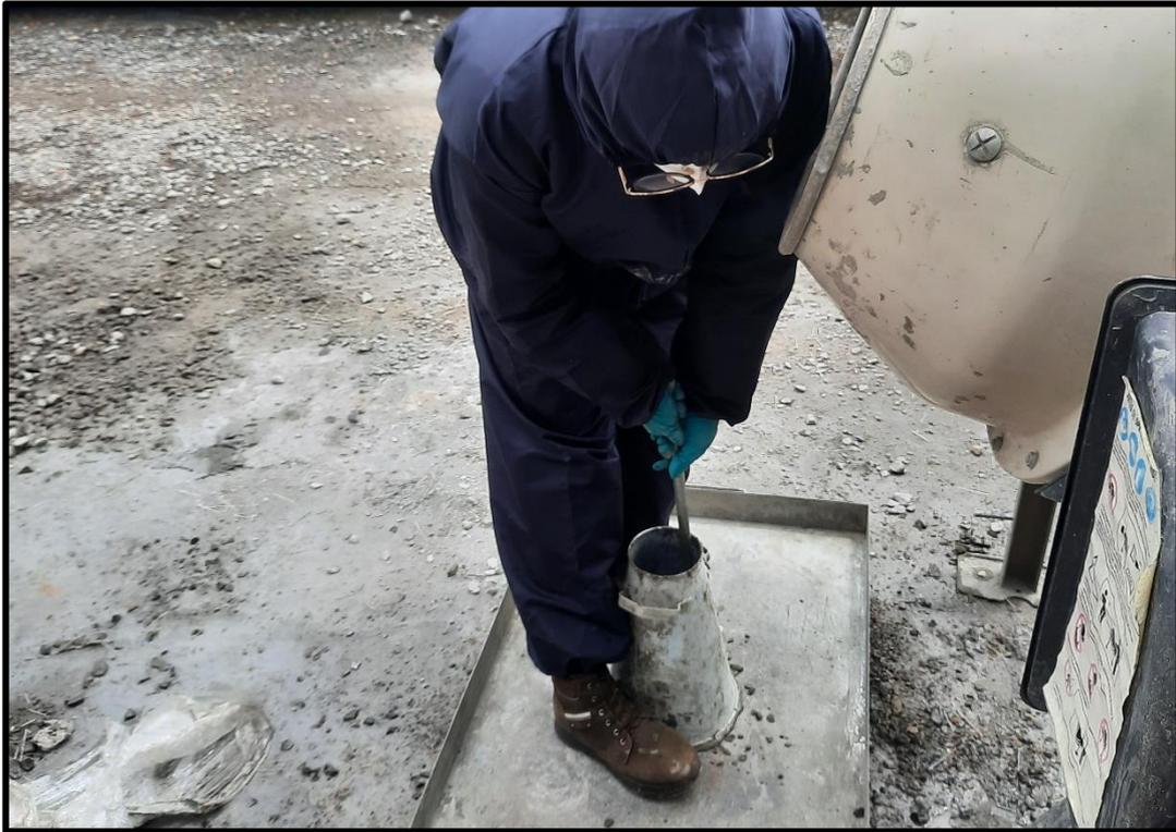
**Fotografía 13.** Chuseado para la prueba con el cono de Abrams para observar el asentamiento.
