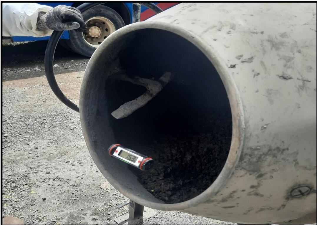
**Fotografía 16.** Medición de la temperatura del concreto fresco.
