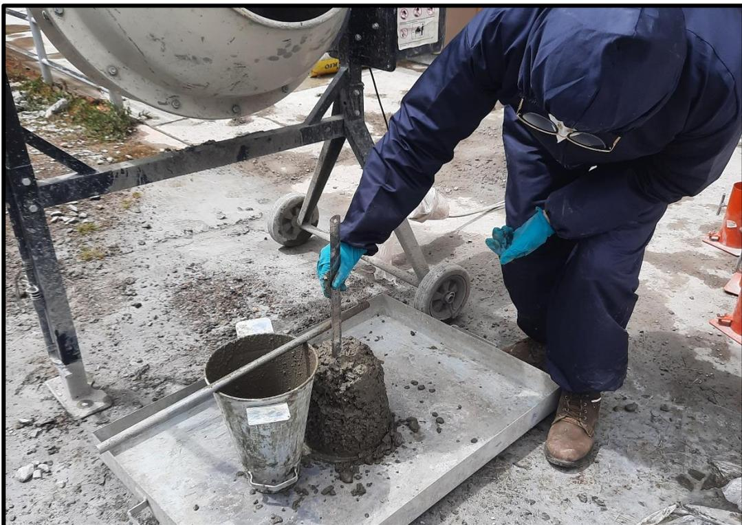
**Fotografía 14.** Medición de la prueba con el cono de Abrams para observar el asentamiento.
