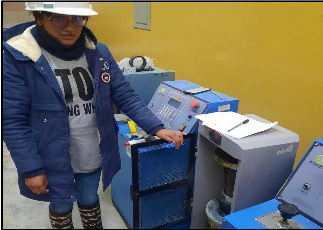
**Fotografía 21.** Rotura de las probetas de concreto para el ensayo de resistencia a la compresión.
