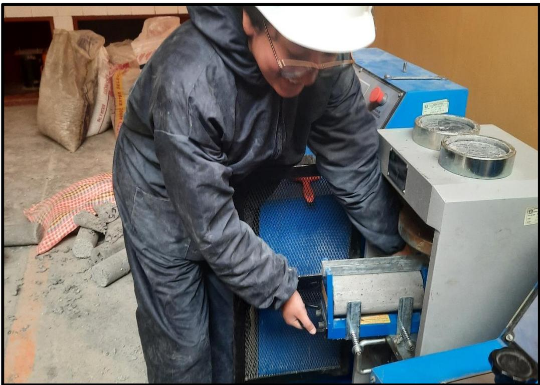
**Fotografía 24.** Rotura de las probetas de concreto para el ensayo de resistencia a la tracción del concreto.
