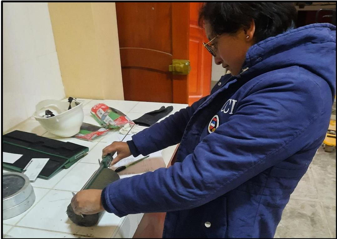
**Fotografía 19.** Medición de las probetas de concreto para el ensayo de resistencia a la compresión.
