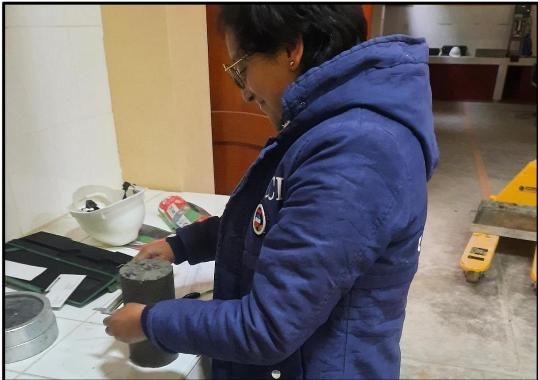
**Fotografía 20.** Medición de las probetas de concreto para el ensayo de resistencia a la tracción.
