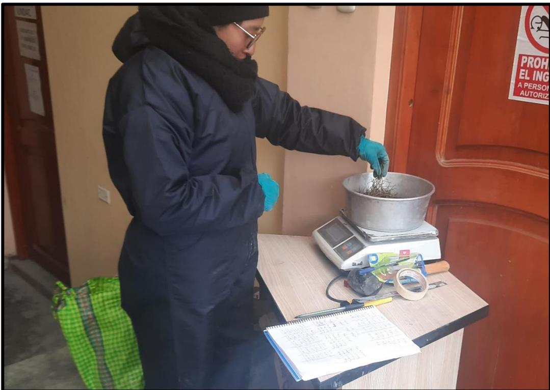
**Fotografía 8.** Peso de las fibras de acero para el diseño de mezcla del concreto  $f'c = 280 \text{ kg/cm}^2$ .
