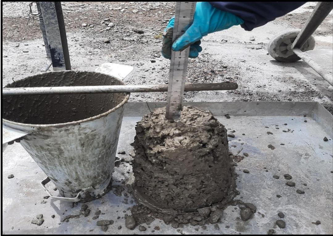
**Fotografía 15.** Medición de la prueba con el cono de Abrams para observar el asentamiento del concreto con SP y FA.
