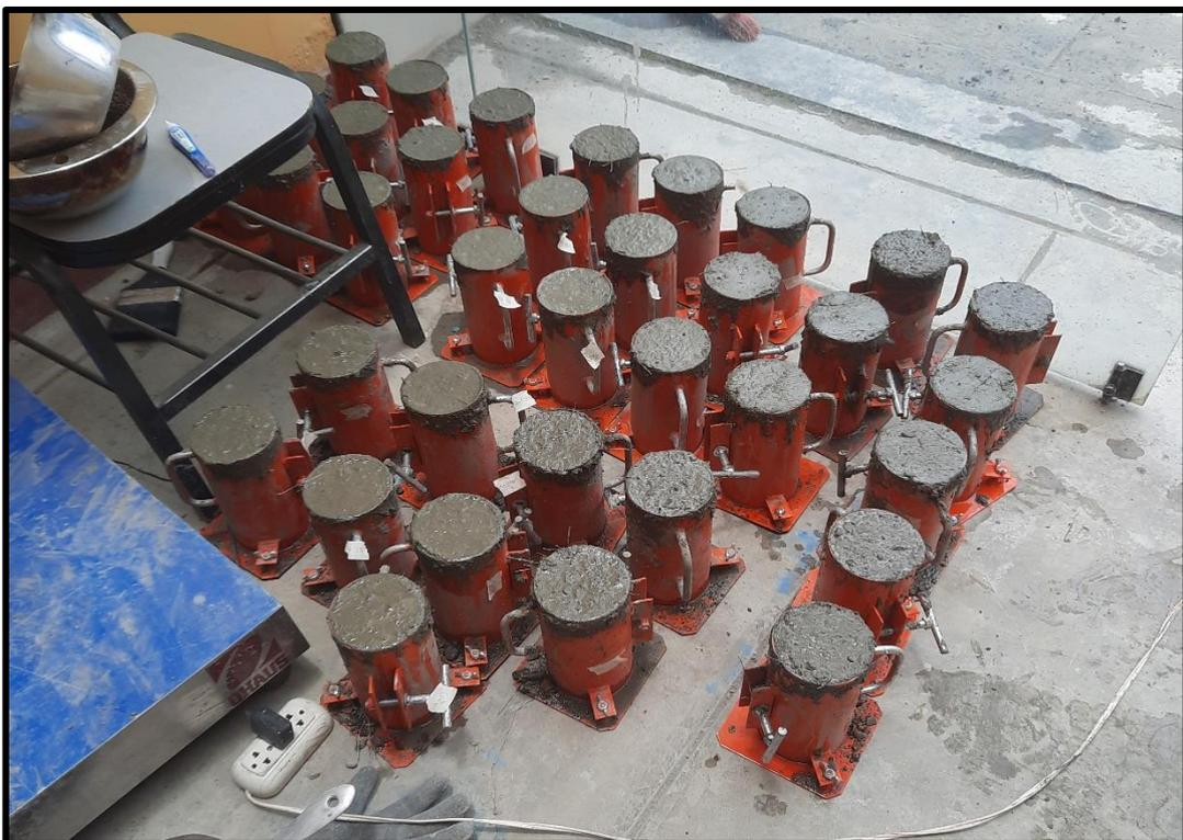
**Fotografía 18.** Probetas del concreto convencional y concreto con SP y FA.
