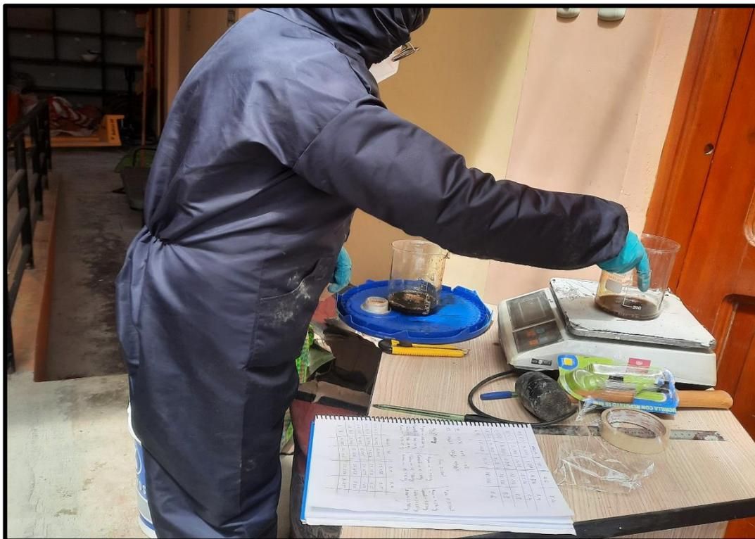
**Fotografía 10.** Peso del aditivo superplastificante para los patrones del concreto  $f'c = 280 \text{ kg/cm}^2$ .
