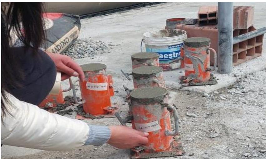
Se realiza la colocación de etiquetas para identificar las probetas.
