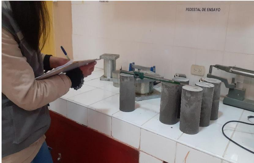
Se miden los diámetros de la probeta antes de la prueba de rotura.
