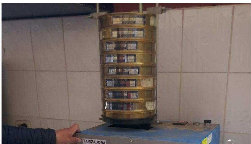
Se realiza el ensayo de Granulometría.
