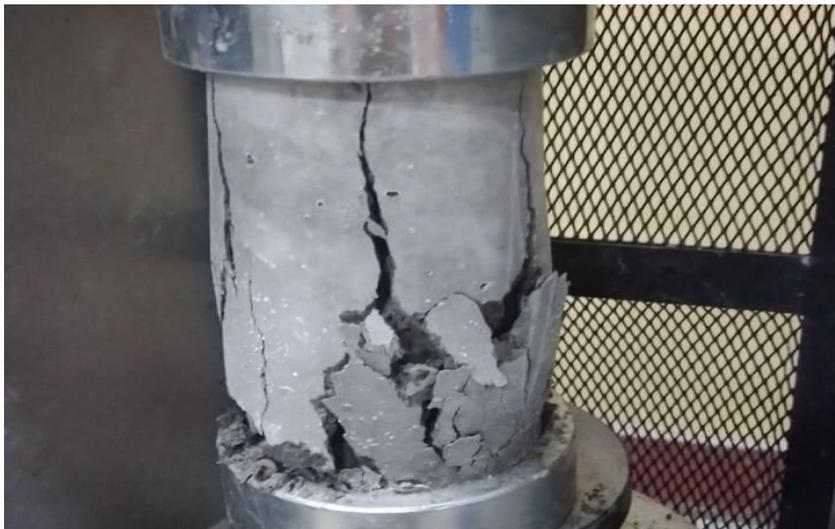
Se observa la falla a compresión del concreto.
