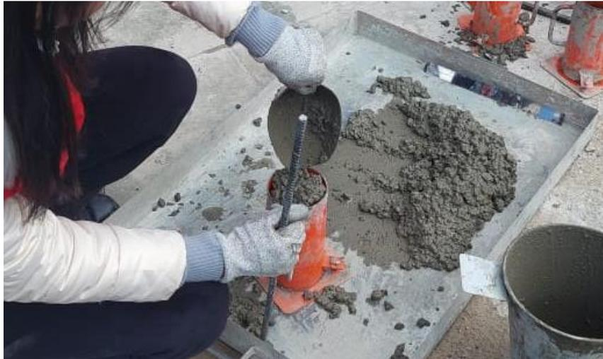
Se realiza el llenado de las probetas.
