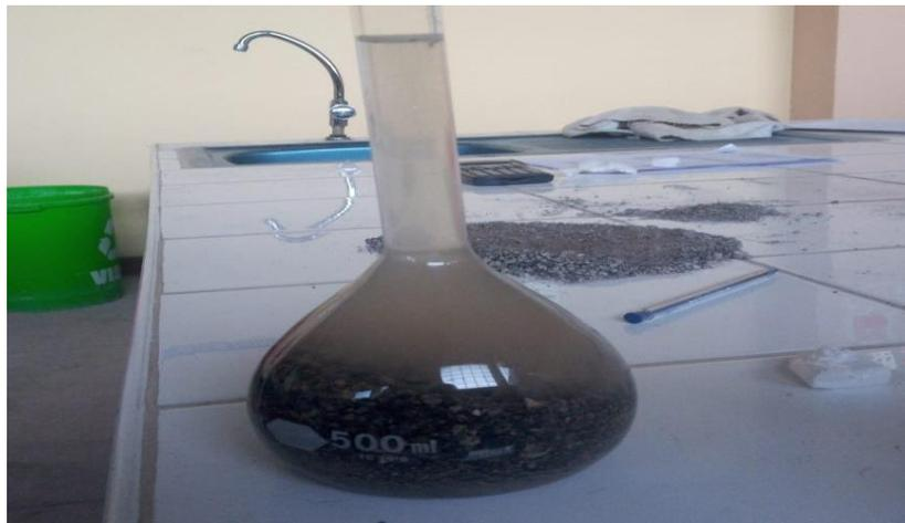
Se realiza el ensayo de peso específico y absorción de agregado fino.
