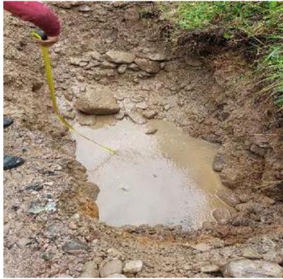
**Fotografía N° 07.** Suelo con nivel freático en capa superficial en alcantarilla.
