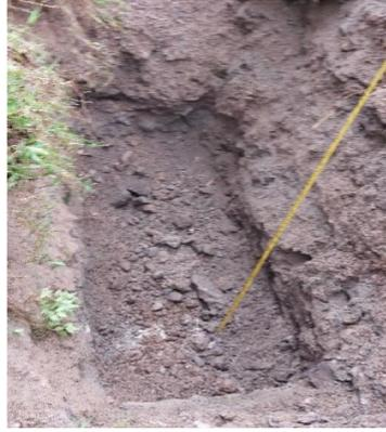
**Fotografía N° 13.** Medición de profundidad de calicata h=1.50 m.
