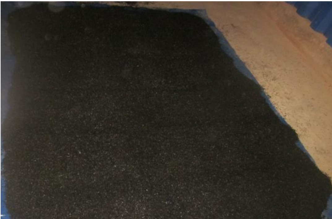
Foto 4: Carbón homogenizado para el cuarteo de carbón reactivado
