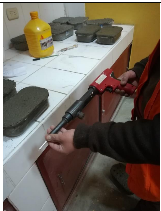
Foto N°24: Medición de resistencias tempranas con Pistola Hilti.
