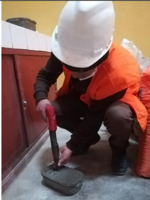
Foto N°25: Medición de resistencias tempranas con Pistola Hilti en las muestras.
