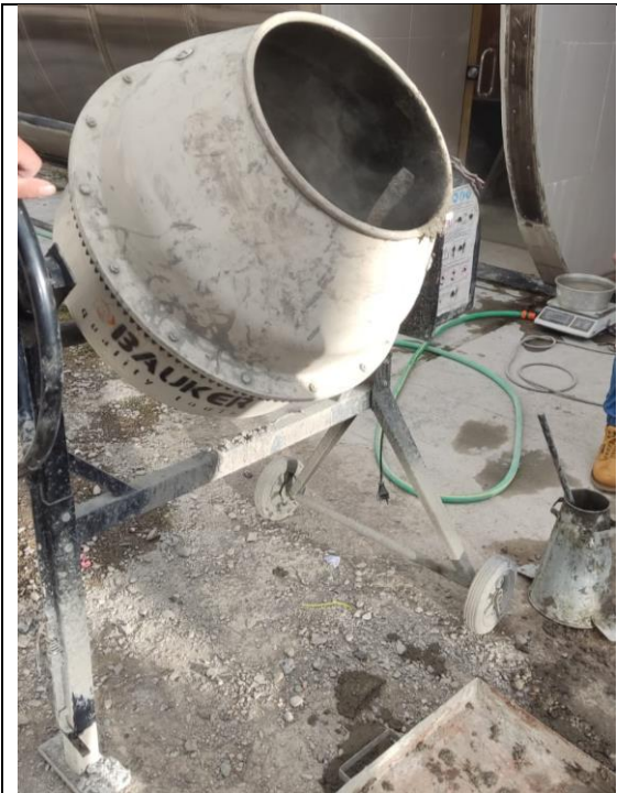
Foto N°05: Trompo mezclador eléctrico de 120 kg de capacidad.
