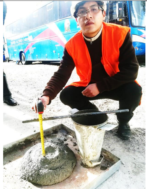
Foto N°12: Medición del SLUMP del Concreto Fresco.
