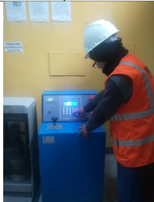
Foto N°32: Medición de resistencia a la compresión de probetas.
