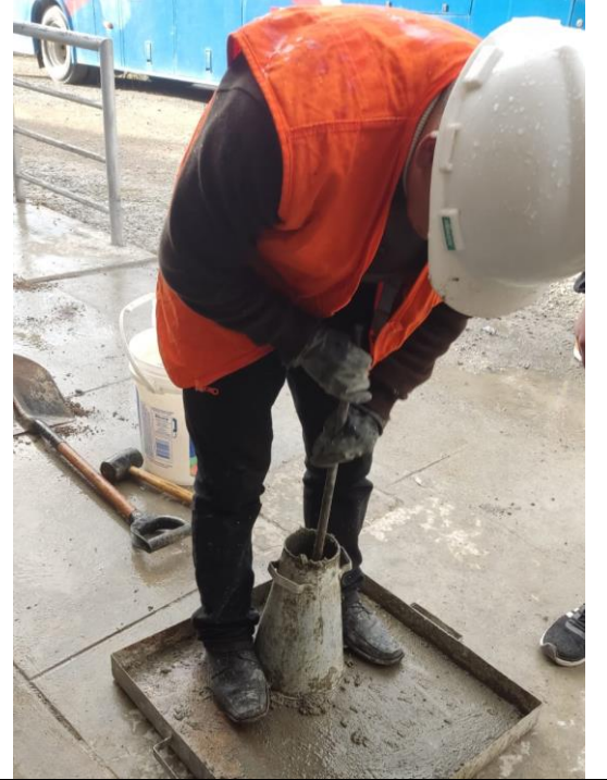
Foto N°10: Ensayo de Consistencia de Cono de Abrams.
