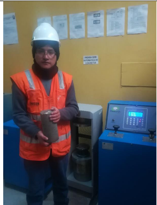
Foto N°30: Probeta y Maquina para medición de resistencia a la compresión.
