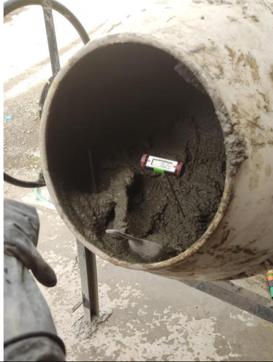
Foto N°09: Medición de temperatura en la mezcla de concreto fresco.
