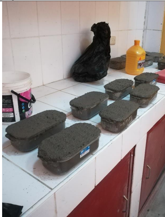
Foto N°19: Muestras a ser ensayadas para medir el desarrollo de resistencias tempranas.
