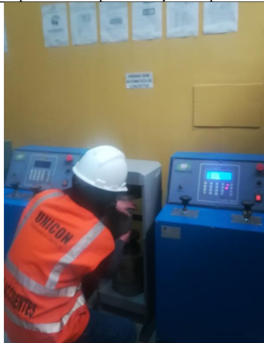
Foto N°31: Colocación de probeta para ensayo de resistencia a la compresión.
