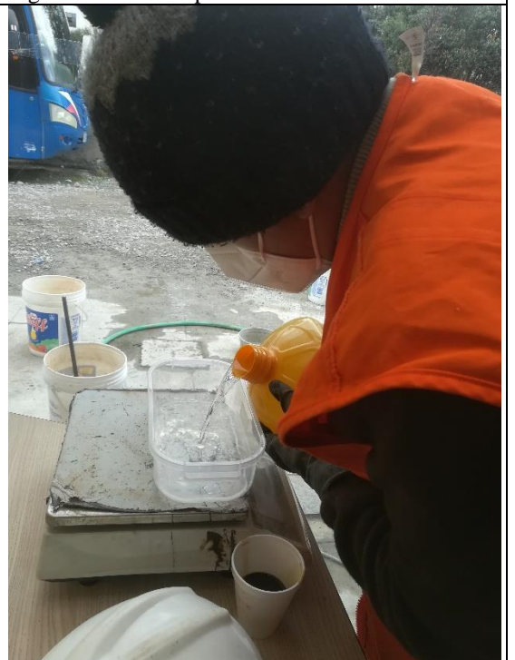
Foto N°04: Peso de cantidad de aditivo según dosificación para mezclado.
