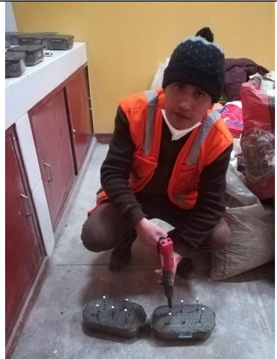
Foto N°26: Clavos empotrados en las muestras de ensayos realizados en las muestras para medición de resistencias tempranas.
