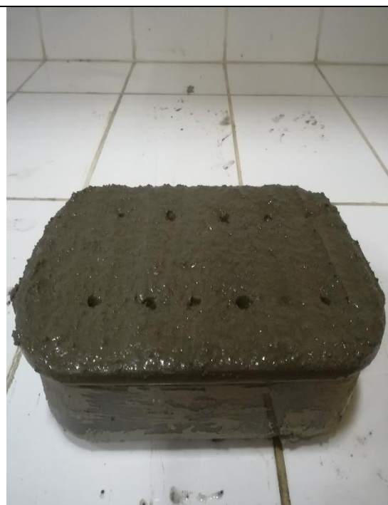
Foto N°22: Mediciones de resistencias tempranas con penetrómetro realizadas a muestras.
