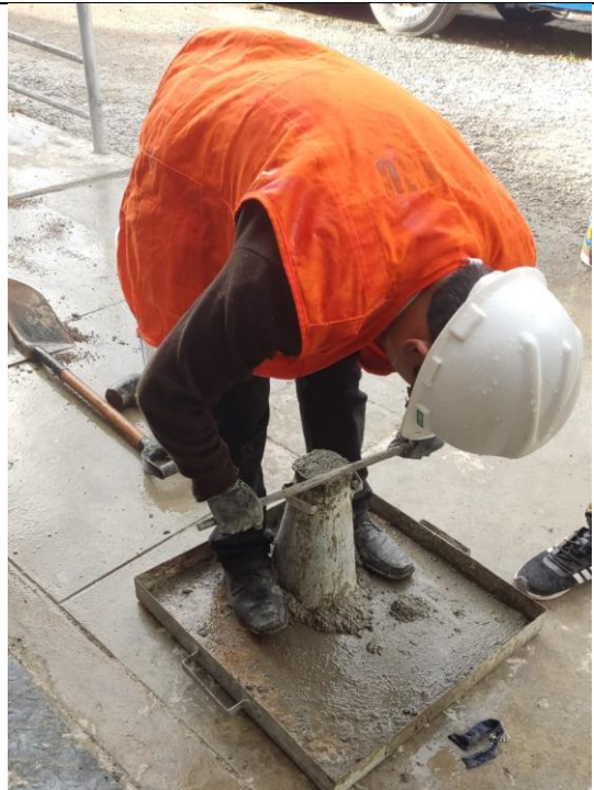
Foto N°11: Ensayo de Consistencia de Cono de Abrams.
