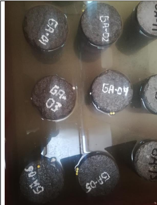
Foto N°29: Extracción de probetas después de su respectivo curado para su ensayo a compresión.
