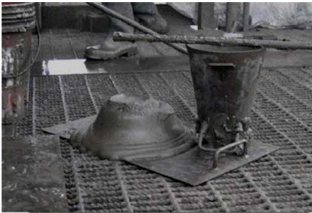
**Foto N° 5.6: Determinación del slump**
