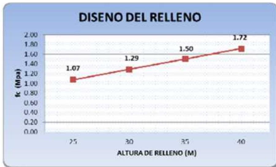
Gráfico N° 5.3: Resistencia y altura de relleno
