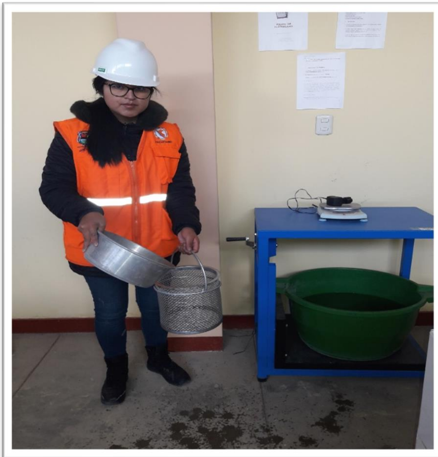
FOTOGRAFÍA 08: Ensayo de peso específico y absorción del agregado
