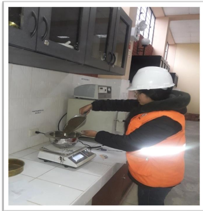
FOTOGRAFÍA 01: Peso del agregado fino para el ensayo granulométrico.
