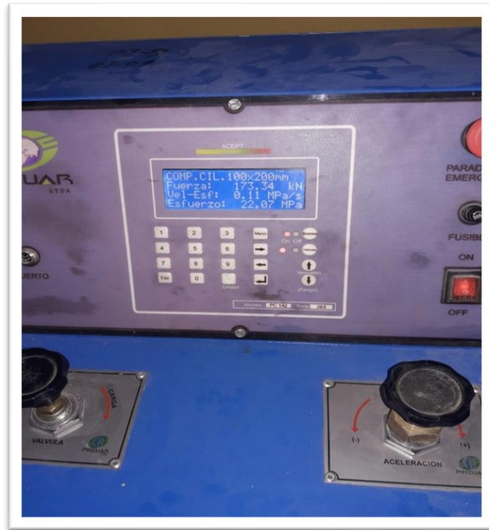
FOTOGRAFÍA 21: Datos de rotura de probeta de concreto por el método compresión ASTM C39/NTP 339.034
