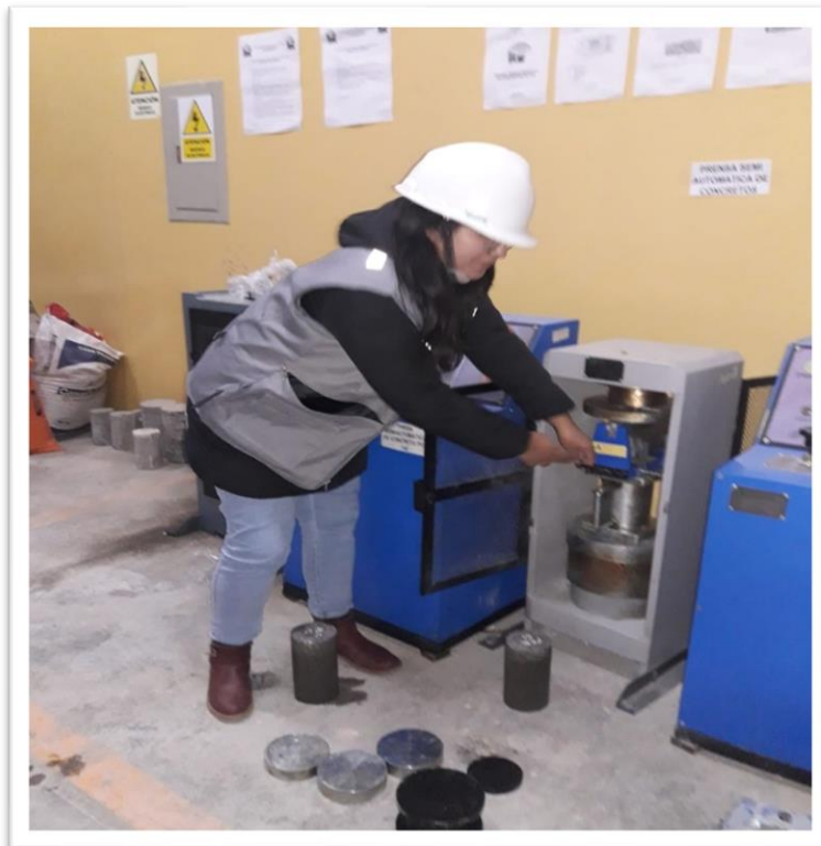
FOTOGRAFÍA 20: Rotura de probeta de concreto por el método compresión ASTM C39/NTP 339.034
