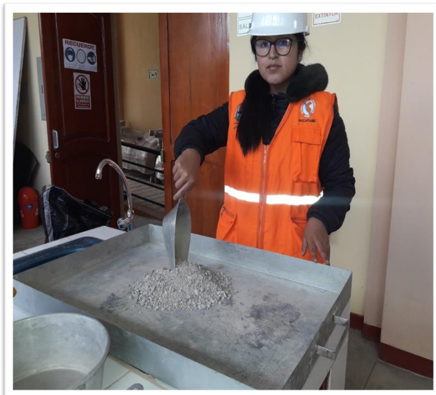
FOTOGRAFÍA 06: caracterización y cuarteo de los agregados.
