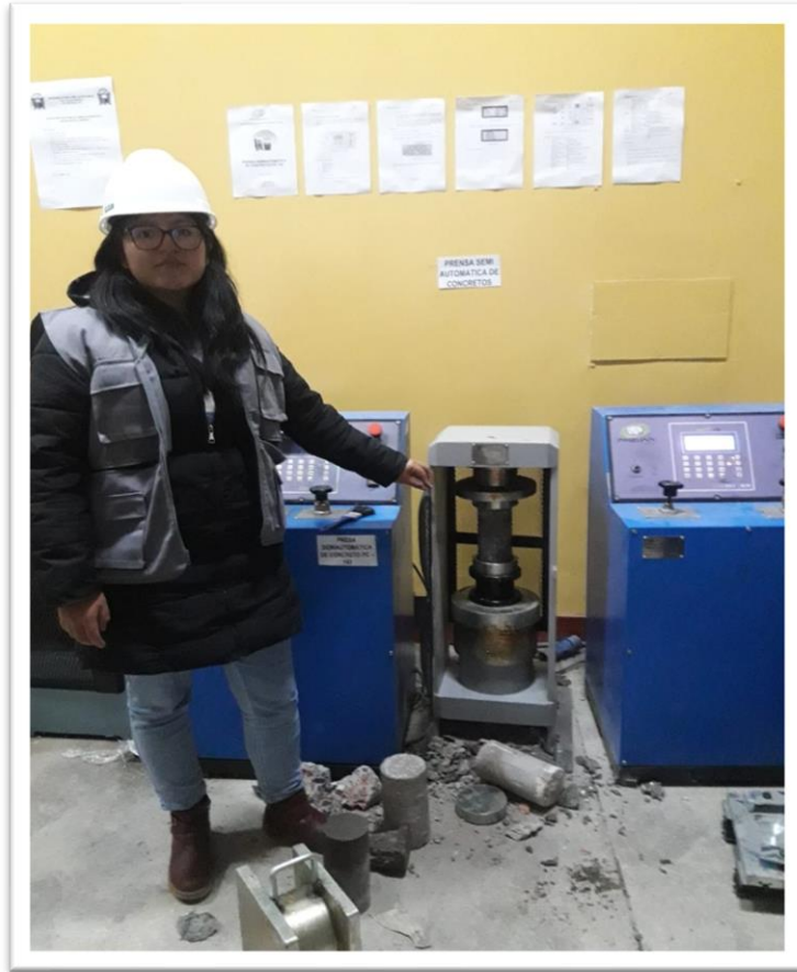
FOTOGRAFÍA 23: Rotura de probeta de concreto por el método compresión ASTM C39/NTP 339.034
