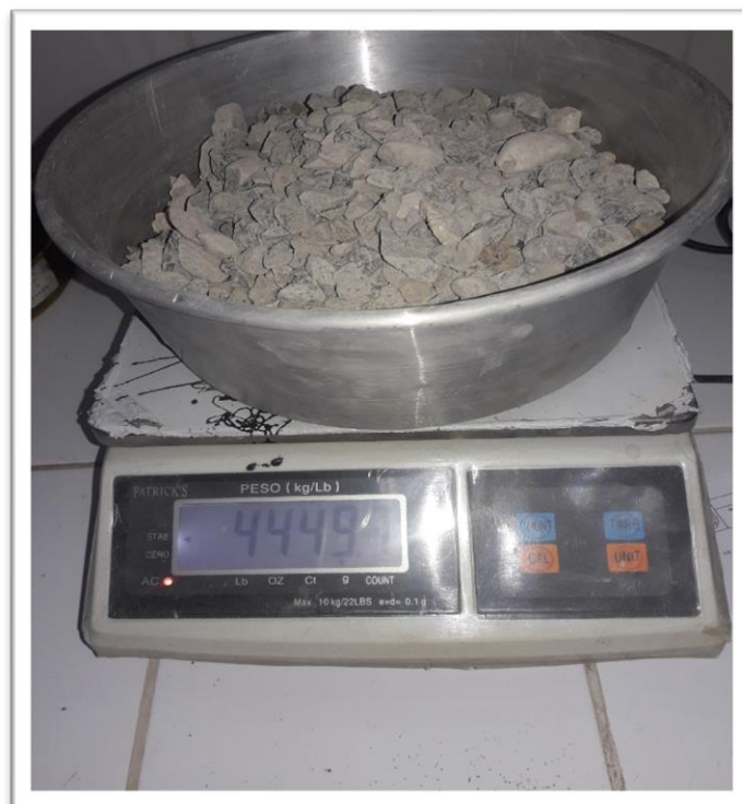
FOTOGRAFÍA 02: Peso del agregado grueso para el ensayo granulométrico.
