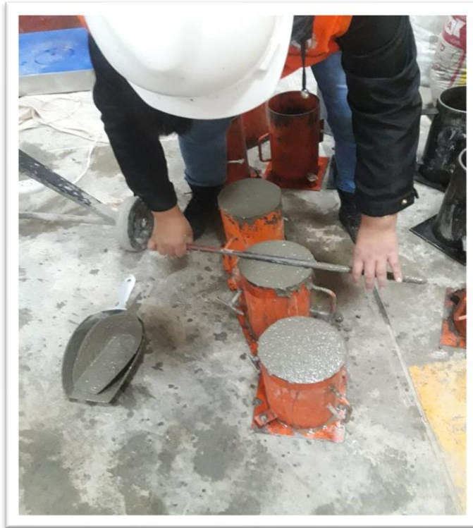
FOTOGRAFÍA 15: Enrasado del exceso de concreto de las probetas.
