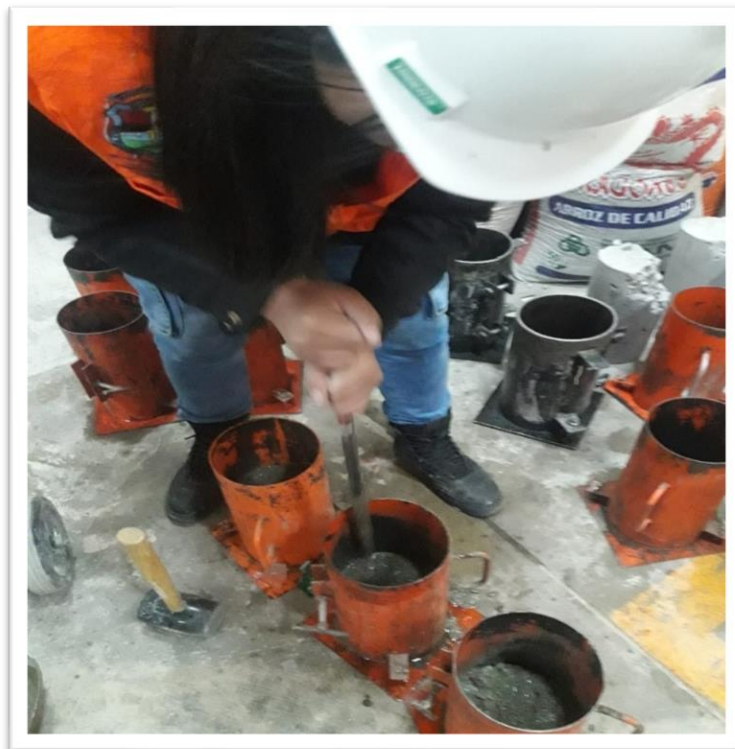
FOTOGRAFÍA 14: colocación del concreto al molde
