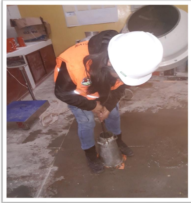
FOTOGRAFÍA 17: Medición de consistencia del concreto fresco por el método de cono de Abrams.
