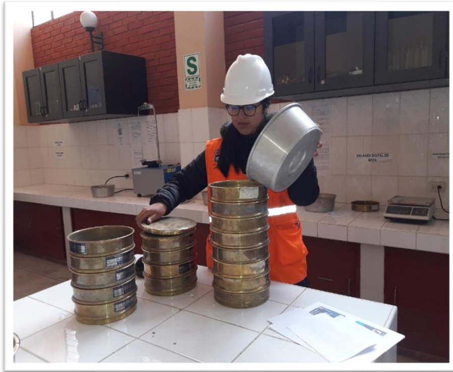
FOTOGRAFÍA 05: Método de prueba para el análisis granulométrico de agregados finos y gruesos.
