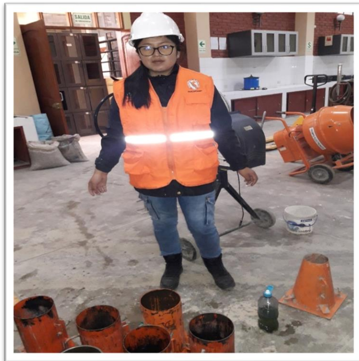
FOTOGRAFÍA 12: Preparación y engrasado con petróleo a los moldes.
