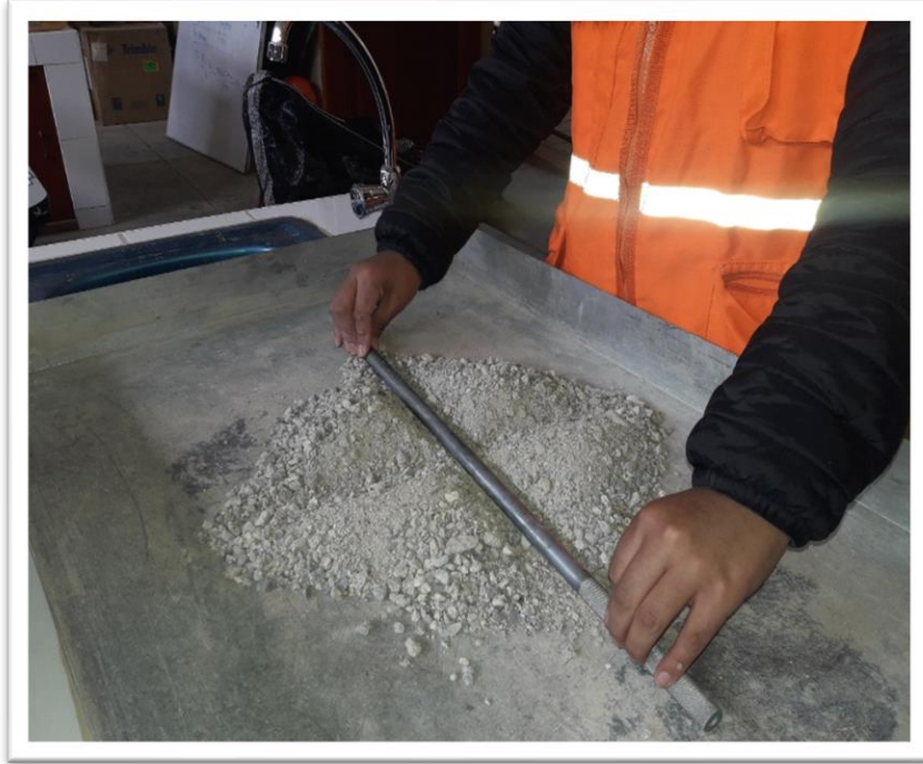
FOTOGRAFÍA 07: Cuarteo de los agregados.
