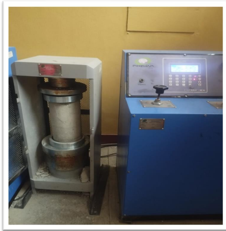
FOTOGRAFÍA 19: Rotura de probeta de concreto por el método compresión ASTM C39/NTP 339.034
