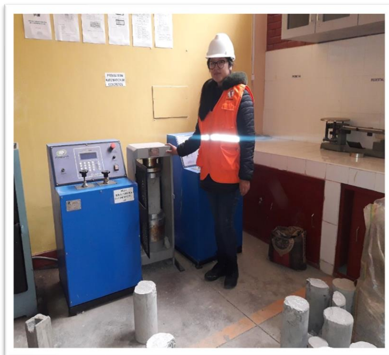
FOTOGRAFÍA 18: Rotura de probeta de concreto por el método compresión ASTM C39/NTP 339.034
