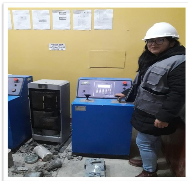
FOTOGRAFÍA 22: Rotura de probeta de concreto por el método compresión ASTM C39/NTP 339.034
