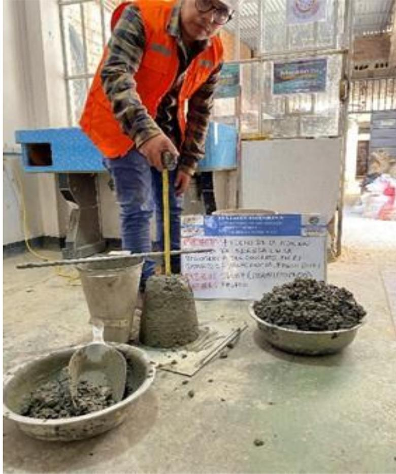
**Nota:** Un ves preparado el concreto fresco, se procede a calcular mediante el cono de Abrams, para ello se vierte concreto fresco dentro del cono hasta  $1/3$  de su total, luego se le da 25 varilejos, luego se vuelve a verter el concreto fresco hasta  $2/3$  del total y se vuelve a dar 25 varilejos finalmente se llena hasta el tope y luego se saca el cono y se pone boca abajo y con una wincha se procede a medir el asentamiento.
