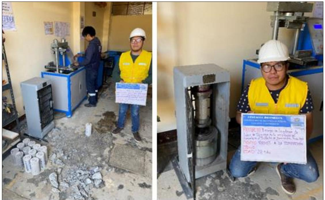
**Tabla 19.** Rotura de probetas a los 7, 14 y 28 días
