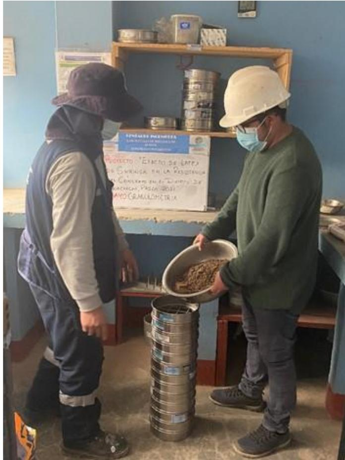
**Nota:** Se procede a tamizar por los tamices 5 in, 4 in, 3 ½ in, 3 in, 2 ½ in, 2 in, 1 ½ in, 1 in, ¾ in, ½ in, 3/8 in, No. 4, No. 8, No. 16, No. 30, No. 50, No. 100, No. 200, para luego pesar la cantidad retenida en cada tamiz.
