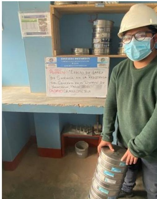
**Nota:** Se procede a tamizar por los tamices 5 in, 4 in, 3 ½ in, 3 in, 2 ½ in, 2 in, 1 ½ in, 1 in, ¾ in, ½ in, 3/8 in, No. 4, No. 8, No. 16, No. 30, No. 50, No. 100, No. 200, para luego pesar la cantidad retenida en cada tamiz.
