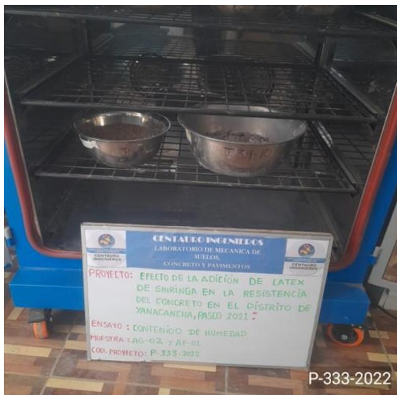
Nota: Se pesa los agregados fino y grueso y luego se introduce al horno, después de enfriar se vuelve a pesar la piedra chancada y con esos datos se calcula la humedad de la piedra chancada y de la arena gruesa.
