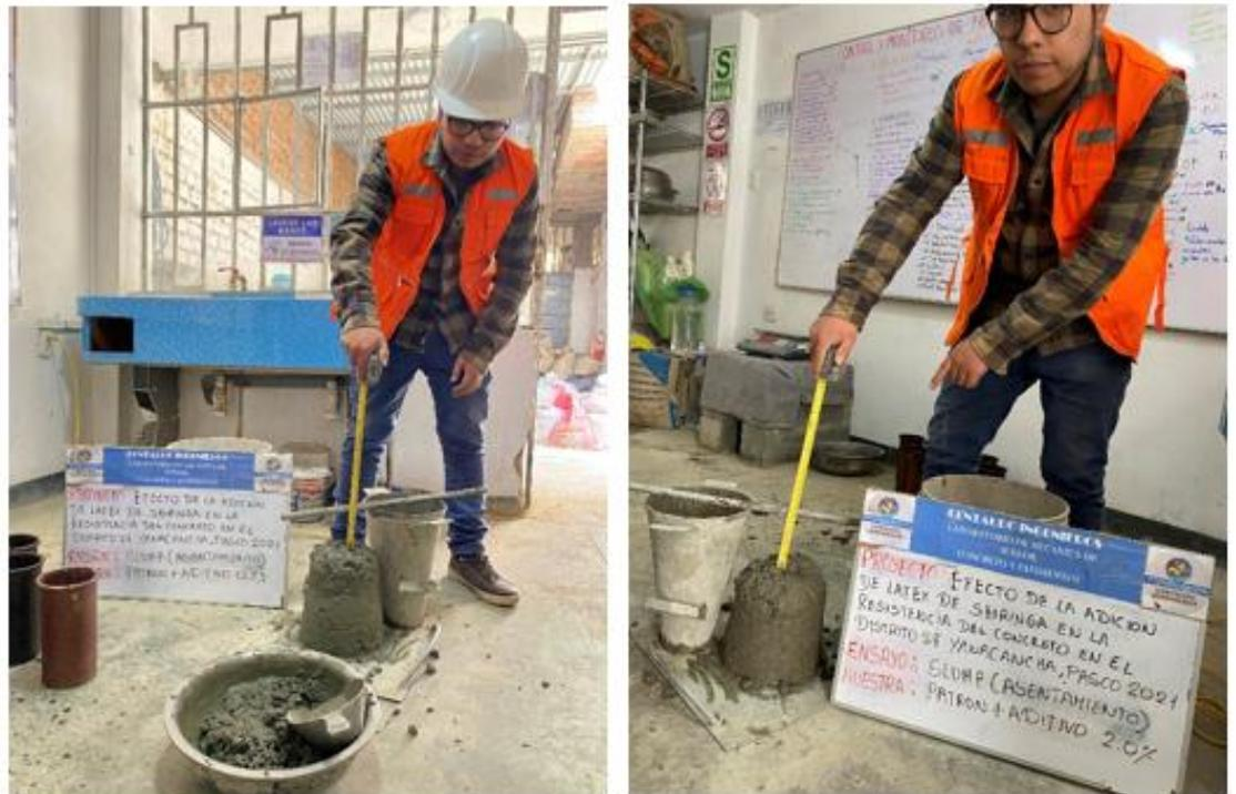
**Tabla 22.** Cálculo de la plasticidad del concreto mediante el cono de Abrams
