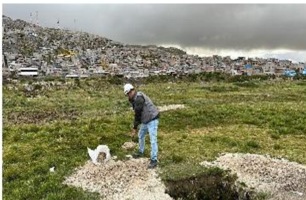
**Fotografía N°03.- Extracción de muestra de la Calicata N°01 de la zona Chaquicocha, para conocer las propiedades físicas y mecánicas de suelos.**
