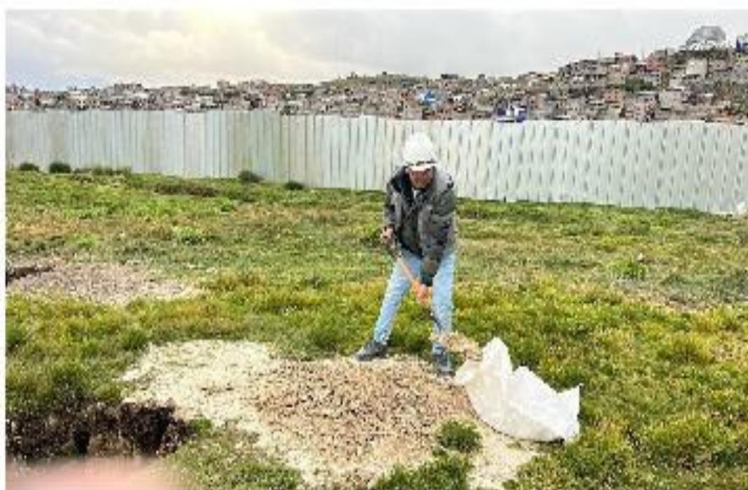
**Fotografía N°04.- Extracción de muestra de la Calicata N°02 de la zona Chaquicocha, para conocer las propiedades físicas y mecánicas de suelos.**
