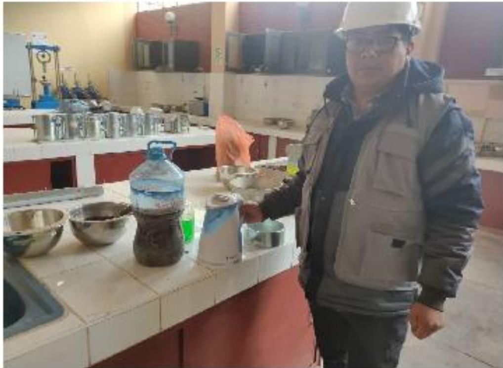
**Fotografía N°11.-Elaboracion del gel de linaza, preparado en una proporción de 1:10, para ser usado en el Proctor y para el CBR.**
