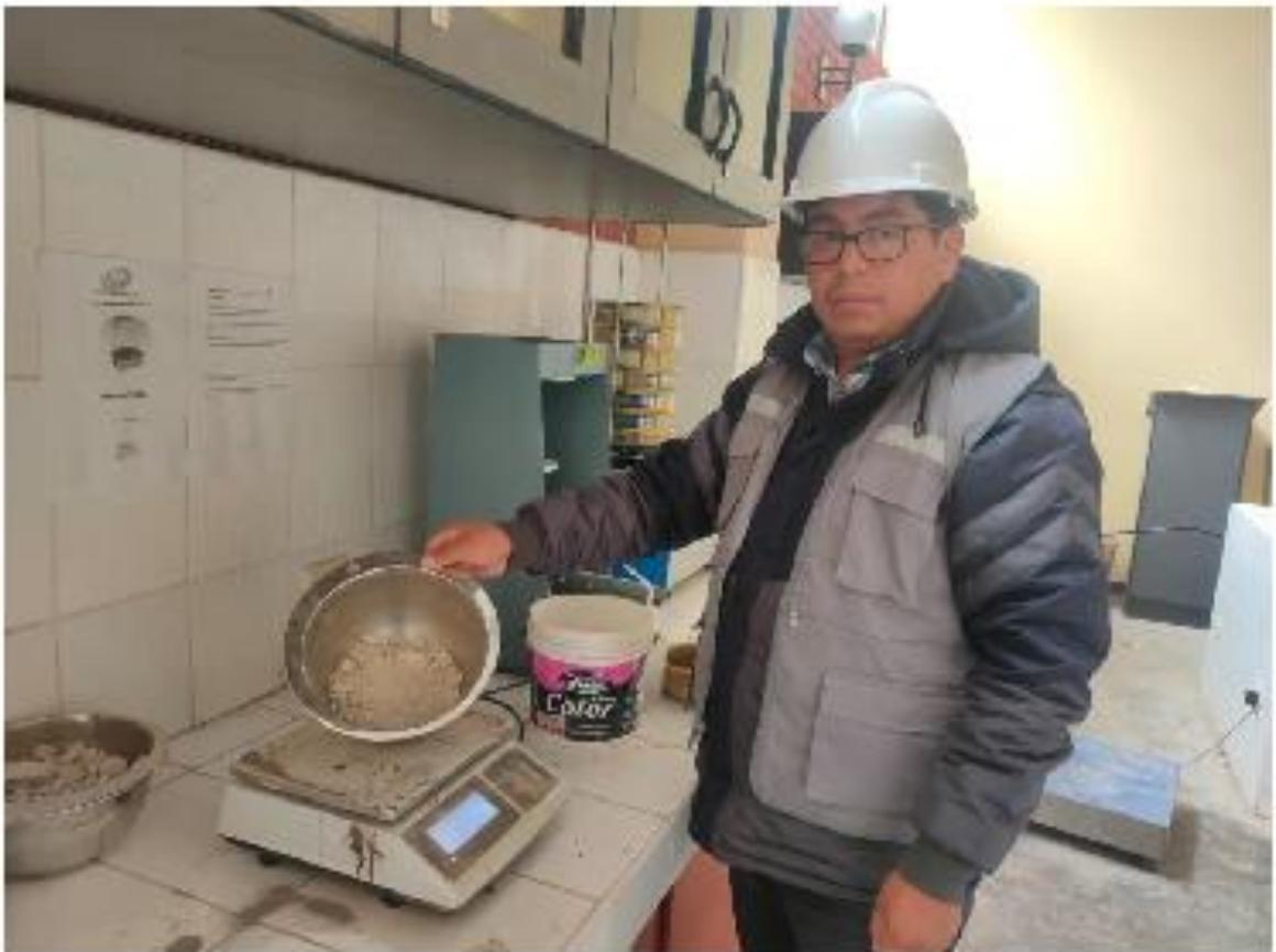
**Fotografía N°24 .- proceso de obtención de la humedad**
