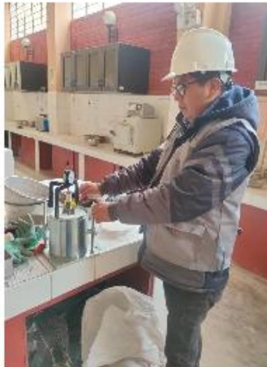
**Fotografía N°22 .- Proceso de preparación del molde con el suelo para ensayo de CBR con el suelo en el agua durante 96 horas**
