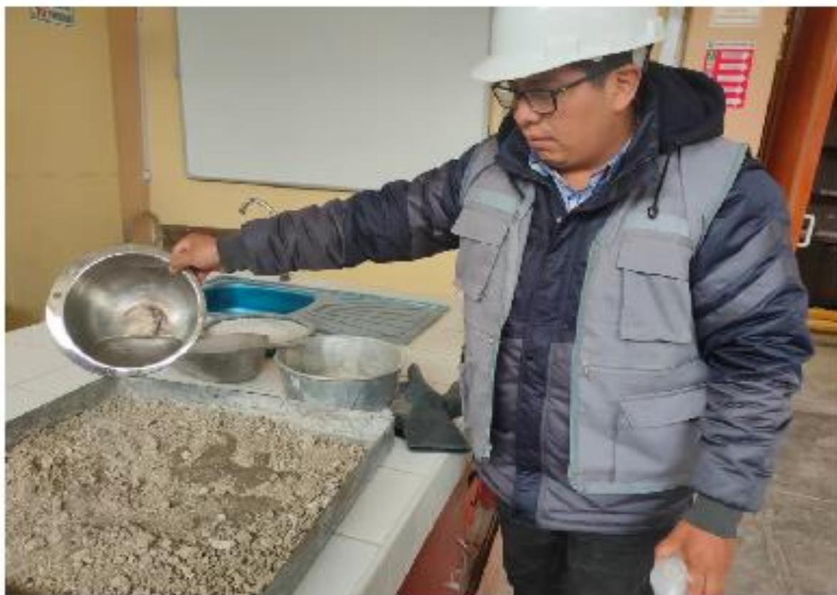
**Fotografía N°19 .- Proceso de preparación de muestras a diferentes humedades para los ensayos de proctor estandar y CBR**
