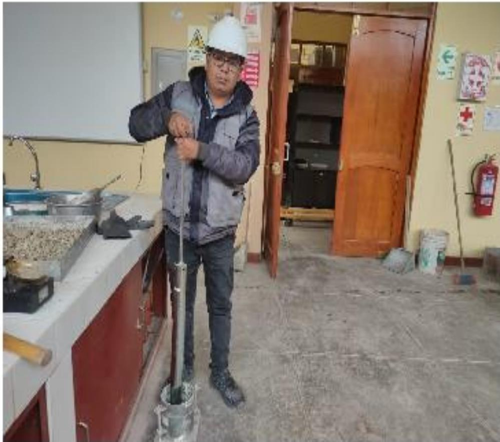
Fotografía N°17.- Proceso de compactado para la prueba de Proctor estándar
