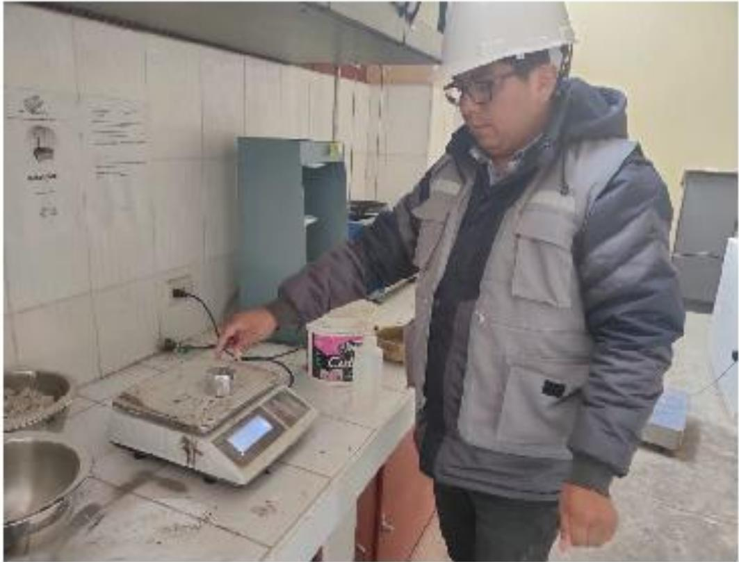
Fotografía N° 15.-Proceso de pesado de la muestra seca + peso de tara.
