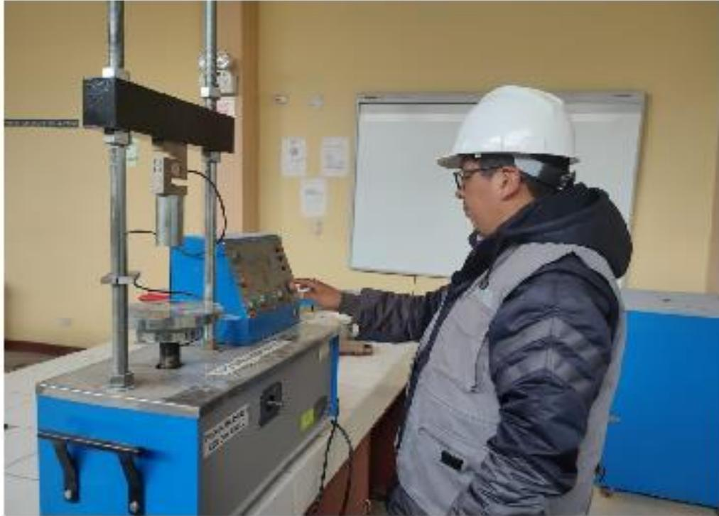
**Fotografía N°13.-Preparacion del equipo de CBR automático, para las lecturas de las probetas peradas después de 72 horas.**
