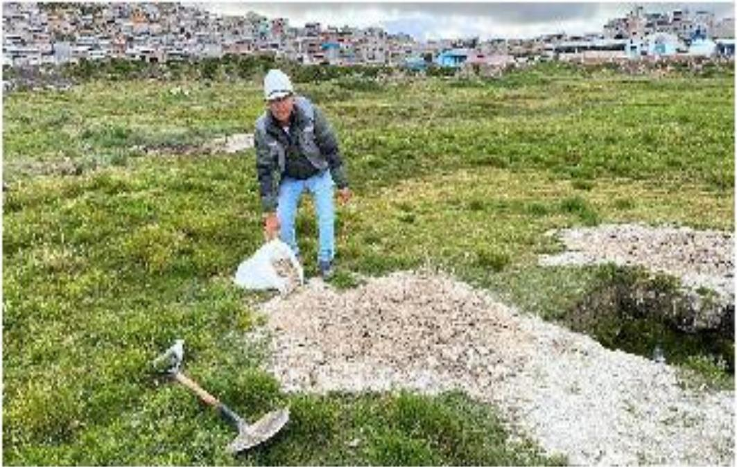
Fotografía N°01.-Extracción de muestra de la Calicata N°01 de la zona Chaquicocha, para conocer las propiedades físicas y mecánicas de suelos.
