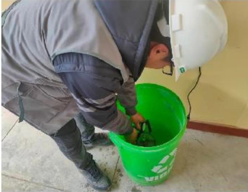
**Fotografía N°21 .- Proceso de sumergir el molde de CBR con el suelo en el agua durante 96 horas**
