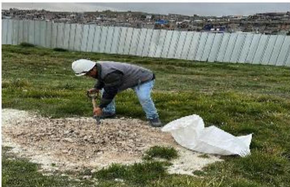
**Fotografía N°08.- Extracción de muestra de la Calicata N°03 de la zona Chaquicocha, para conocer las propiedades físicas y mecánicas de suelos.**
