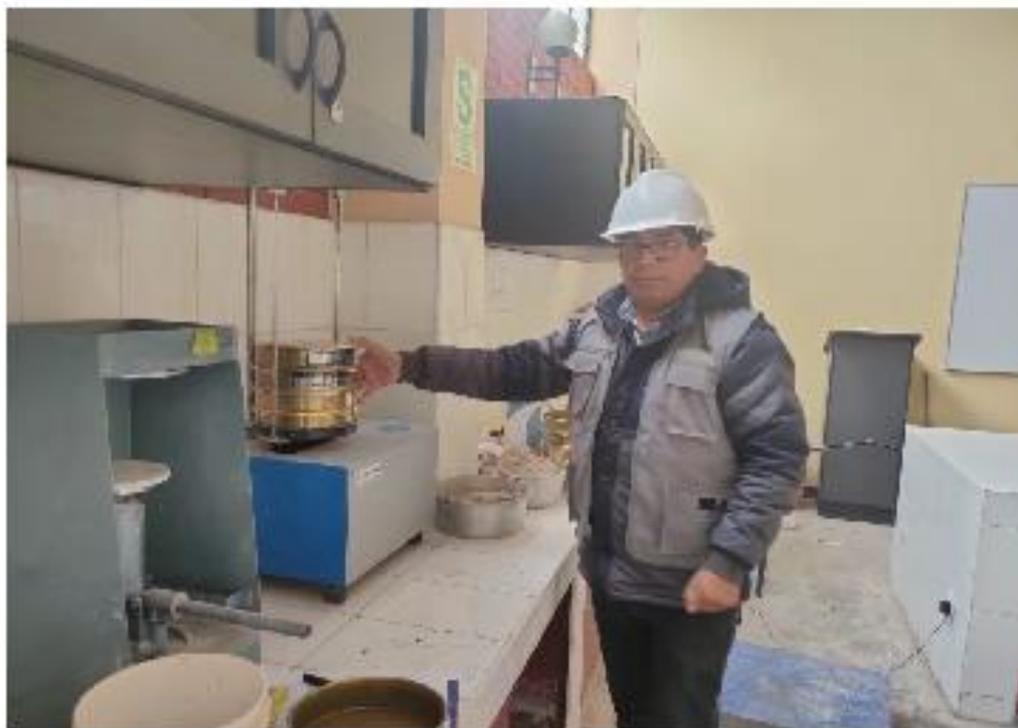
**Fotografía N°12.-Proceso de tamizado para preparar material de suelos a malla menor a 3/8".**
