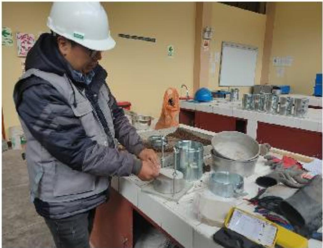
**Fotografía N°10.-Colocacion de filtros en los moldes de CBR para conocer propiedades mecánicas de suelos.**
