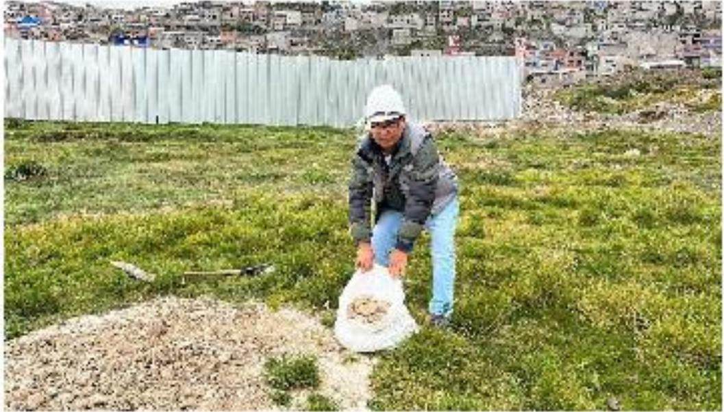
**Fotografía N°09.- Extracción de muestra de la Calicata N°03 de la zona Chaquicocha, para conocer las propiedades físicas y mecánicas de suelos.**
