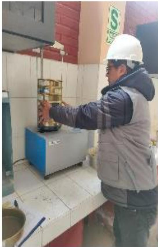
Fotografía N°25 .- Proceso de obtención del análisis granulométrico
