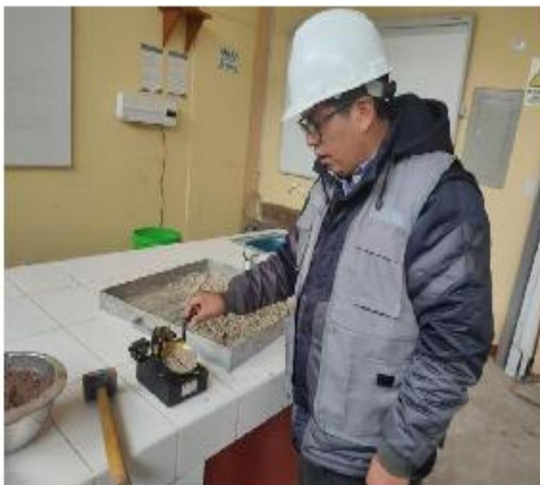
Fotografía N°18.- Proceso de ensayo de limite liquido con la copa de
