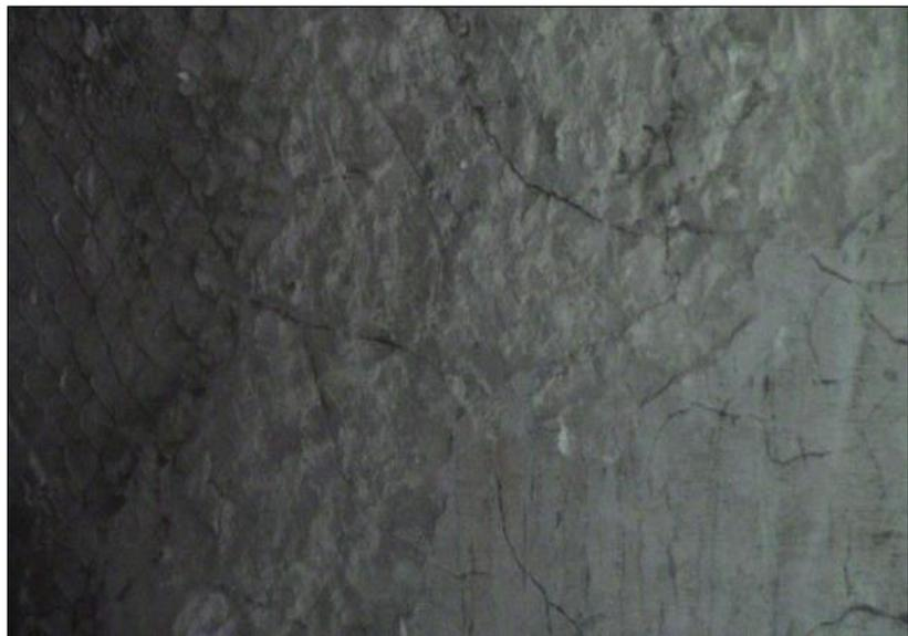
*Figura 17. Resultado después del proceso de fraguado, se observa que existe deterioro*
