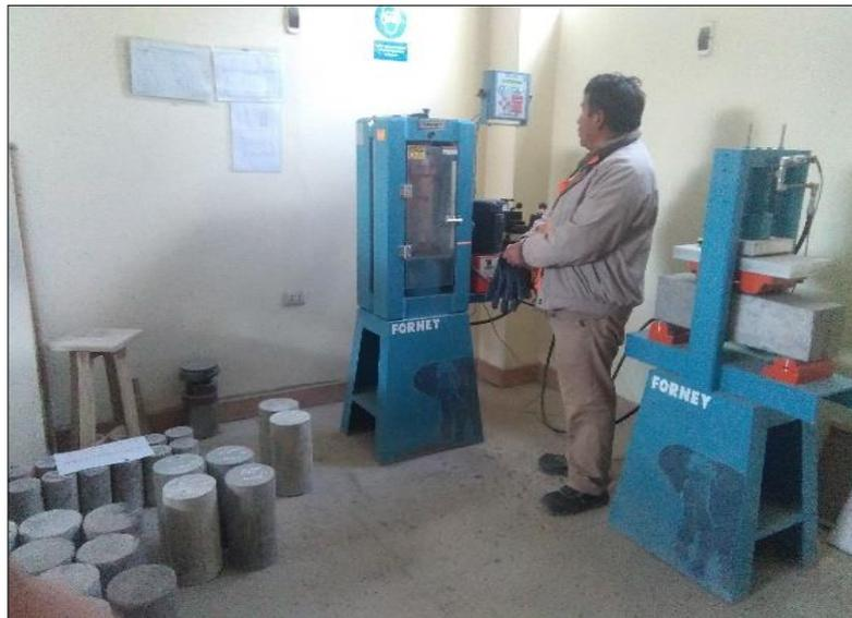
*Figura 36. Ensayo de compresión en probetas de mortero con baritina*
