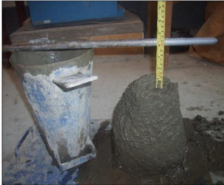
*Figura 33. Ensayo de asentamiento para el mortero con baritina*
