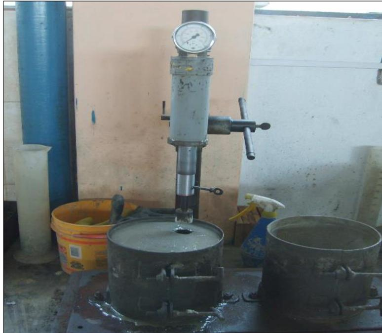
*Figura 35. Ensayo de tiempo de fraguado para el mortero con baritina*
