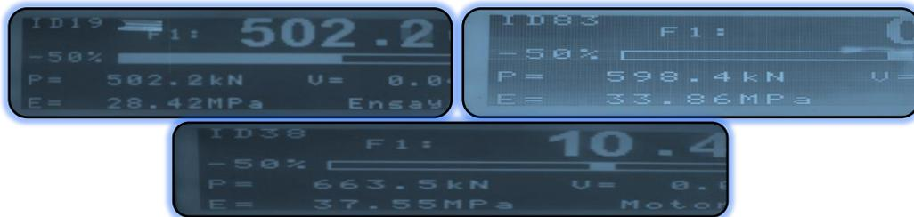
**Imagen 18.** Resultados de la Prensa a compresión en KN, para probetas de 7, 14 y 28 días, de concreto en diseño  $f'_c=280$  kfg/cm<sup>2</sup> con adición de 2 kg de Macro fibra de polipropileno.
