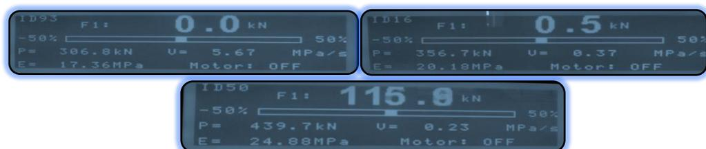
**Imagen 13.** Resultados de la Prensa a compresión en KN, para probetas de 7, 14 y 28 días, de concreto en diseño  $f'_c=210$  kfg/cm<sup>2</sup> con adición de 5 kg de Macro fibra de polipropileno.
