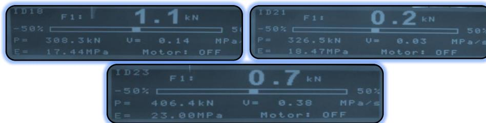
**Imagen 12.** Resultados de la Prensa a compresión en KN, para probetas de 7, 14 y 28 días, de concreto en diseño  $f'c=210$  kfg/cm<sup>2</sup> con adición de 2 kg de Macro fibra de polipropileno.
