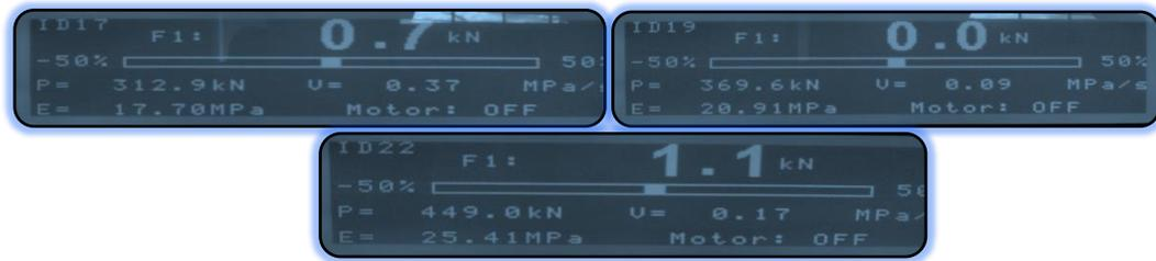
**Imagen 14.** Resultados de la Prensa a compresión en KN, para probetas de 7, 14 y 28 días, de concreto en diseño  $f'_c=210$  kfg/cm<sup>2</sup> con adición de 9 kg de Macro fibra de polipropileno.
