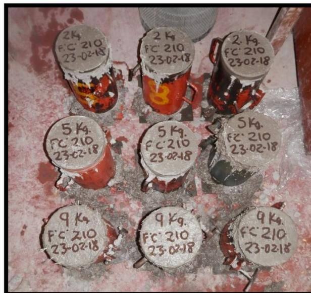
**Imagen 10.** Ensayo de las probetas de concreto en la prensa, obteniendo la resistencia de compresión
