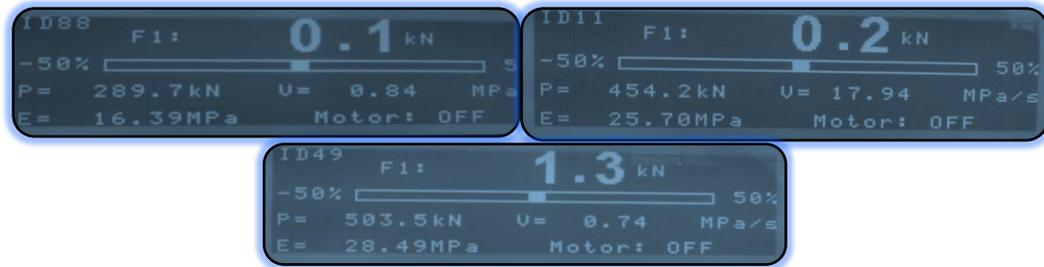
**Imagen 17.** Resultados de la Prensa a compresión en KN, para probetas de 7, 14 y 28 días, de concreto en diseño  $f'_c=280$  kfg/cm<sup>2</sup> sin adición.
