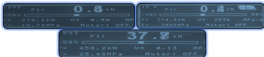
**Imagen 16.** Resultados de la Prensa a compresión en KN, para probetas de 7, 14 y 28 días, de concreto en diseño  $f'_c=210$  kfg/cm<sup>2</sup> con adición de 15 kg de fibra de acero.
