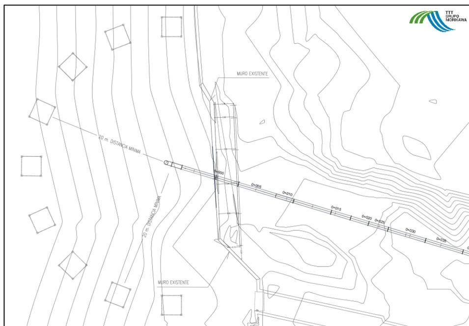
IMAGEN 16: DISTRIBUCIÓN RADIAL DE JAULAS CON RESPECTO A LA TUBERÍA DE CAPTACIÓN / FUENTE: PROPIA
