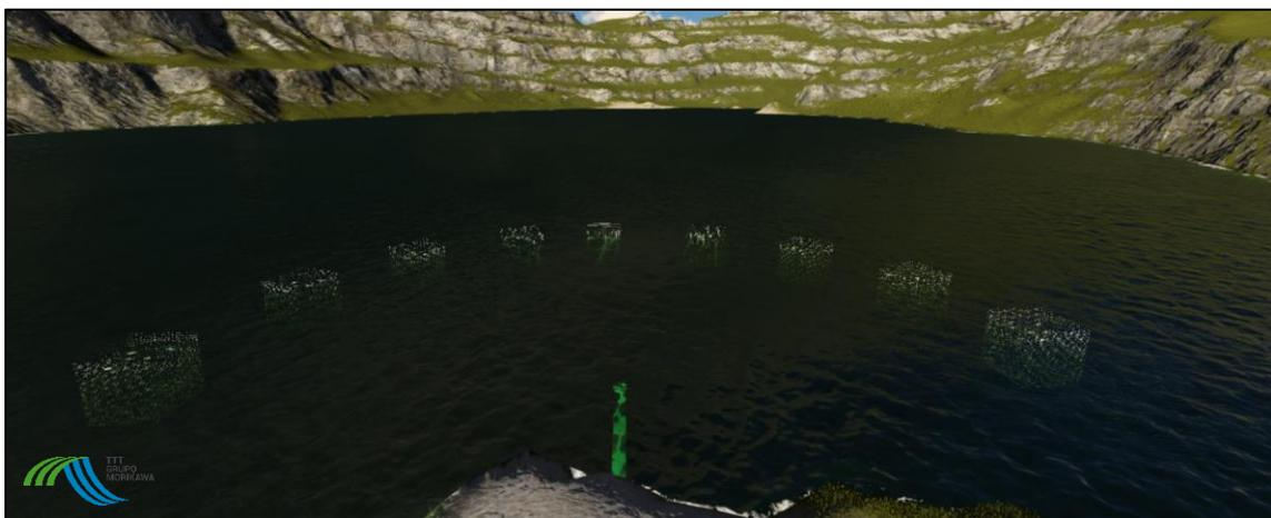
IMAGEN 17: RECREACIÓN 3D DE LA TUBERÍA DE CAPTACIÓN Y LAS JAULAS DISTRIBUIDAS RADIALMENTE / FUENTE: PROPIA
