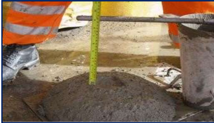
Figura 29. Medición del slump Fuente: Dpto. Geomecanica. U.E. Animón.
