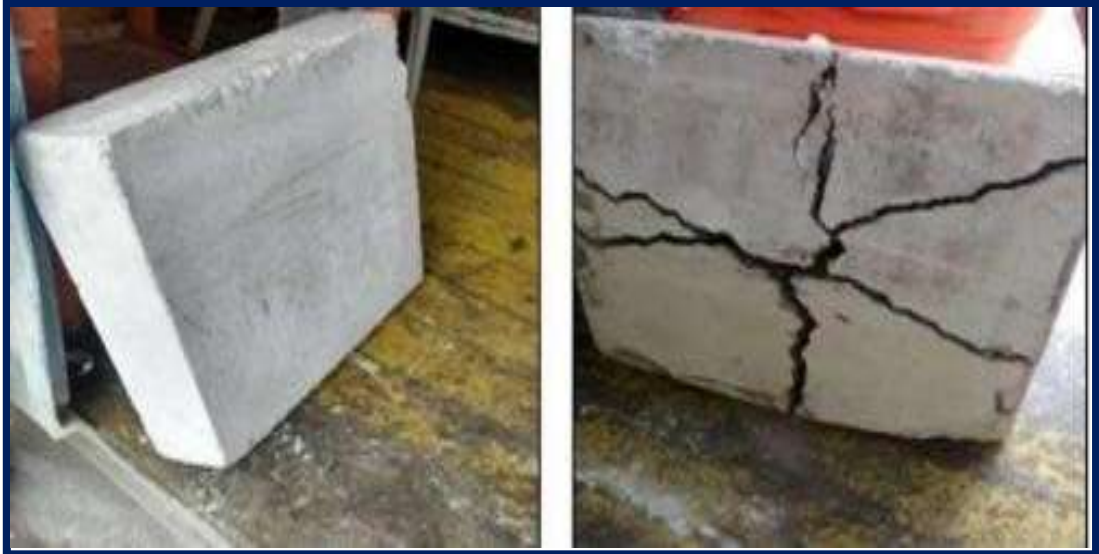
Figura 31. Ensayo panel cuadrado (antes y después de ser ensayado) Fuente: Laboratorio de planta de concreto. UE. Animón
