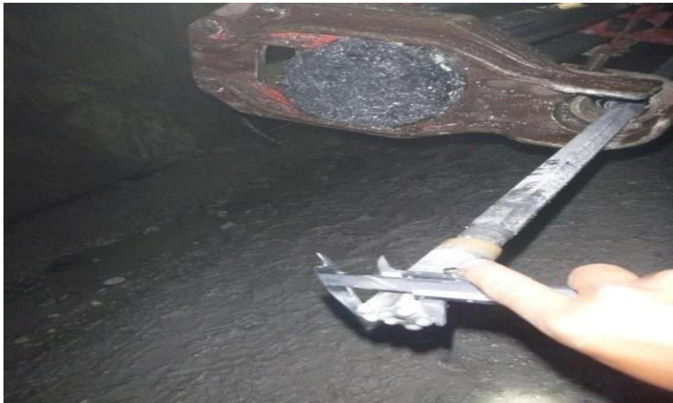
Figura 21 Medición de broca a afilar.
