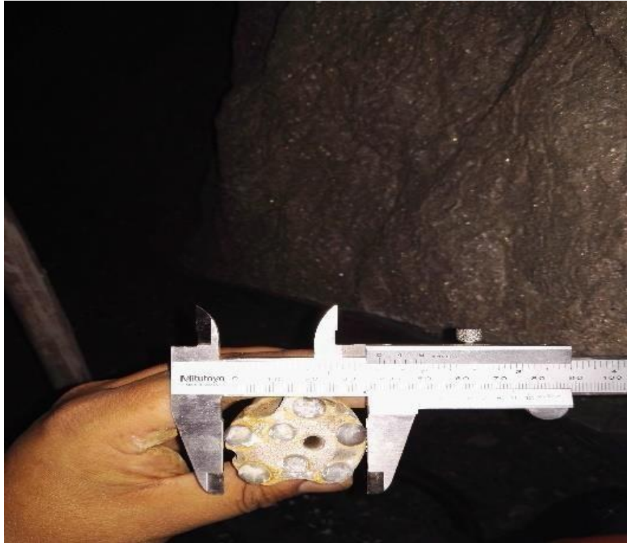
Figura 22 Medición de broca a afilar.
