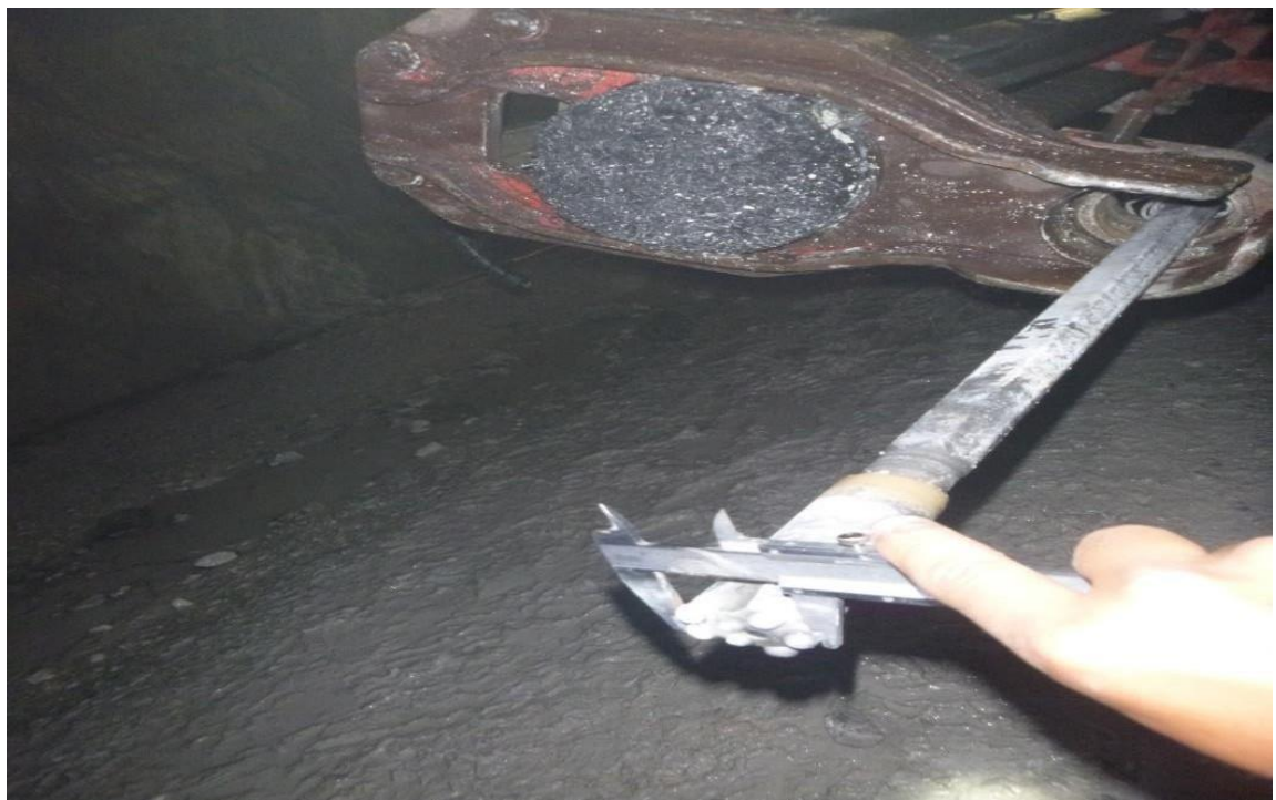
Figura 92 Medición de brocas con vernier en jumbo
