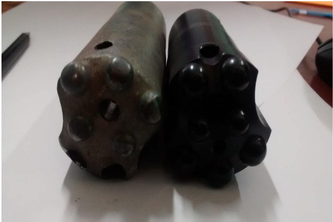
Figura 93 Comparación de brocas usada y nueva.
