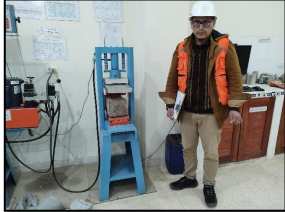
Fotografía: Proceso de análisis de rotura de compresión y flexo compresión de la unidad de adobe.
