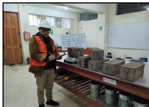
Fotografía: Proceso de medición de dimensiones y pesos de cada unidad de adobe para el análisis de compresión y flexión.
