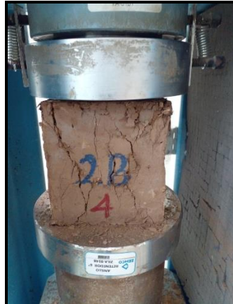
Fotografía: Proceso de ensayo de compresión de la unidad de adobe.
