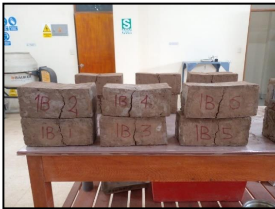
Fotografía: Muestras después de sufrir el esfuerzo de flexo compresión.
