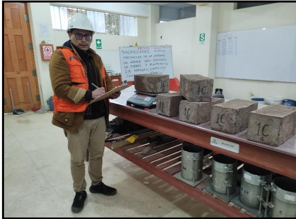
Fotografía: Proceso de medición de dimensiones y pesos de cada unidad de adobe para el análisis de flexión.
