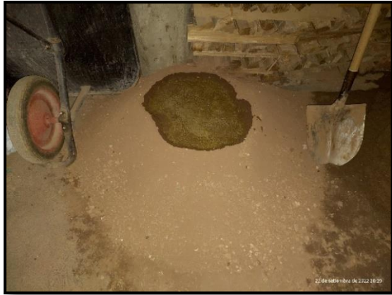
Fotografía: Mezclado de extracto y fibras de maguey con el suelo.
