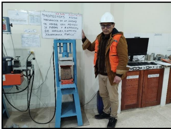
Fotografía: Proceso del ensayo de flexo compresión de las unidades de adobe.
