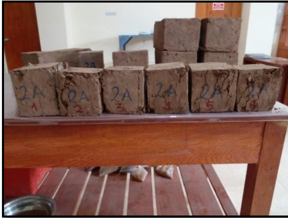
Fotografía: Muestras de adobe después del ensayo de rotura a la compresión.
