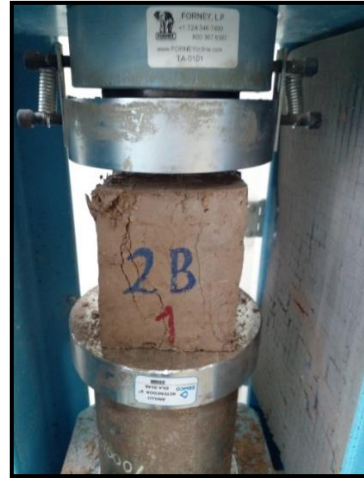
Fotografía: Proceso de ensayo de compresión de la unidad de adobe con adición de fibras y extracto de maguey.
