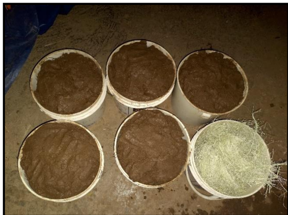
Fotografía: Proporción de materiales a utilizar para la fabricación de unidades de adobe con adición de 0.27% de fibras y 50% de extracto.
