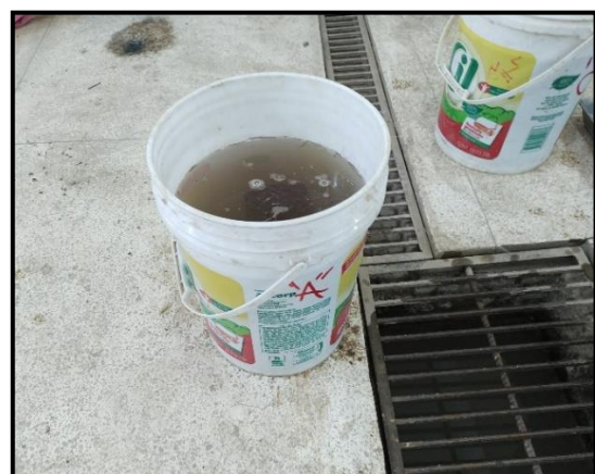
Fotografía: Proceso de inmersión de la unidad de adobe con paja (A), el cual pasado 24 horas se ve una saturación total.
