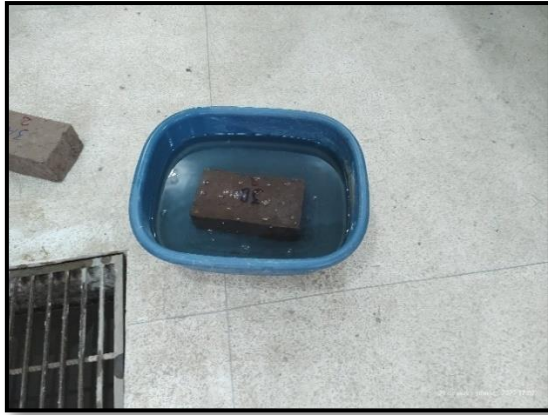
Fotografía: Proceso de inmersión de la unidad de adobe con adición de 0.27% de fibra y 50% de extracto de magüey, el cual pasado las 24 horas la unidad de adobe aún se mantiene.
