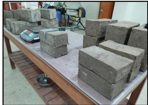
Fotografía: Proceso de medición de dimensiones y pesos de cada unidad de adobe para el análisis de absorción.
