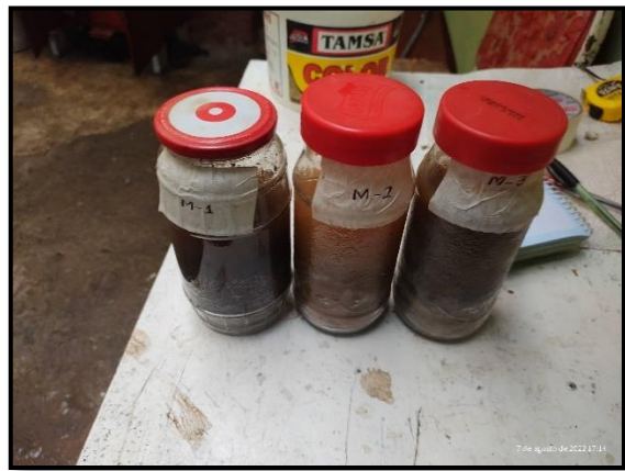
Fotografía: Desarrollo de la prueba de sedimentación o decantación de partículas de las tres muestras recolectadas.
