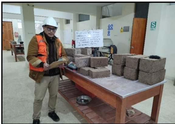
Fotografía: Proceso de medición de dimensiones y pesos de cada unidad de adobe para el análisis de absorción.
