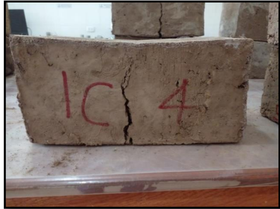
Fotografía: Muestras después de sufrir el esfuerzo de flexo compresión.
