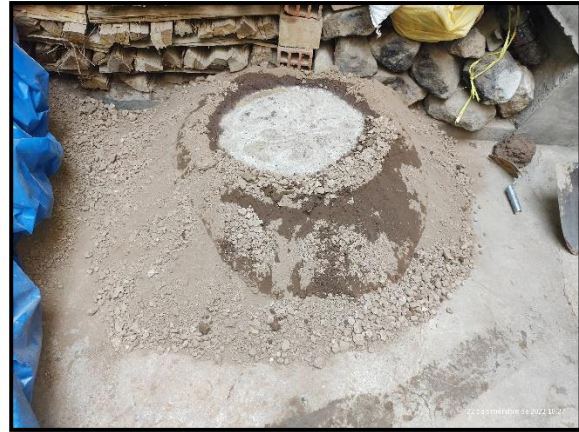
Fotografía: Mezclado del extracto de maguey con el suelo.
