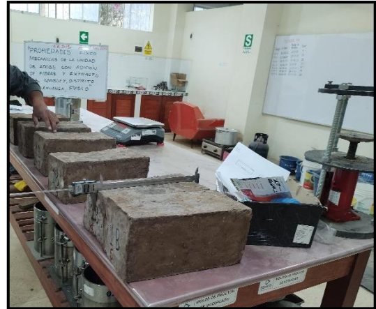
Fotografía: Proceso de medición de dimensiones y pesos de cada unidad de adobe para el análisis de flexión.
