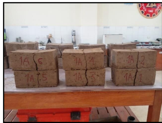
Fotografía: Muestras después de sufrir el esfuerzo de flexo compresión.
