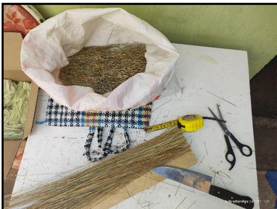
Fotografía: Cortado de la paja y de las fibras ya secas de acuerdo a las dimensiones a utilizar.
