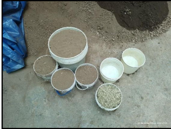
Fotografía: Proporción de materiales a utilizar para las unidades de adobe tradicional con paja.
