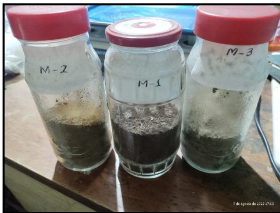
Fotografía: Desarrollo de la prueba de sedimentación o decantación de partículas de las tres muestras recolectadas.
