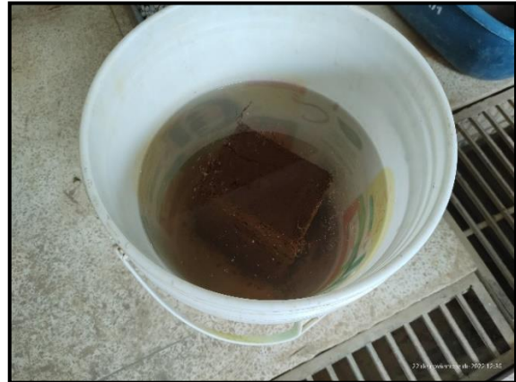
Fotografía: Proceso de inmersión de la unidad de adobe con adición de 0.13% de fibra y 50% de extracto de magüey, el cual pasado las 24 horas la unidad de adobe aún se mantiene.
