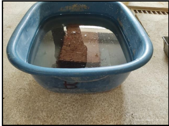
Fotografía: Proceso de inmersión de la unidad de adobe con adición de 0.27% de fibra y 50% de extracto de magüey, el cual pasado las 24 horas la unidad de adobe aún se mantiene.
