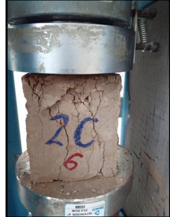
Fotografía: Proceso de ensayo de compresión de la unidad de adobe.
