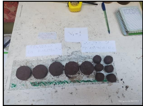
Fotografía: Prueba de la cintilla de barro y prueba de la pastilla, de las tres muestras recolectadas.
