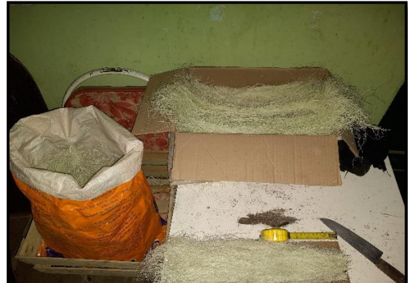
Fotografía: Cortado de la paja y de las fibras ya secas de acuerdo a las dimensiones a utilizar.
