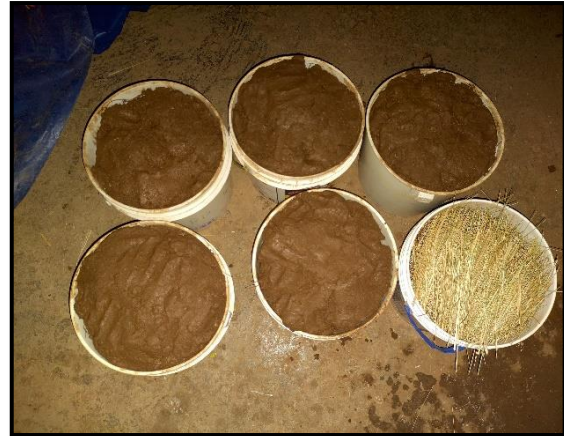
Fotografía: Proporción de materiales a utilizar para las unidades de adobe tradicional con paja.
