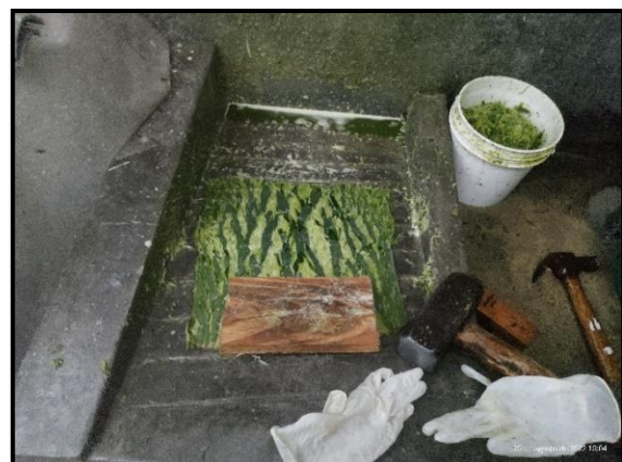
Fotografía: Proceso de extracción de las fibras de hojas de maguey.
