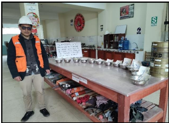
Fotografía: Proceso de clasificación de muestras de suelos después del tamizado.
