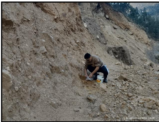
Fotografía: Recolección previa de muestras para su análisis tacto visual y de campo, para la elección del suelo adecuado para la elaboración de las unidades de adobe, de los tres lugares designados.
