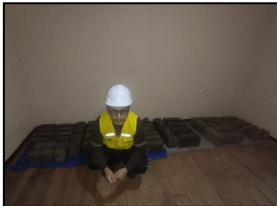
Fotografía: Proceso de secado de las unidades de adobe.
