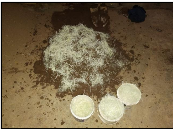
Fotografía: Preparación de la mezcla con adición de 0.27% de fibras y 50% de extracto de maguey, y su posterior proceso de fabricación de unidades de adobe.
