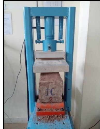
Fotografía: Ensayo de flexo compresión de las unidades de adobe.
