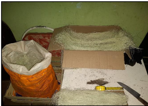
7. Cortado de las fibras de acuerdo a las dimensiones y proporciones requeridas para el proyecto.
