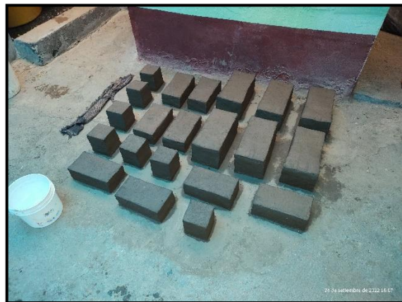
Fotografía: Mezclado del barro con paja y la culminación del proceso de fabricación de las unidades de adobe con paja (muestras de control).
