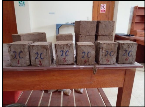
Fotografía: Muestras de adobe después del ensayo de rotura a la compresión.
