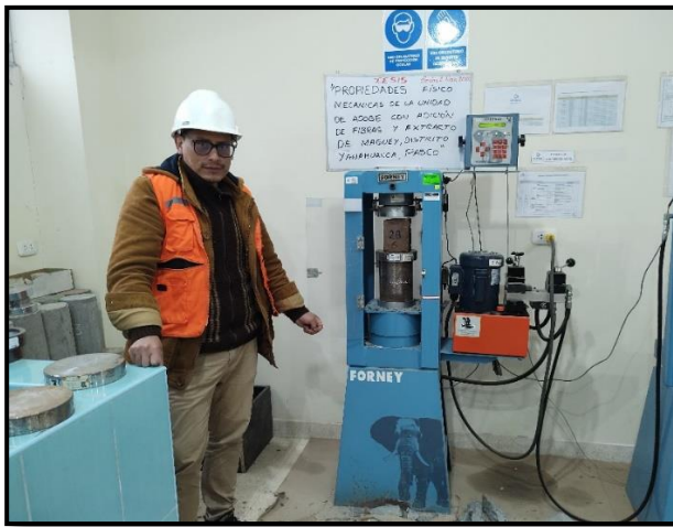
Fotografía: Proceso de ensayo de compresión de la unidad de adobe con adición de fibras y extracto de maguey.
