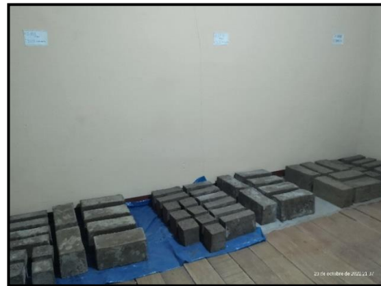
Fotografía: Proceso de secado de las unidades de adobe.
