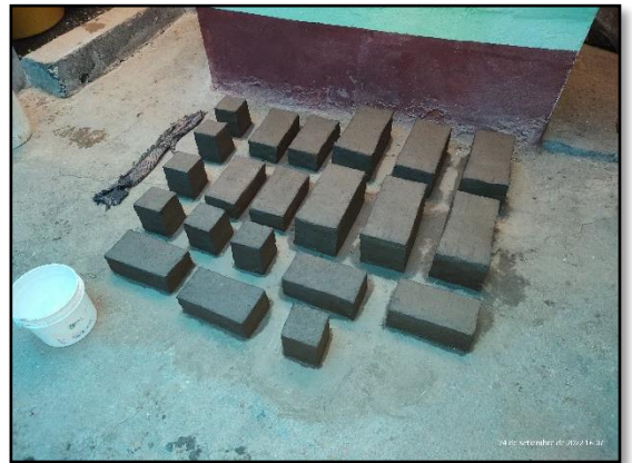
6. Culminado de la elaboración de unidades de adobe con adición de 0.27% de fibras y 50% de extracto de maguey.
