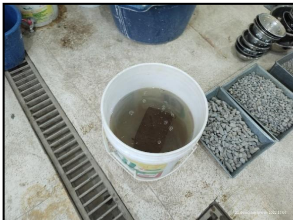
Fotografía: Proceso de inmersión de la unidad de adobe con paja (A), el cual pasado 24 horas se ve una saturación total.
