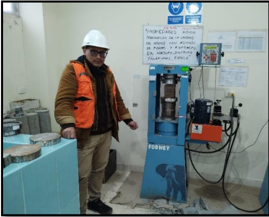
Fotografía: Proceso de análisis de rotura de compresión y flexo compresión de la unidad de adobe.
