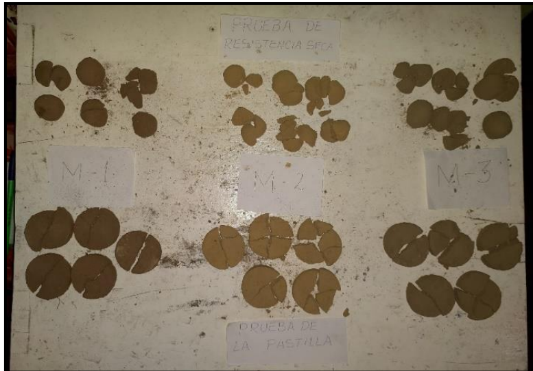
Fotografía: Prueba de resistencia seca y prueba de la pastilla, de las tres muestras recolectadas.
