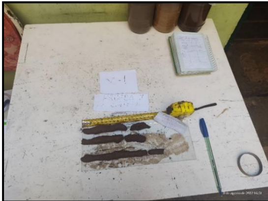
Fotografía: Prueba de la cintilla de barro y prueba de la pastilla, de las tres muestras recolectadas.
