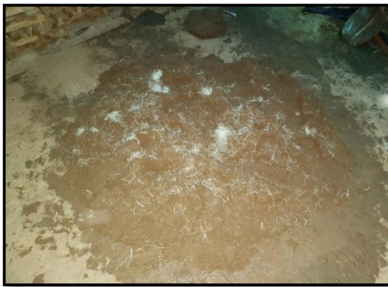
Fotografía: Mezclado del barro con adición de 0.27% de fibras y 50% de extracto de maguey y su posterior proceso de fabricación de las unidades de adobe.
