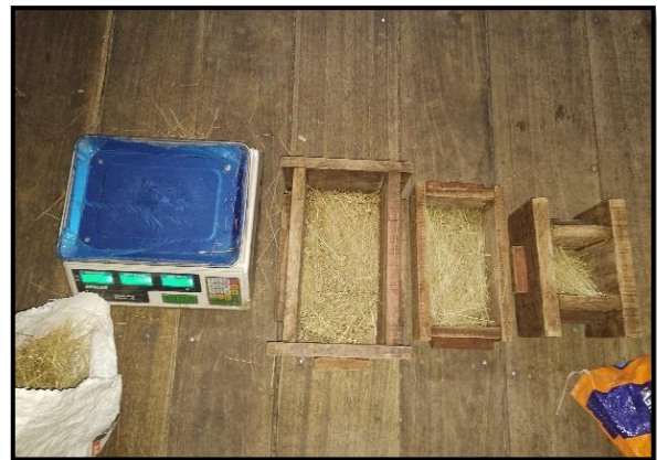
Fotografía: Porcentajes en peso de paja por dimensiones de ensayo a realizar.
