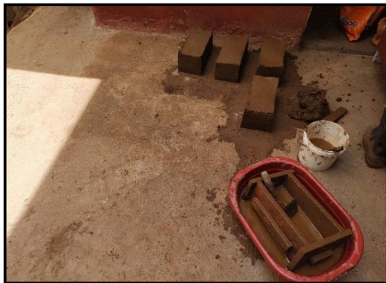
Fotografía: Preparación de la mezcla con adición de 0.27% de fibras y 50% de extracto de maguey, y su posterior proceso de fabricación de unidades de adobe.
