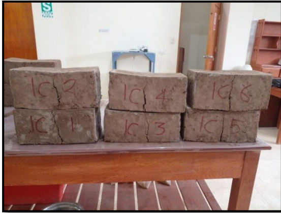
Fotografía: Muestras después de sufrir el esfuerzo de flexo compresión.
