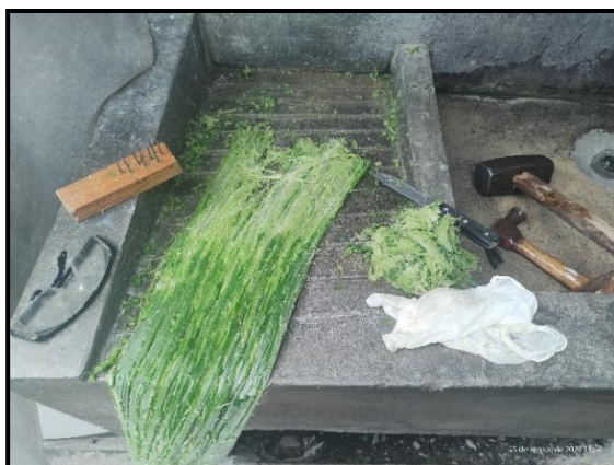
Fotografía: Proceso de extracción de las fibras de hojas de maguey.
