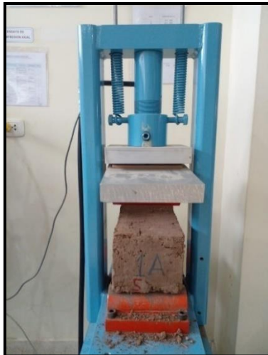
Fotografía: Ensayo de flexo compresión de las unidades de adobe.
