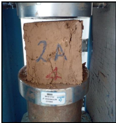
Fotografía: Proceso de ensayo de compresión de la unidad de adobe.
