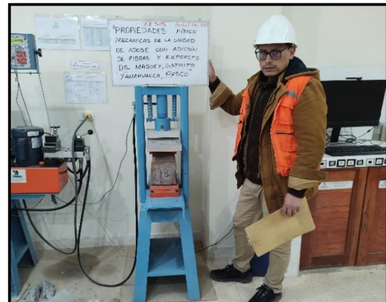
Fotografía: Proceso del ensayo de flexo compresión de las unidades de adobe.
