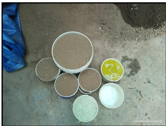
Fotografía: Proporción de materiales a utilizar para la fabricación de unidades de adobe con adición de 0.27% de fibras y 50% de extracto.
