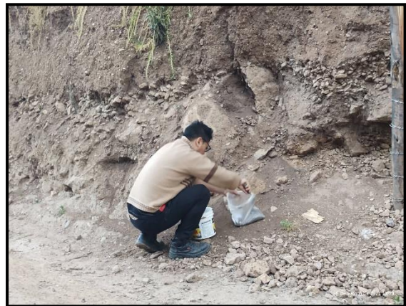
Fotografía: Recolección previa de muestras para su análisis tacto visual y de campo, para la elección del suelo adecuado para la elaboración de las unidades de adobe, de los tres lugares designados.
