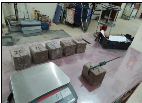
Fotografía: Proceso de medición de dimensiones y pesos de cada unidad de adobe para el análisis de compresión y flexión.
