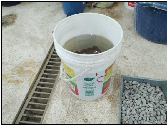
Fotografía: Proceso de inmersión de la unidad de adobe con adición de 0.13% de fibra y 50% de extracto de magüey, el cual pasado las 24 horas la unidad de adobe aún se mantiene.
