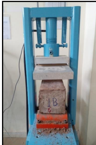
Fotografía: Ensayo de flexo compresión de las unidades de adobe.
