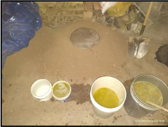
Fotografía: Mezclado del extracto de maguey con el suelo.
