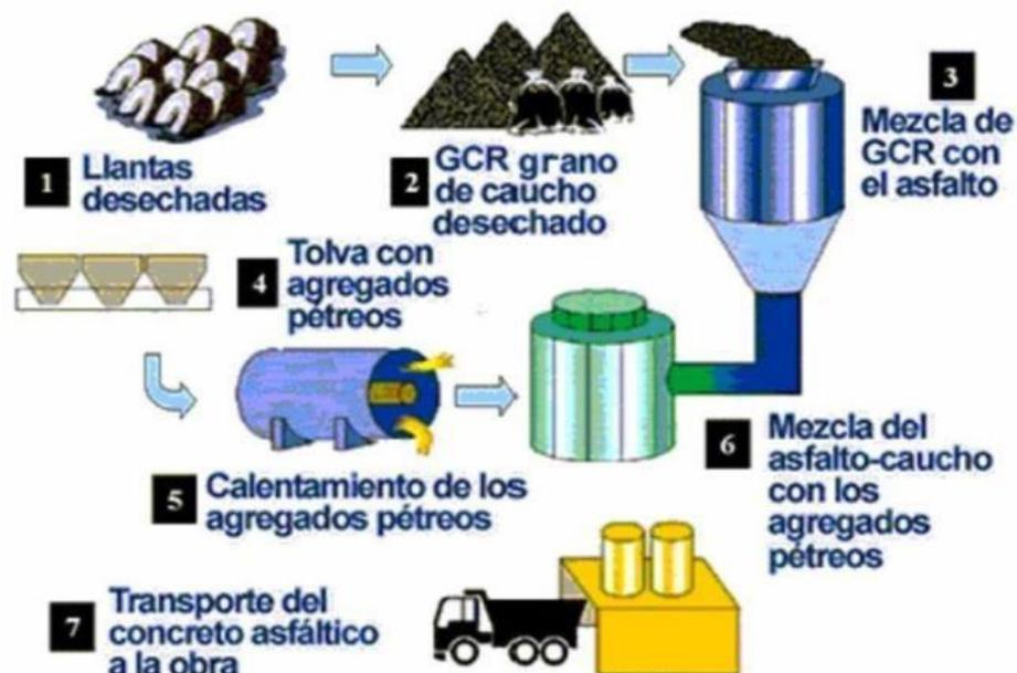
Figura: Proceso de modificación del asfalto por vía húmeda.
