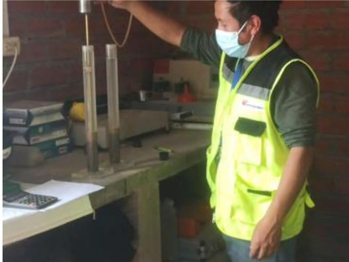
**FOTOGRAFIA 04:** Ensayo de Equivalente de arena
