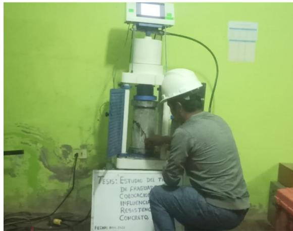
**Imagen 34:** Ensayo de resistencia a la penetración
