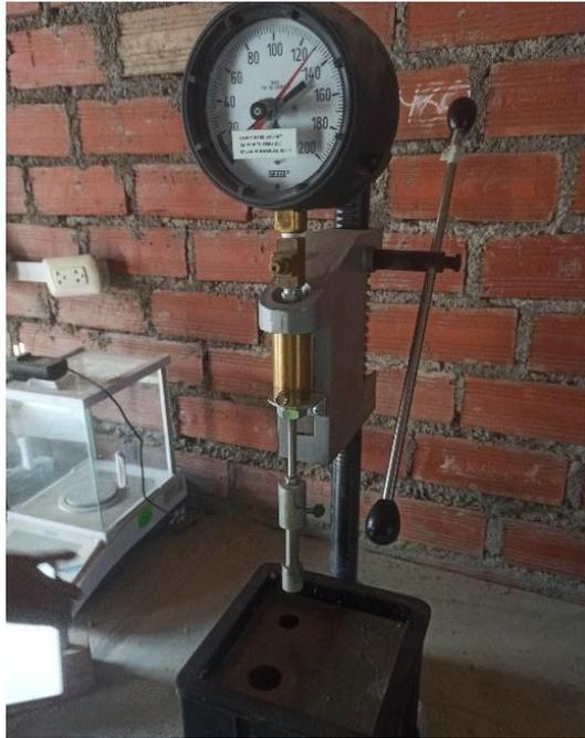
**Imagen 25:** Equipo para medir el tiempo de fragua del concreto
