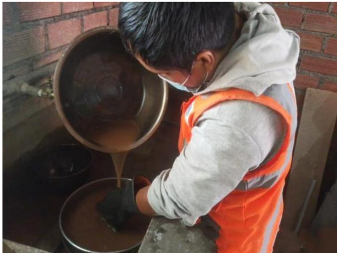
**FOTOGRAFIA 05:** Ensayo de pasante el Tamiz N ° 200
