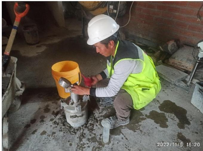
**FOTOGRAFIA 11: Contenido de aire del concreto**
