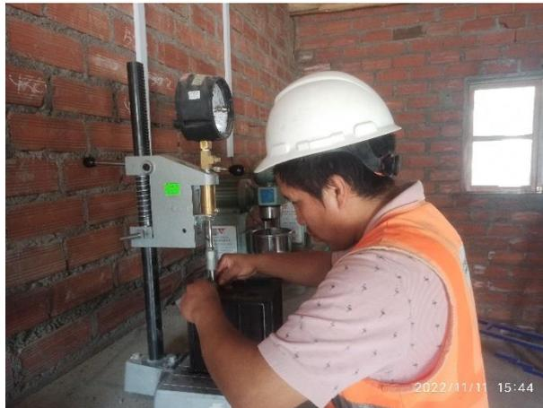
**Imagen 26:** Ensayo de resistencia a la penetración
