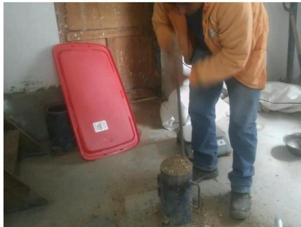
**Imagen 21:** Ensayo de peso Unitario
