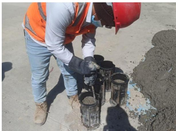
**Imagen 14:** Moldeo de probetas cilíndricas
