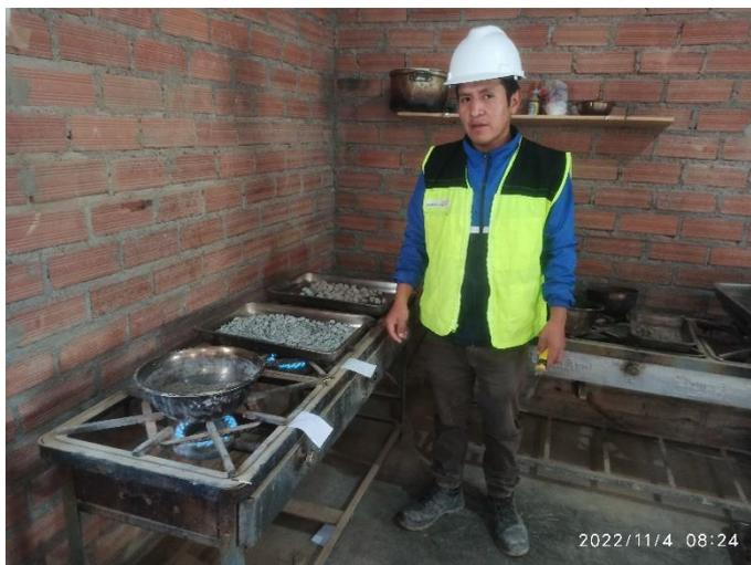
**FOTOGRAFIA 06:** Secado de los agregados
