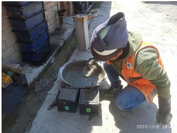
**FOTOGRAFIA 17:** Ensayo de Fragua del concreto – Moldeo de las probetas prismáticas 15cm x 15cm x 15 cm.
