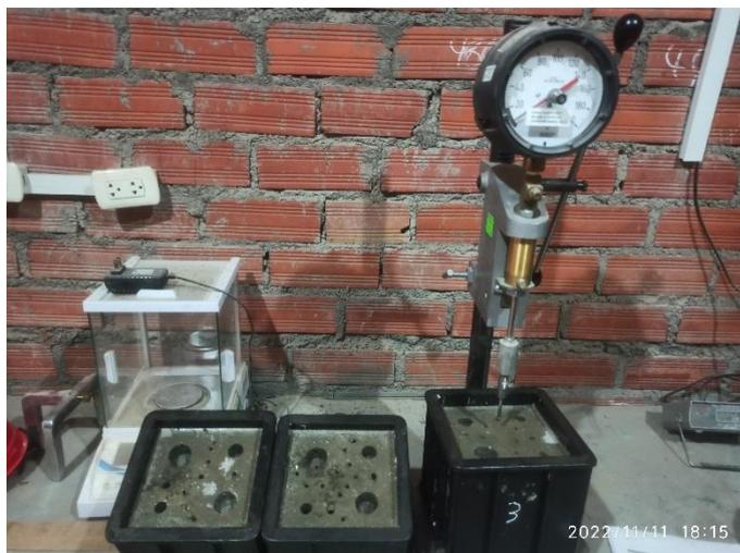
**FOTOGRAFIA 21:** Ensayo de Fragua del concreto – Resistencia a la Penetración
