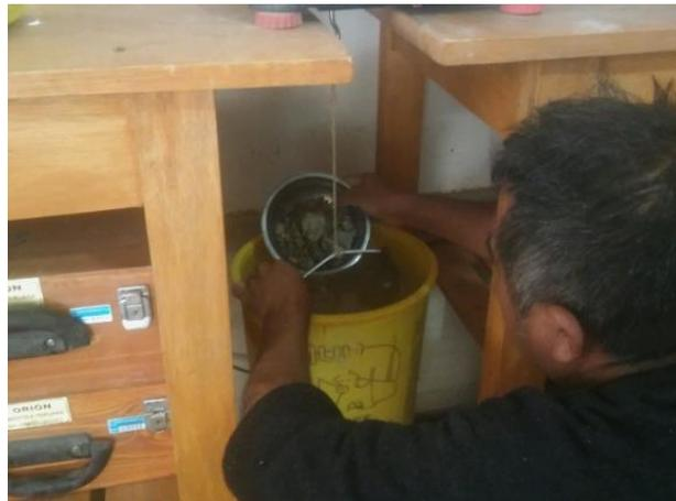
**Imagen 20:** Ensayo de peso específico de gravas – Por canastilla
