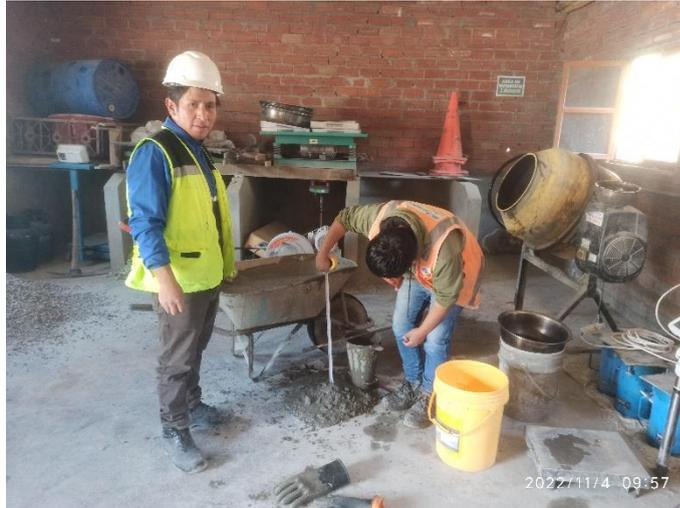
**FOTOGRAFIA 10: Slump del concreto**
