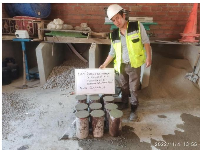
**FOTOGRAFIA 14:** Moldeo de probetas cilíndricas 6" x 12"
