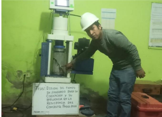
**FOTOGRAFIA 16:** Ensayos a compresión del concreto
