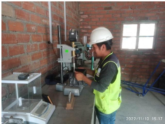
**FOTOGRAFIA 20:** Ensayo de Fragua del concreto – Resistencia a la Penetración
