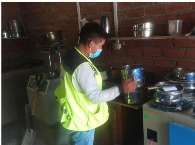
**FOTOGRAFIA 03:** Ensayo de Granulometría
