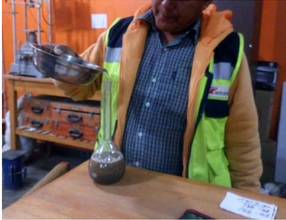
**Imagen 19:** Ensayo de peso específico de finos
