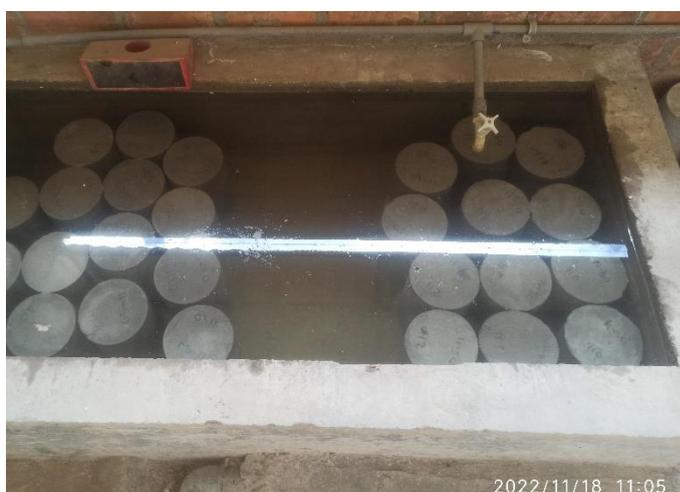
**FOTOGRAFIA 15:** Curado de probetas de concreto
