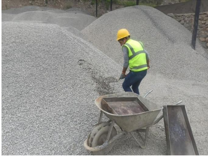
**FOTOGRAFIA 01:** Muestreo de agregados para concreto
