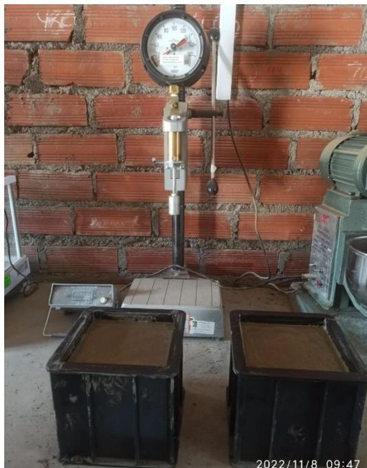
**Imagen 15:** Equipo, penetrómetro dinámico ligero
