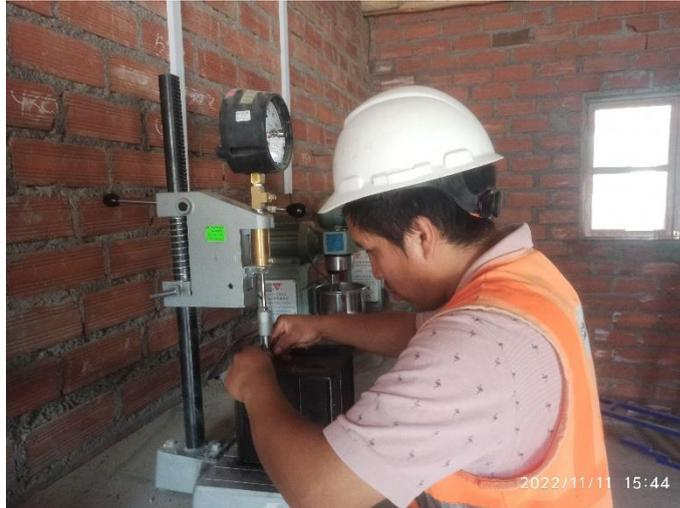
**FOTOGRAFIA 19:** Ensayo de Fragua del concreto – Resistencia a la Penetración
