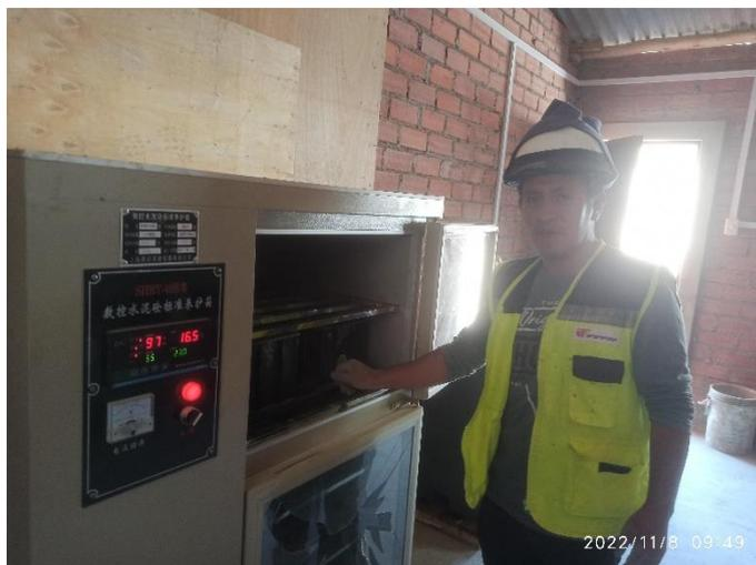
**FOTOGRAFIA 18:** Ensayo de Fragua del concreto – colocado al horno-refrigerador 95% de humedad y 23° C de temperatura
