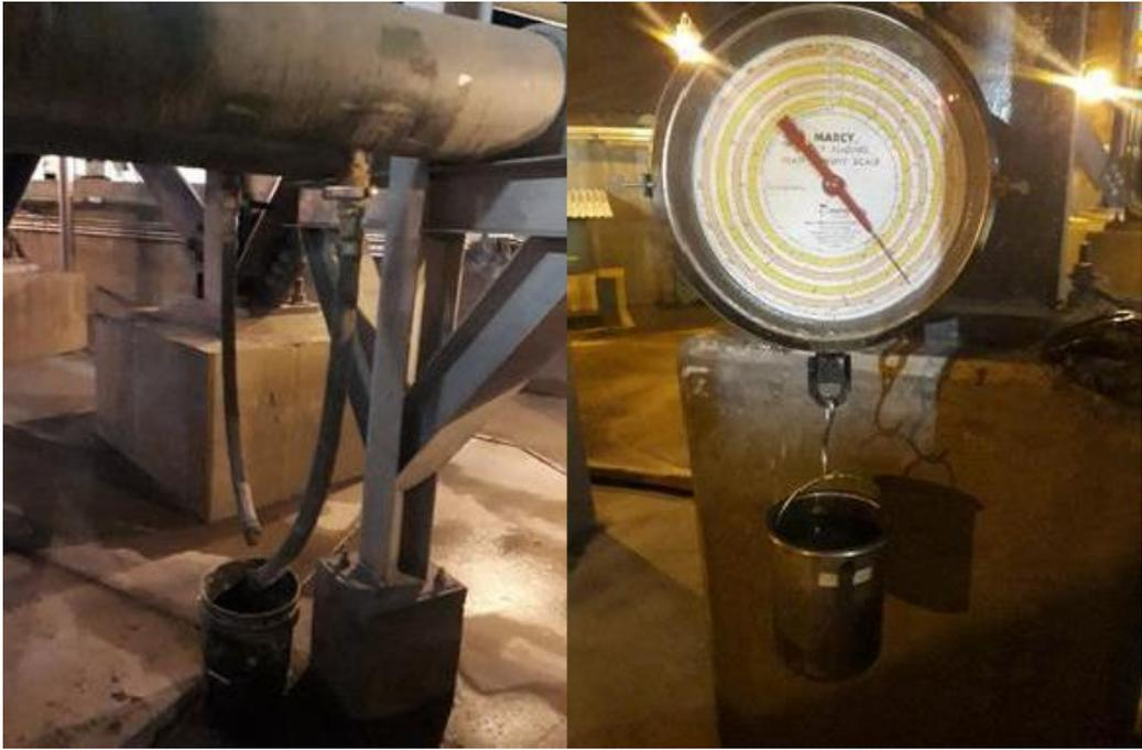
Fotografía 3. Medición de Underflow de espesador
